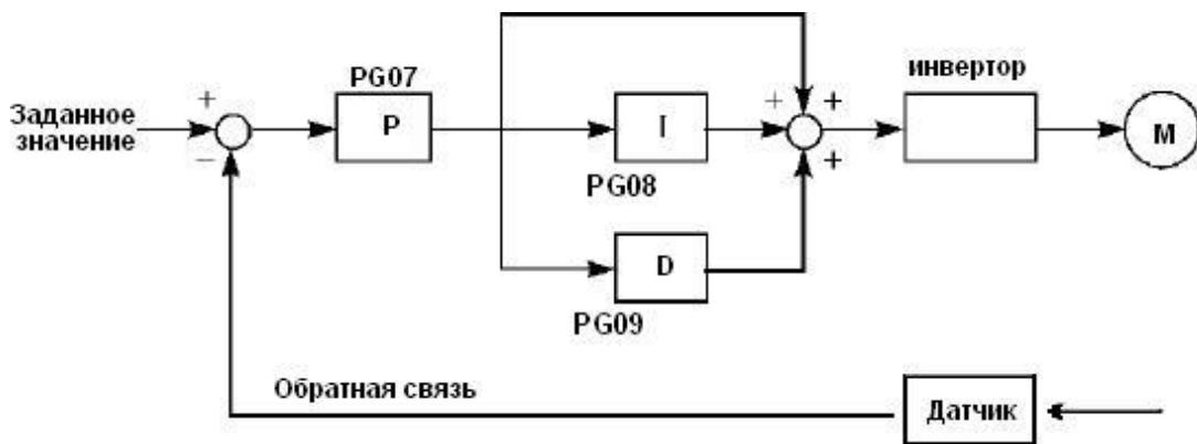
Замечания по использованию преобразователя в режиме PID-регулирования:
