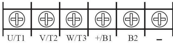
Тип корпуса 3. Трехфазные, 380 В, мощностью от 7,5 кВт до 11 кВт:
