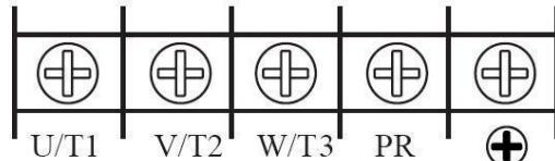
Тип корпуса 2. Трехфазные, 380 В, мощностью от 3,0 кВт до 5,5 кВт, а также однофазные, 220 В, мощностью от 2,2 кВт до 3,7 кВт (используются клеммы S и T):
