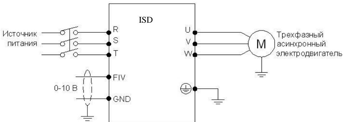
Аналоговое напряжение 0-10В можно сформировать внешним потенциометром 10кОм. Изменение частоты происходит при изменении напряжения от 0 до 10 В между клеммами FIV
