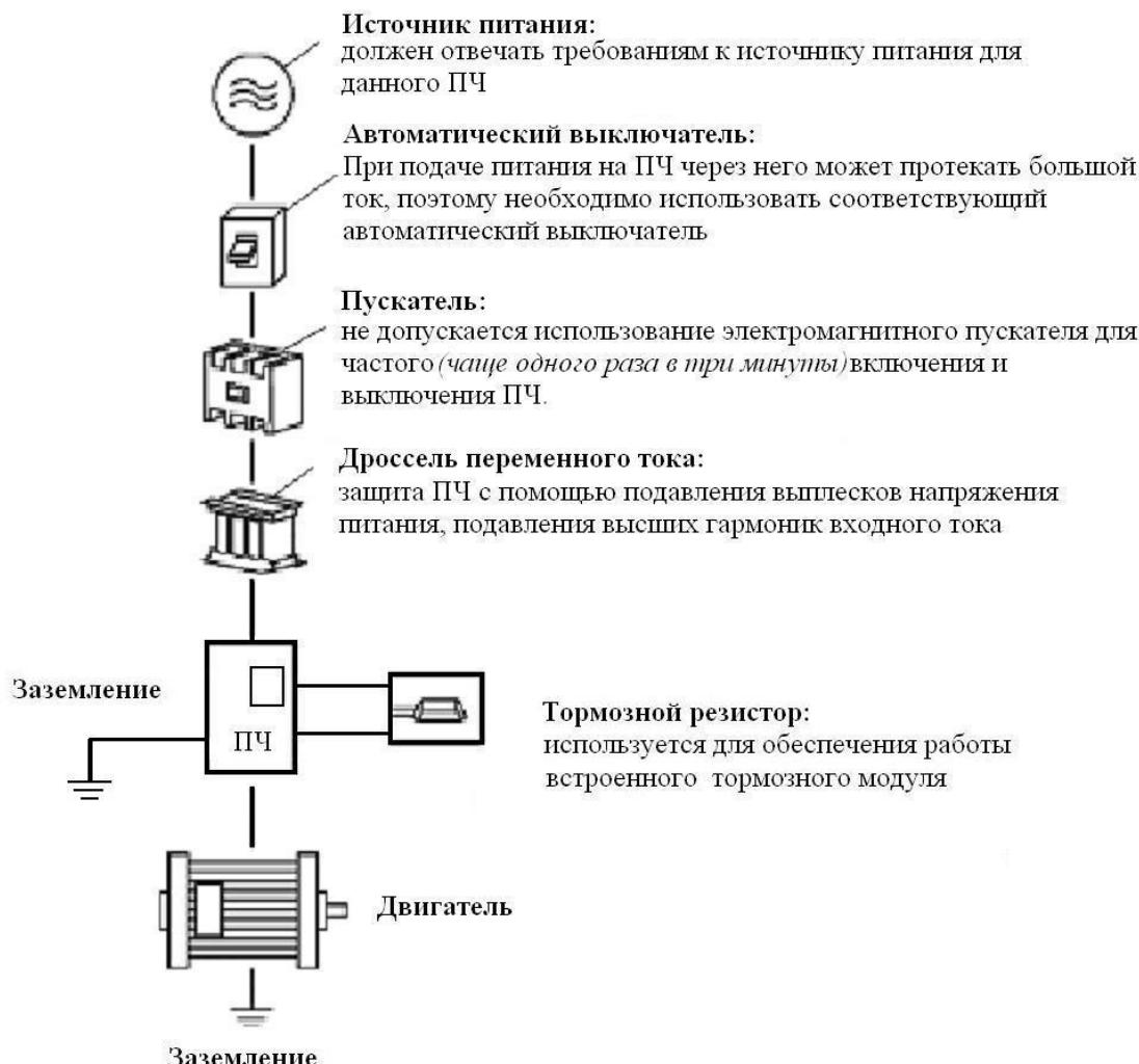
**⚠ Подключение проводов питания преобразователя следует производить только к клеммам L1, L2, L3.**
