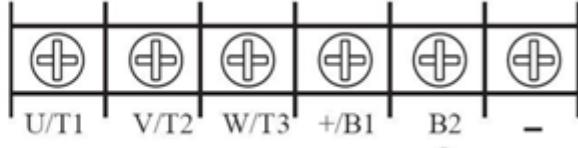
Тип корпуса 4. Трехфазные, 380 В, мощностью от 15 кВт до 22 кВт:
