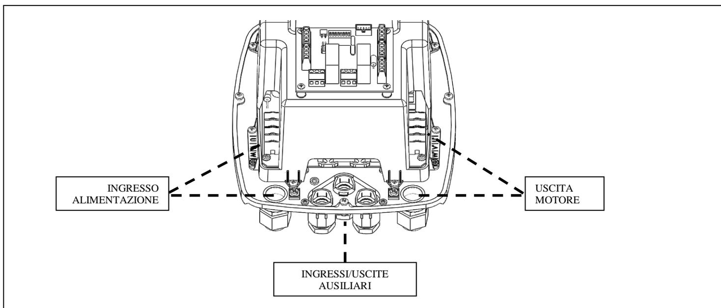
Le piastrine metalliche posizionate in prossimità dei pressacavi possono essere utilizzate per collegare le schermature dei cavi e garantire quindi una corretta continuità della schermatura stessa con il dissipatore.
