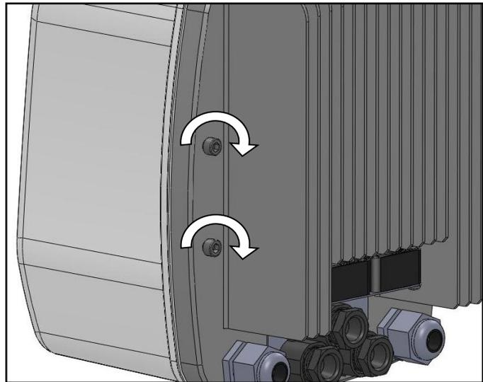
2) Pre assemblare le viti di fissaggio sul lato posteriore del *Nettuno*, lasciando almeno 3 mm di spazio sotto alle teste delle viti.
