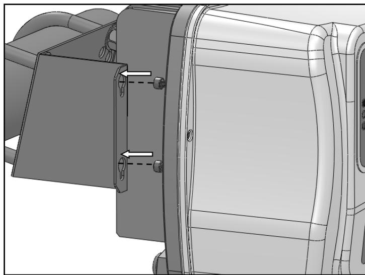
3) Pre assemblare le viti di fissaggio sul lato posteriore del Nettuno, lasciando almeno 3 mm di spazio sotto alle teste delle viti.
