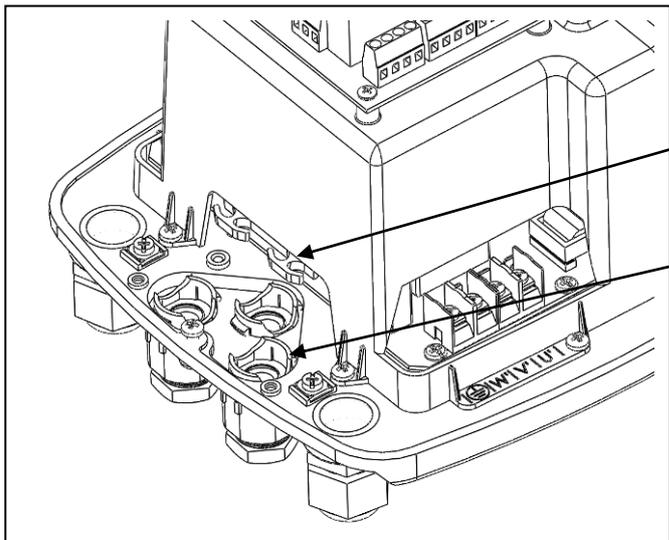
Inserire i cavi dei dispositivi ausiliari attraverso i pressacavi centrali in plastica. Usare gli appositi guidacavi per mantenere in ordine i cavi.
