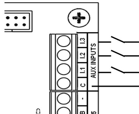
I tre ingressi digitali sono tutti configurabili dal software come N.O. oppure N.C.; impostando l'ingresso su OFF ne viene completamente ignorato il funzionamento. Fare riferimento alla sezione di impostazioni dei parametri per maggiori informazioni.
