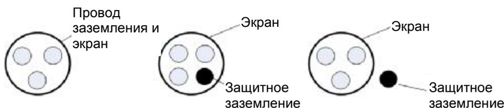
Для эффективного подавления помех от радиоизлучения и проводимости радиочастот защитная оболочка экранированного кабеля представлена медной оплеткой. Плотность медной оплетки не должна быть более 90%, чтобы повысить эффективность экранирования и проводимость, как показано на следующем рисунке.
