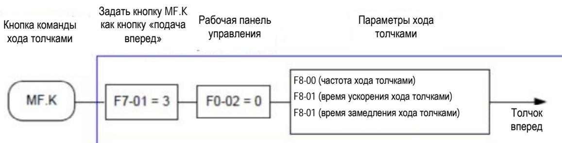
Задать параметры в соответствии с предыдущей иллюстрацией. В состоянии остановки привода нажать кнопку. Далее привод переменного тока запускается в режим работы толчками. Если вы отпустите кнопку, привод переменного тока замедляется и останавливается.
