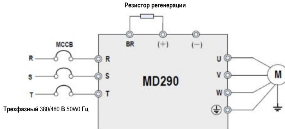
Рис. 4-3. Проводка главного контура MD290 (трехфазный ток 380 – 480 В, от 90G/110P до 110G/132P)
