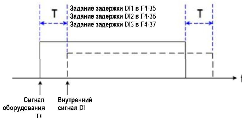
Предыдущие десять клемм DI могут быть определены в функциональных кодах F4-00 – F4-09. Каждому DI может быть присвоена функция, одна из 50. Более подробно см. описания с F4-00 по F4-09.
