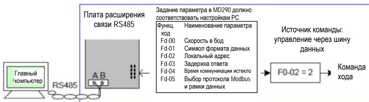
Когда функциональный параметр Fd-04 задан на величину, отличную от нуля, MD290 автоматически останавливает систему привода, если время коммуникации истекло. Это предохранительная функция, которая предотвращает непрерывную и бесконтрольную работу привода переменного тока, когда случается ошибка в кабеле связи или в управляющем компьютере.
