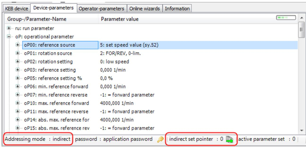
Только в наборе указанном указателем, отображаются фактические значения. Указатель отображается постоянно в нижней части окна редактора. Установку указателя наборов в Fr09 можно сделать в параметре редактора или прямо с помощью значка
