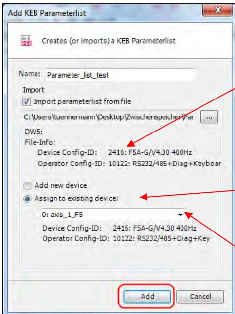
Тип и версия прошивки устройства / список параметров
