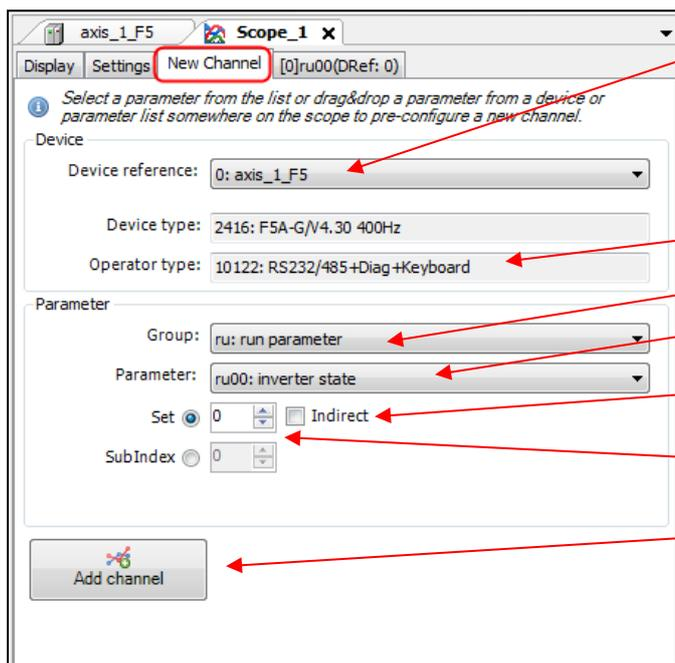
Ссылка на устройство (выбор) (не означает адрес шины устройства!!). То есть из какого устройства должны быть записаны каналы
