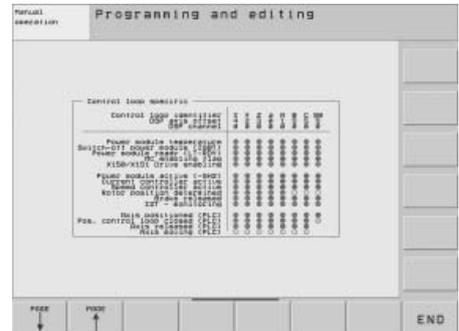
При каждом включении автоматически распознается тип электродвигателя и при необходимости актуализируется соответствующая запись в параметрах станка.
