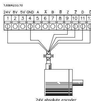
Рисунок 3.8 Абсолютный энкодер 24 В (SSI), предоставляемый MCO 305
