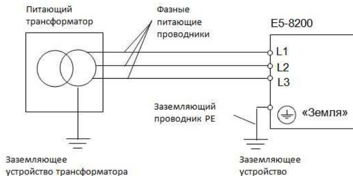
При использовании любой из вышеуказанных систем заземления запрещается подсоединять к клемме «Земля» преобразователя частоты нейтральный рабочий проводник (N) или совмещенный нейтральный рабочий и защитный проводник (PEN), соединенные со средней точкой питающего трансформатора.
