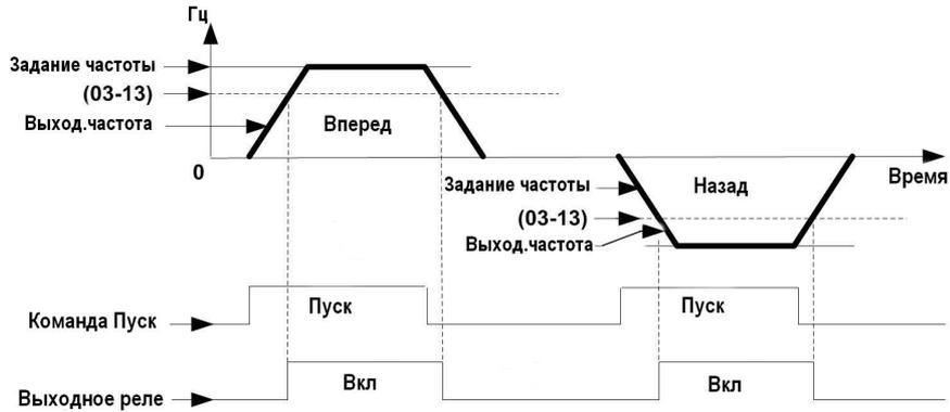
6) 03-11 = 5: Контакты реле RA-RB замыкаются, если выходная частота меньше уровня определения частоты (03-13):
