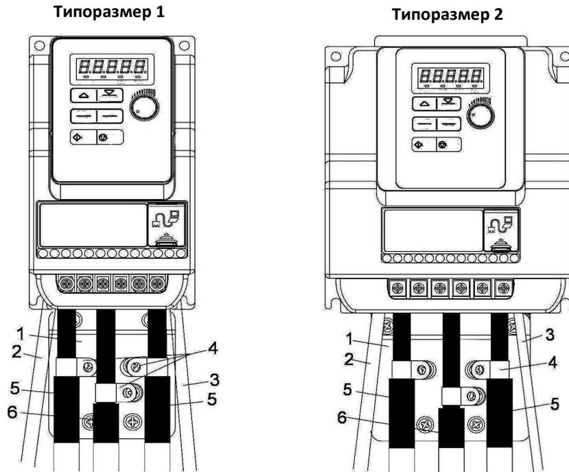
1. Комплект заземления устанавливается на преобразователе (клеммы заземления на корпусе), как показано на рисунке.
