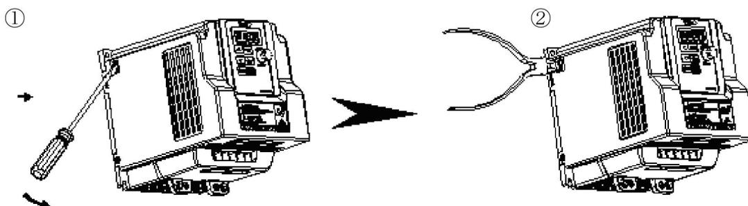
Отключение фильтра (типоразмер 3, 4):
