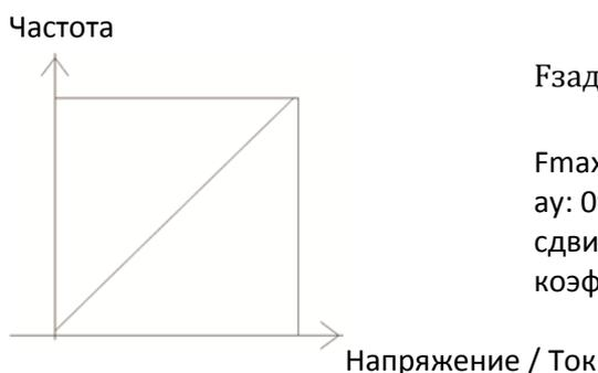
$$F_{\text{зад}} = [(a_y \pm \text{сдвиг}) \times \text{коэфф.}] \times \frac{F_{\text{max}} (01-00)}{10\text{В или } 16\text{мА или } 20\text{мА}}$$
