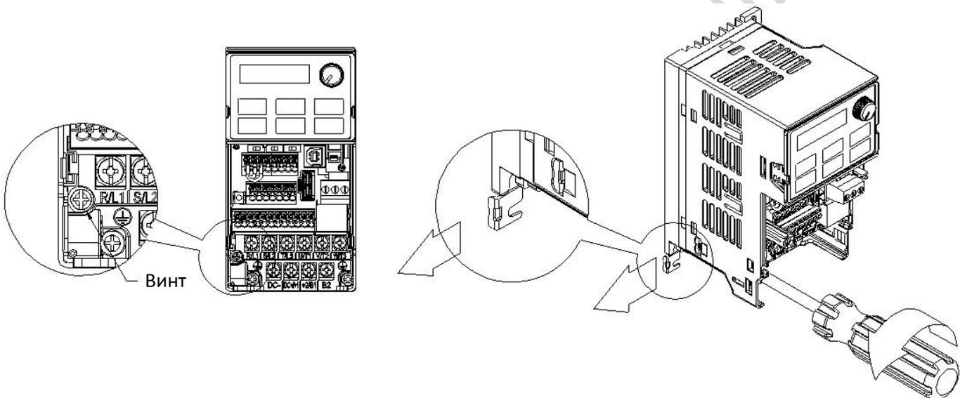
Типоразмеры B~F (Со встроенным фильтром ЭМС)
