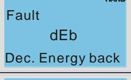
Fault<br>dEb<br>Dec. Energy back | 003EH | Генераторный режим при замедлении                                       | 2                                | FF27H              |
