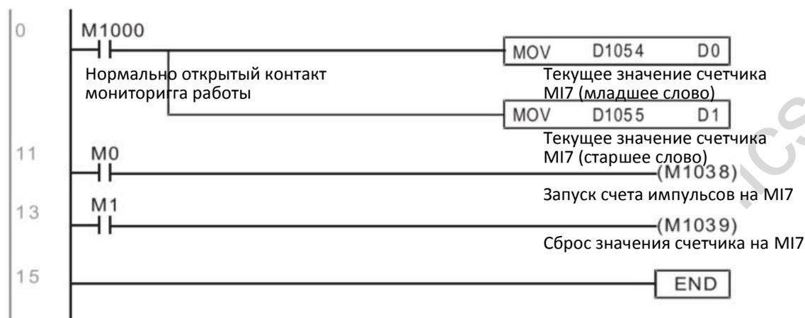
※ Если программа ПЛК использует MI7 как источник импульсов для высокоскоростного счетчика, а также в других операциях ПЛК, то это должно быть установлено в регистрах M1038 или M1039; при этом начальная функция входа MI7 теряется.
