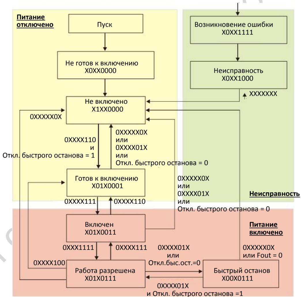
Подайте команду 6040 =0xE, затем команду 6040 =0xF. Затем привод может быть переключен в состояние "Работа разрешена".
