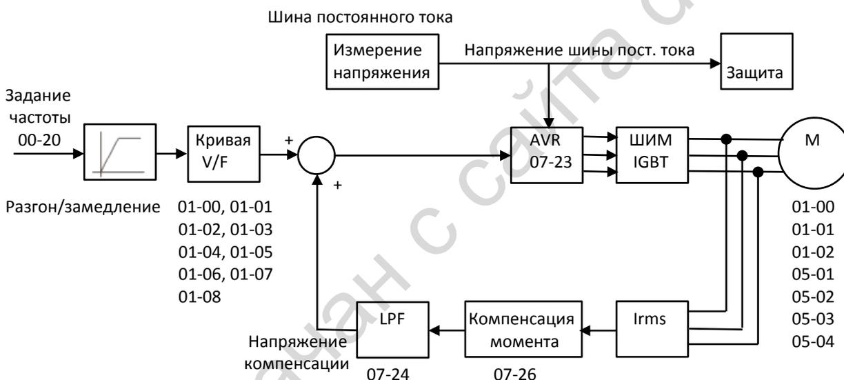
При 00-10=0 и 00-11=1 (V/F + энкодер) управление происходит по следующей структурной схеме:
