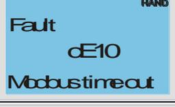
Fault<br>dE10<br>Mdbustimeout      | 003AH | Тайм-аут передачи Modbus                                                | 4                                | 7500H              |
