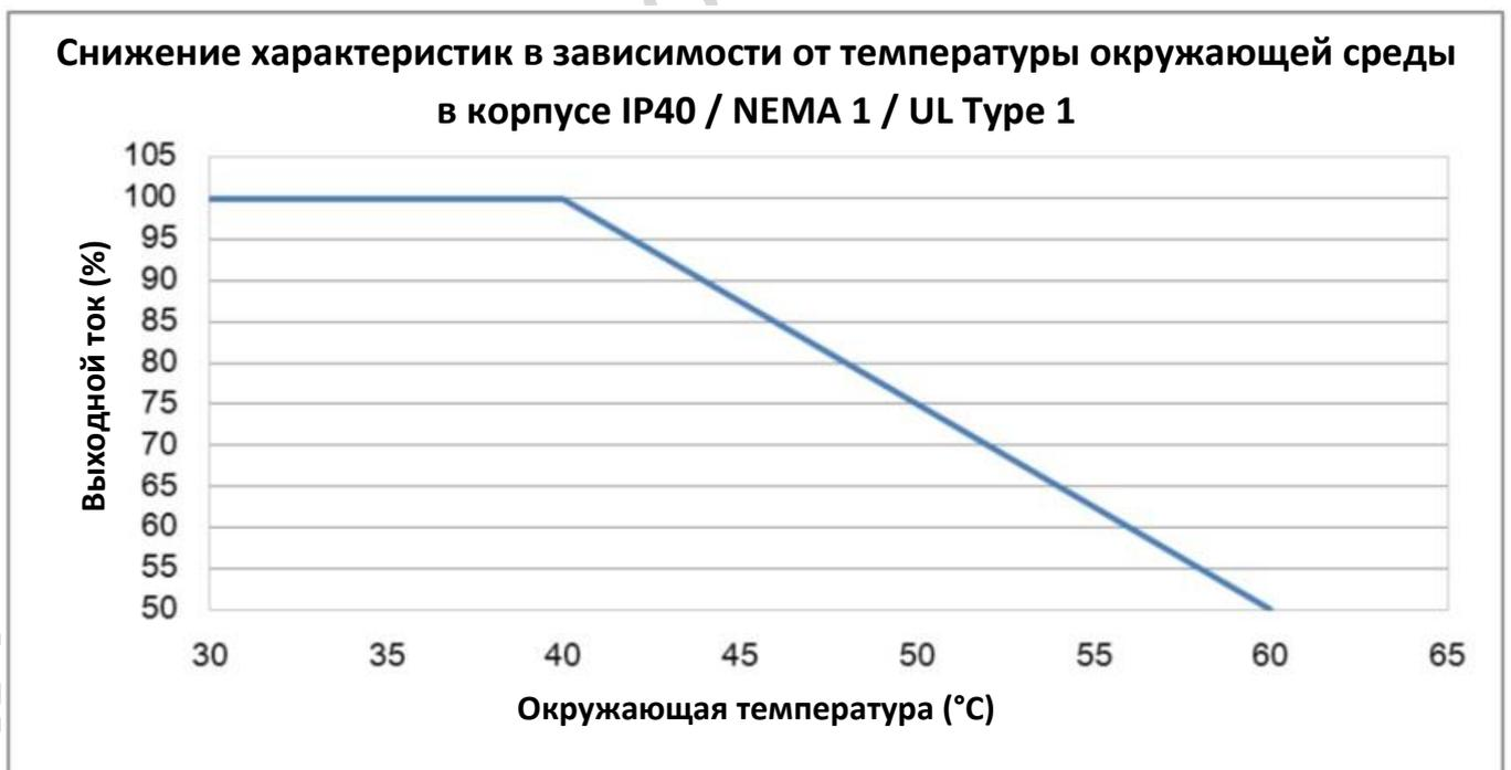
При номинальном токе окружающая температура должна быть в диапазоне  $-10^{\circ}\text{C} \sim +40^{\circ}\text{C}$ .
