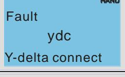
Fault<br>ydc<br>Y-delta connect   | 003DH | Ошибка переключения звезда / треугольник                                | 2                                | 3330H              |
