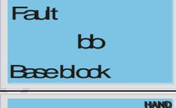
Fault<br>bb<br>Baseblock       | 0033H | Внешний сигнал Base Block. Если активен вход с функцией В.В, то преобразователь отключает выходное напряжение. | 5                                | 9000H              |
