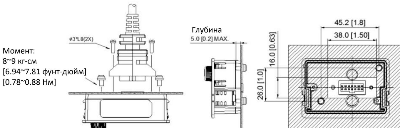
**Способ 2:** Сквозной монтаж (единицы: мм [дюймы])
