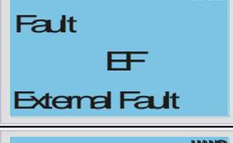
Fault<br>EF<br>External Fault  | 0031H | Внешняя ошибка. Если активен вход с функцией EF, то преобразователь отключает выходное напряжение.             | 5                                | 9000H              |
