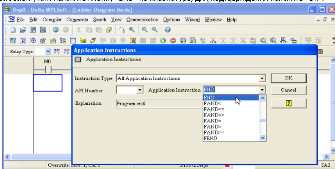
6. Кликните на иконке
