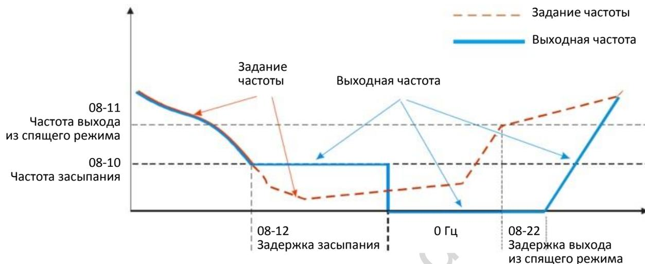
2) Задание частоты определяется ПИД-регулятором
