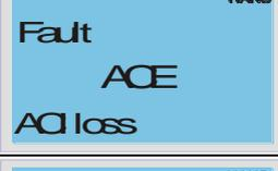
Fault<br>ACE<br>ACI loss       | 0030H | Обрыв сигнала ACI                                                                                              | 1                                | FF25H              |
