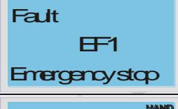
Fault<br>EF1<br>Emergency stop | 0032H | Аварийный останов. Если активен вход с функцией EF1, то преобразователь отключает выходное напряжение.         | 5                                | 9000H              |
