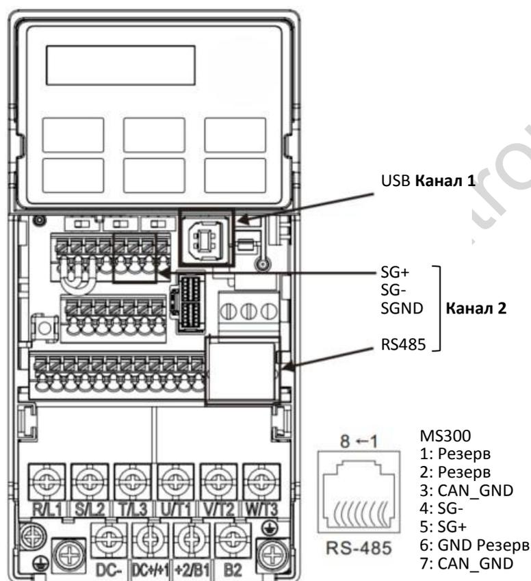
5. Клиент может одновременно получить доступ и к приводу, и к ПЛК, используя различные адреса узлов сети. Например, если привод имеет адрес 1, а ПЛК имеет адрес 2, то команда будет следующей:
