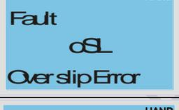
Fault<br>dSL<br>Over slip Error  | 003FH | Скольжение двигателя превышало 07-29 в течение времени 07-30.           | 7                                | FF28H              |
