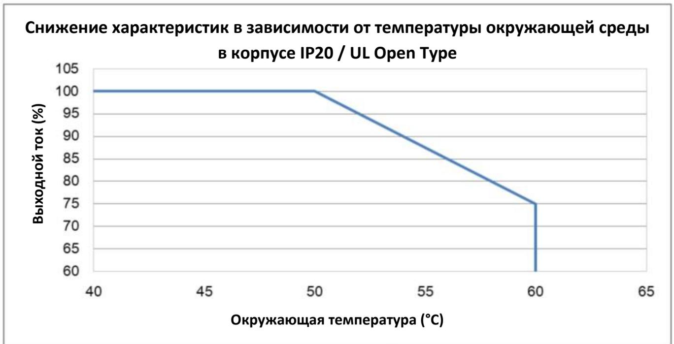
При номинальном токе окружающая температура должна быть в диапазоне  $-10^{\circ}\text{C} \sim +50^{\circ}\text{C}$ .
