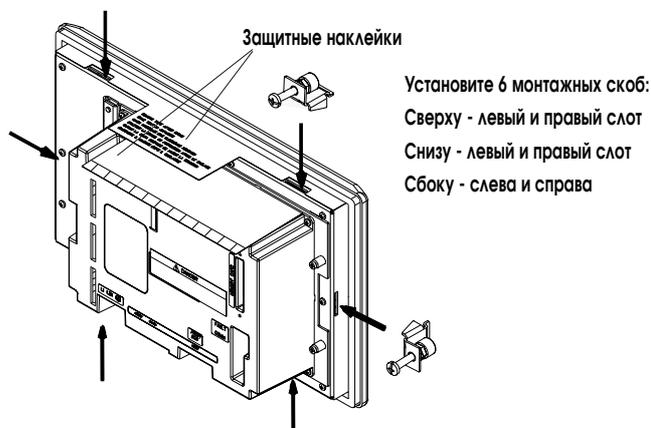
6. Поочередно затяните винты монтажных скоб с моментом 1.1 ньютона на метр. Не перетяните.
