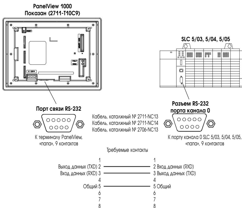
**Важно:** Вы должны сконфигурировать порт канала 0 контроллеров SLC 5/03, 5/04, 5/05 для связи DH-485, используя программное обеспечение RSLogix 500 или AI500.
