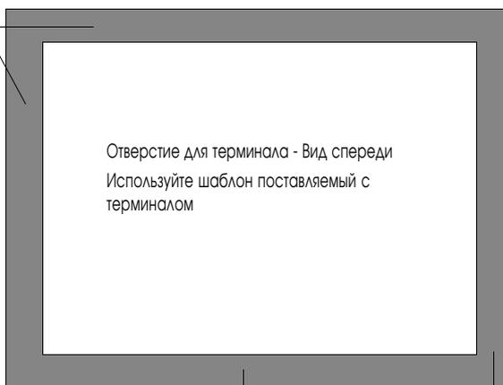
Оставьте 51 мм для монтажа, охлаждения и подключения
