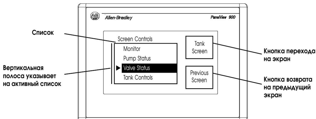
Кнопки перехода и возврата на предыдущий экран могут иметь несколько состояний, а именно могут изменять внутренний текст, формат заполнения, границу или форму. Кнопка возврата отображает предыдущий экран. Кнопка перехода отображает заданный экран.
