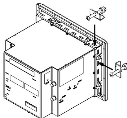
6. Поочередно затяните винты монтажных зажимов пока терминал прочно не встанет на панель. Затяните монтажные винты с моментом 1.1 ньютона на метр. Не перетяните.
