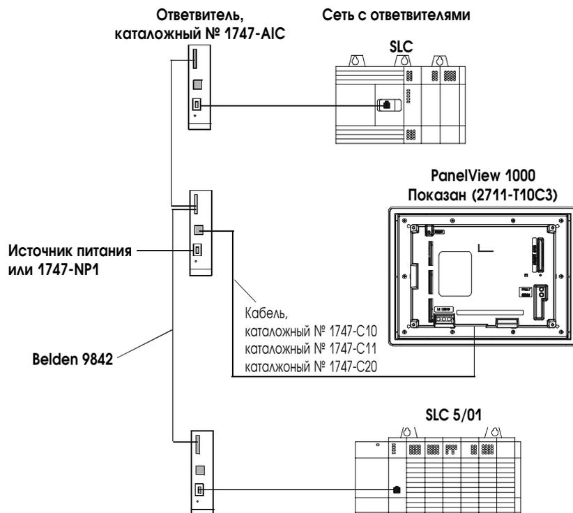
**Важно:** Сетевой кабель DH-485 требует соответствующее экранирование, заземление и терминаторы. Обратитесь к руководству по монтажу кабелей Data Highway/Data Highway Plus/Data Highway-485 (публикация 1770-6.2.2).
