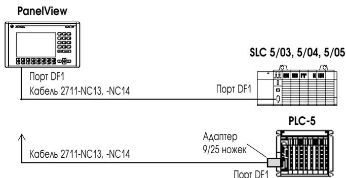
Используйте оптическую или эквивалентную развязку при существовании различий уровней напряжения заземления между контроллером или модемом и PanelView.
