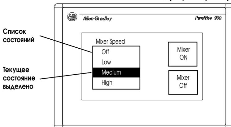
Список состояний может иметь максимум 255 элементов. Список автоматически прокручивается для отображения текущего состояния.
