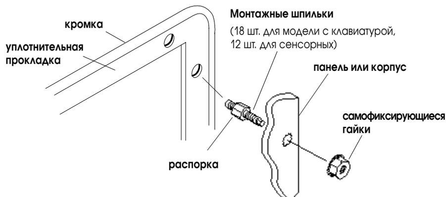
3. Удостоверьтесь, что уплотнительная прокладка терминала правильно установлена на терминал. Эта прокладка формирует уплотнение герметизации (исполнение Тип 4). Не используйте уплотняющие пасты.
