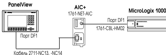
1761-NET-AIC используется только с MicroLogix и устраняет разницу уровней напряжения заземления между контроллером и PanelView.
