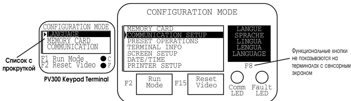
Примечание: На терминалах PV550/PV600 для функции Reset Video используется кнопка F9.
