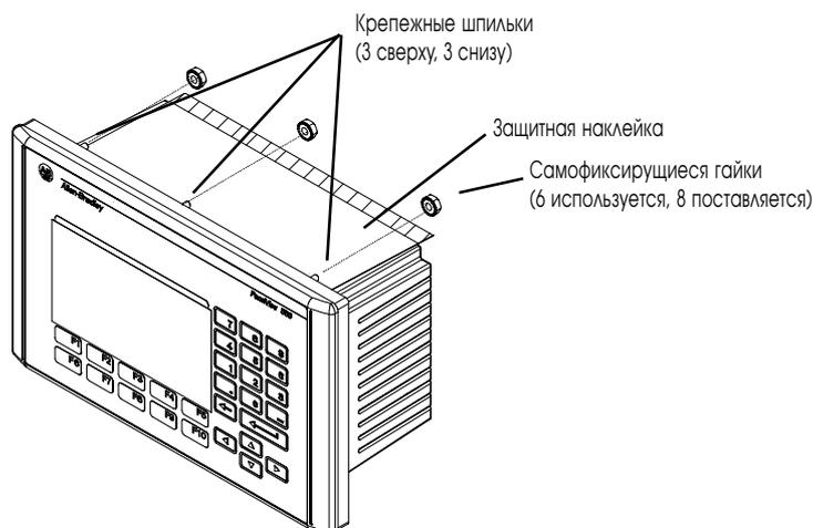
**PV550 терминал с сенсорным экраном**
