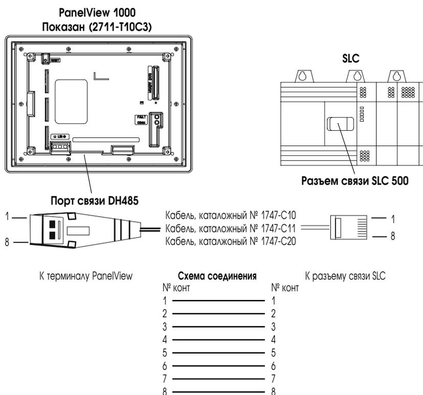
Разъемы DN-485 не изолированы электрически. Если требуется электрическая изоляция, используйте ответвители (каталожный номер 1747-AIC) как показано на следующей странице.
