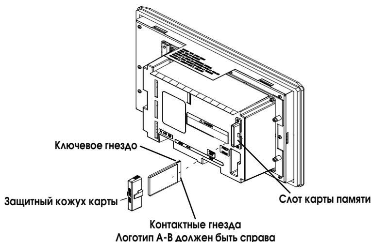
**Примечание:** На рисунке показана задняя сторона терминала PanelView 900. Положение слота карты памяти может отличаться для других типов терминалов.
