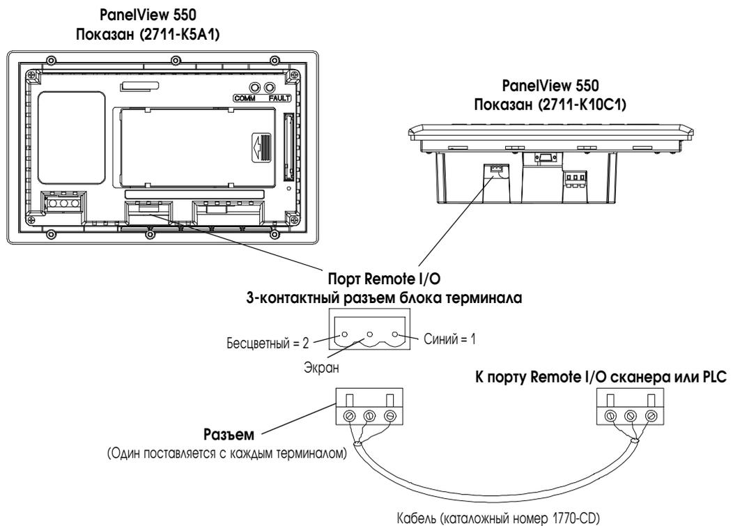
**Примечание:** Полярность разъема Remote I/O на терминале PanelView обратная с разъемом сканера PLC. Однако, полярность совпадает с подключением карты сканера на SLC.
