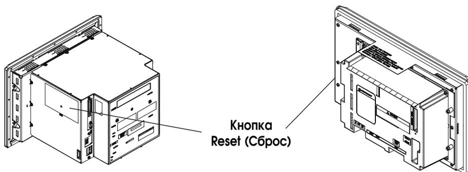
На терминалах PV550/PV600 с сенсорным экраном, кнопка «Reset» (Сброс) расположена правее и ниже гнезда платы памяти.
