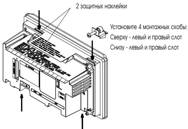
6. Поочередно затяните самофиксирующие гайки или винты монтажных скоб пока терминал не встанет плотно на панели. Затяните винты или гайки с моментом 1.1 ньютона на метр. Не перетяните.
