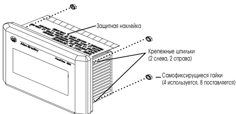
8. Поочередно затяните самофиксирующие гайки пока терминал не встанет плотно на панели. Затяните гайки с моментом 1.1 ньютона на метр. Не перетяните.
