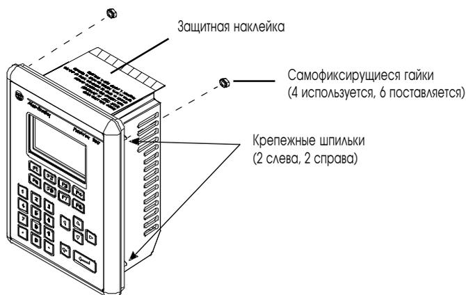
7. Поочередно подтяните самофиксирующиеся гайки пока терминал не встанет плотно на панели. Затяните гайки с моментом 1.1 ньютона на метр. Не перетяните.
