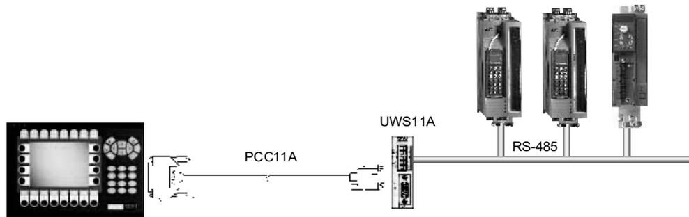
Рис. 13. Последовательное соединение через UWS11A
