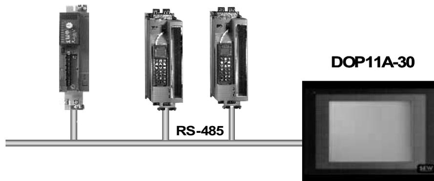
Рис. 10. Соединение через RS-485
