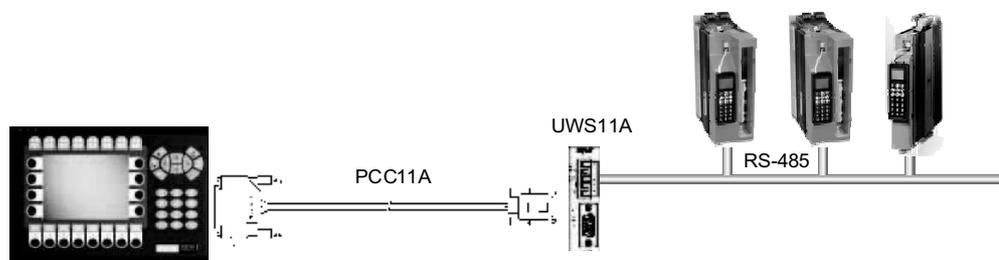
Рис. 19. Соединение между панелью и MOVIDRIVE® MDX60B/61B
