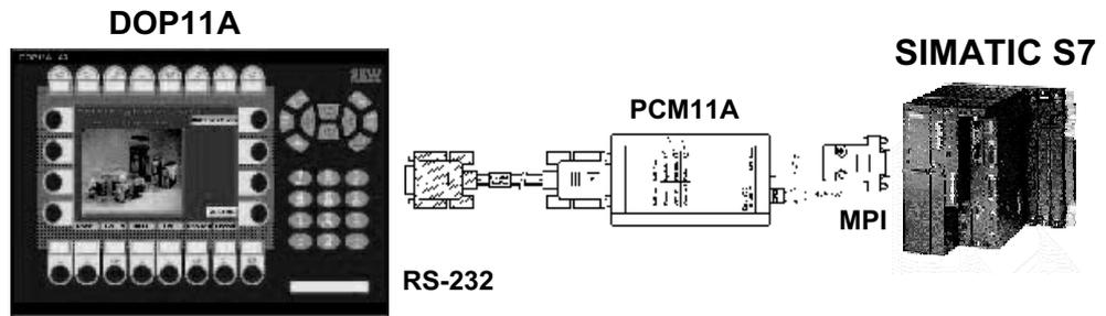
Рис. 18. Подключение к Siemens S7 через MPI и PCM11A
