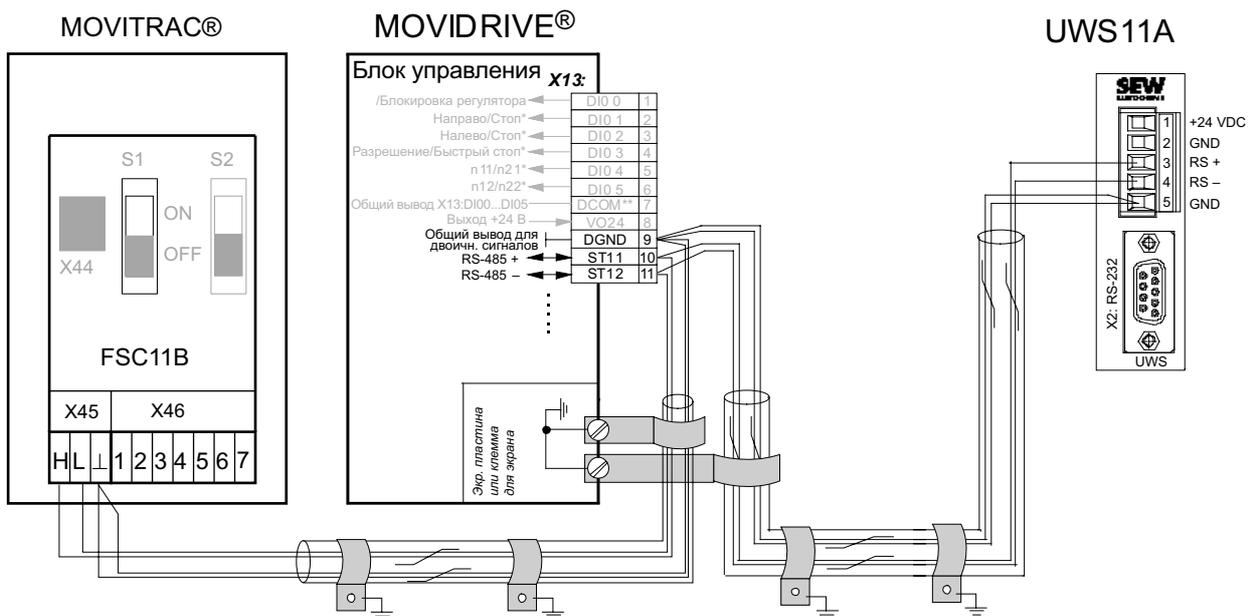
Рис. 14. Назначение выводов в разъемах UWS11A
