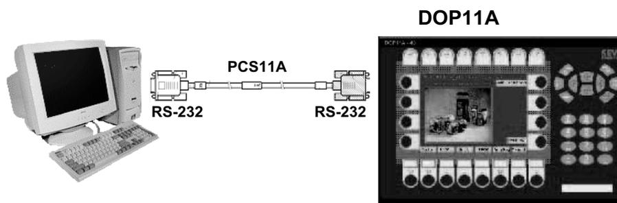
Рис. 9. Подключение к ПК
