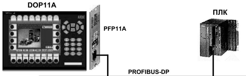
Рис. 16. Подключение через PROFIBUS-карту PFP11A
