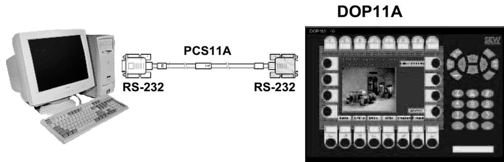
Рис. 20. Соединение между ПК и операторской панелью
