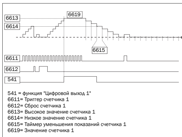
Рис. 133 Счетчики, принцип действия.
