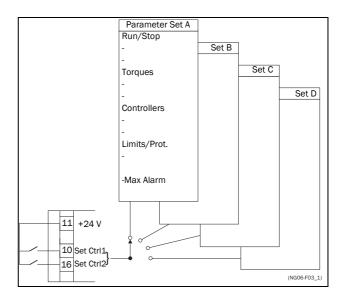
Fig. 28 Selecting the parameter sets
