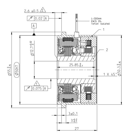
Gesamtschlag im eingebauten Zustand Concentricity in installed situation
