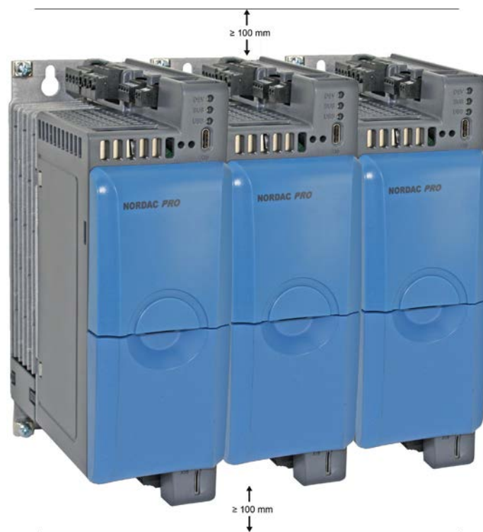
Рис. 1: Монтажные расстояния
