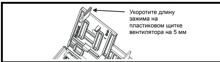
Рис. 3-62 Крепление тормозного резистора к радиатору для габарита 2
