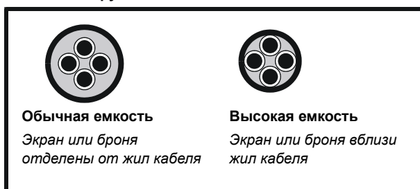
Рис. 4-15 Конструкция кабеля влияет на его емкость
