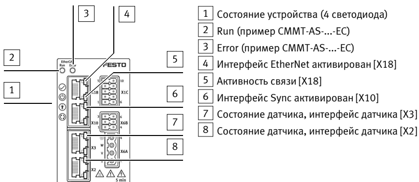
Fig. 28 Светодиоды на передней стороне (пример CMMT-AS-...-EC)
