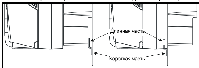
Рис. 3-18 Ориентация монтажной скобы для габарита 4, 5 и 6
