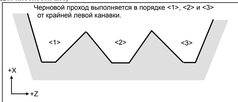
Рис. 4.2.1 (m) Порядок чернового прохода в случае монотонного возрастания (тип II)
