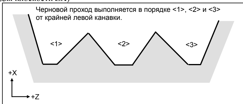
Рис. 6.4.1 (n) Порядок чернового прохода в случае монотонного возрастания (тип II)
