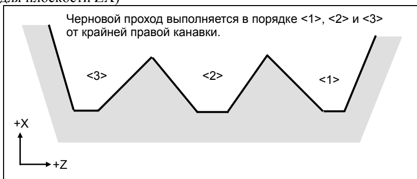
Рис. 6.4.1 (m) Порядок чернового прохода в случае монотонного убывания (тип II)
