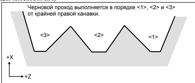
Рис. 4.2.1 (l) Порядок чернового прохода в случае монотонного убывания (тип II)
