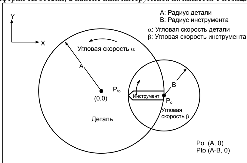
Рис. 7.1 (b) Принцип обработки многогранника
