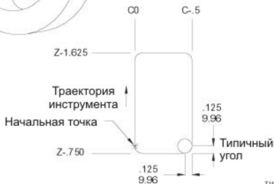
Рисунок 11.24 – Цилиндрическая интерполяция: прямоугольник с закругленным углом (шпиндель, если смотреть сзади станка)
