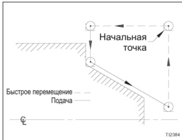
Рисунок 2.12 – Движение осей в ходе цикла торцевания G94
