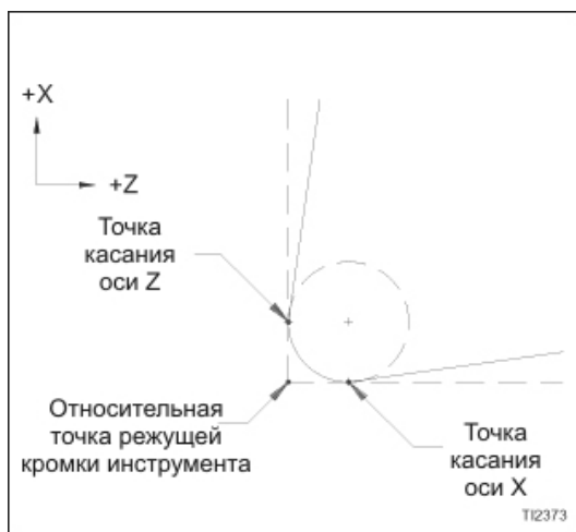
Рисунок 2.1 – Кромка инструмента с точками касания оси X и Z
