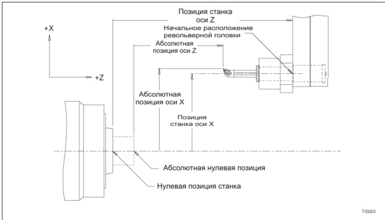
Рисунок 5.3 – Позиции станка и абсолютная (с активными компенсациями сдвига на заготовку оси Z и компенсациями инструмента оси X и Z)
