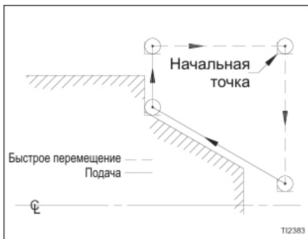
Рисунок 2.11 – Движение осей в ходе цикла обточки G90
