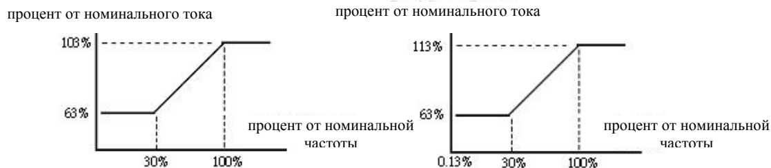
Кривая защиты двигателя от перегрузки OL1 для не инверторного режима работы OL=103% старт, 150% / 1 мин
