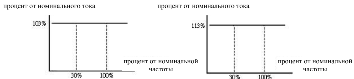
Кривая защиты двигателя от перегрузки OL1 для инверторного режима работы OL=113% старт, 123% / 1 мин
