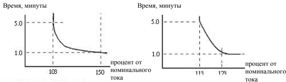
Защита двигателя от перегрузки OL1 (зависимость ток/ частота)
