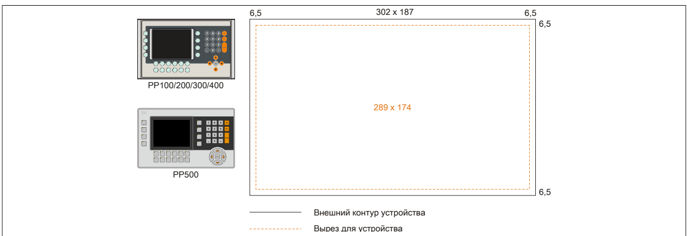
Рисунок 34: Монтажная совместимость панелей диагональю 5,7 дюйма, альбомный формат, вар. 2
