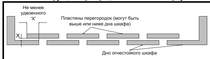
Рис. 3-2 Конструкция перегородок огнестойкого корпуса
