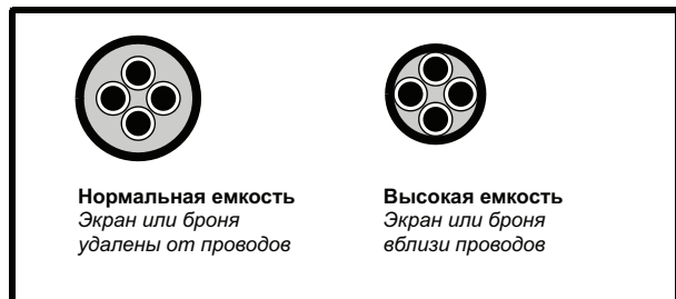
Рис. 4-13 Конструкция кабеля влияет на его емкость
