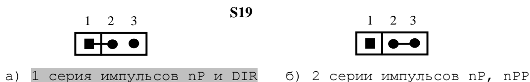
Рисунок 4.14 -Установка режима работы ЦИП
