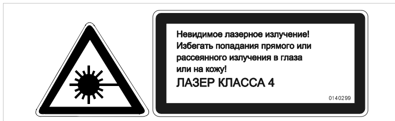
Таблички 2 и 9: предупреждающий символ "Лазер!" и табличка, указывающая на невидимое лазерное излучение 4-го класса Рис. 3616; 13028ru
