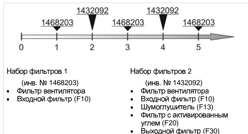
Генератор воздуха высокой чистоты: замена фильтров в зависимости от года использования
