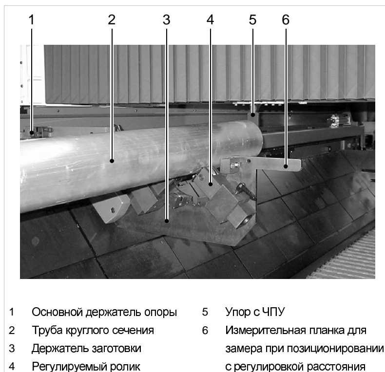
Упор с ЧПУ на унифицированном узле привода
