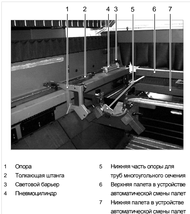
Механизм перемещения опоры
