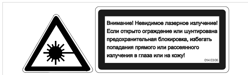
Таблички 2 и 3: предупреждающий символ "Лазер!" и предупреждающая табличка на ограждениях с защитной блокировкой
