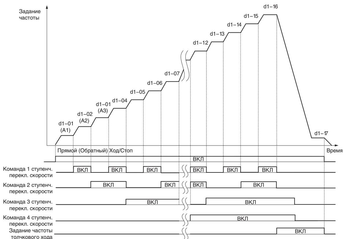
**Рис. 5.42** Временная диаграмма переключения предустановленных заданий частоты
