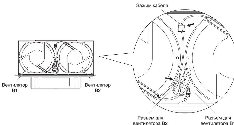
Рис. 7.23 Подключение цепей охлаждающего вентилятора: 2A0250, 2A0312 и 4A0208
