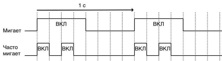
Рис. 4.3 Состояния светодиода «RUN» и их значения
