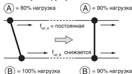
Функция распределения нагрузки уменьшает задание скорости привода В для балансировки нагрузки
