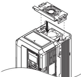
Рис. 7.6 Установите на место крышку вентилятора: 2A0021...2A0081, 4A0007...4A0044
