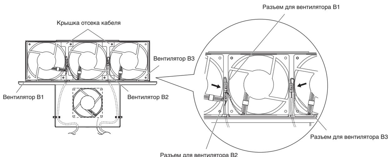
Рис. 7.24 Подключение цепей охлаждающего вентилятора: 2A0360, 2A0415, 4A0250...4A0362
