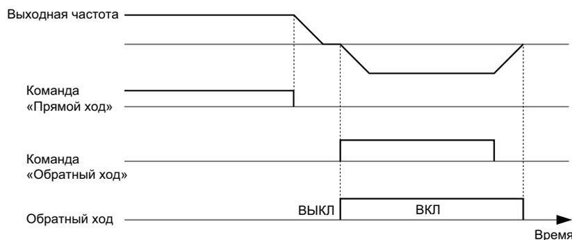
Рис. 5.75 Пример работы выхода сигнализации обратного направления
