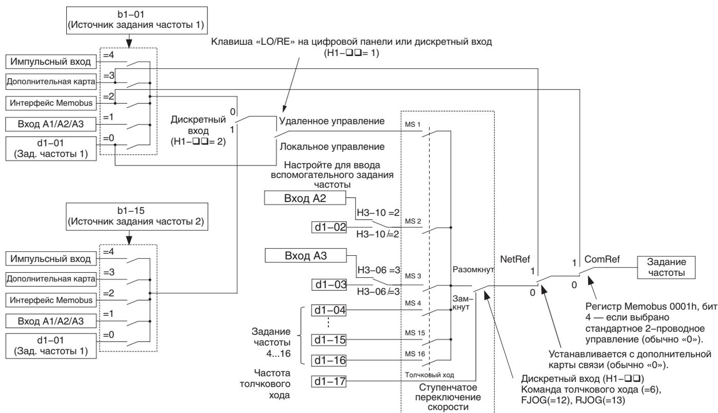
Рис. 5.41 Иерархическая структура способов ввода заданий частоты
