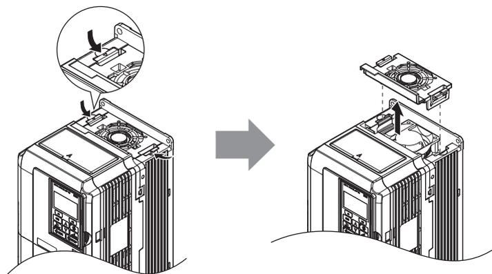
Рис. 7.2 Демонтаж крышки вентилятора: 2A0021...2A0081, 4A0007...4A0044
