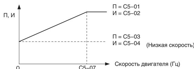
Рис. 5.38 Настройка коэффициента передачи для низкой и высокой скорости
