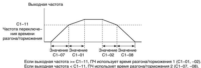
**Рис. 5.31 Переключение времени разгона/торможения в зависимости от частоты**
