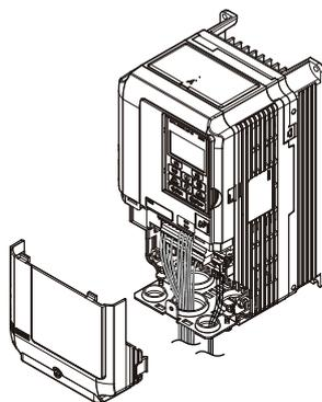
Рис. 7.42 Замена преобразователя частоты: снятие крышки клеммного блока
