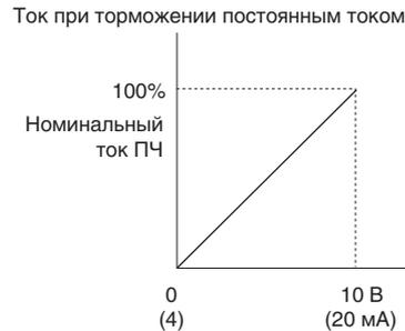
Рис. 5.81 Установка уровня тока для торможения пост. током с помощью аналогового входа
