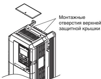
Рис. 3.19 Установка верхней защитной крышки
