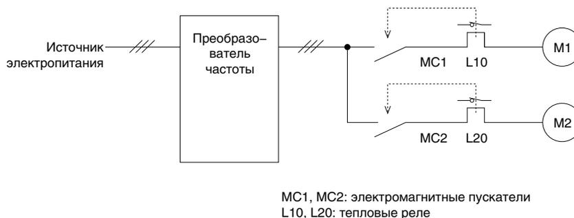
Рис 5.86 Пример схемы защиты для нескольких двигателей
