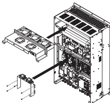
Рис. 7.40 Монтаж модулей охлаждающих вентиляторов 4A0515 и 4A0675
