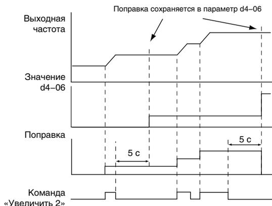
Рис. 5.47 Пример работы функции Увеличить2/Уменьшить2 при поступлении задания частоты от любого источника, кроме цифровой панели, когда d4-01 = 1
