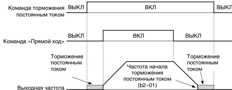
**Рис. 5.64 Работа входа команды торможения постоянным током**
