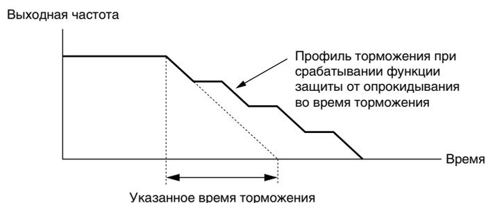
**Рис 5.99** Предотвращение опрокидывания ротора при торможении
