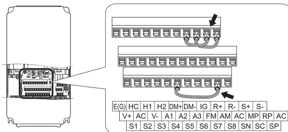
Рис. С.8 Соединение клемм для самодиагностики связи
