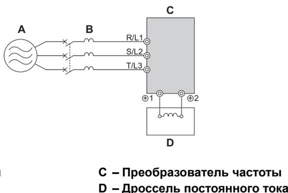
Рис. 8.12 Подключение дросселя постоянного тока
