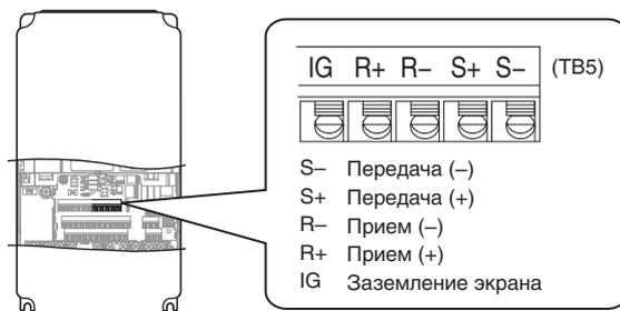
Рис. С.2 Клеммы для подключения кабеля последовательного интерфейса (TB5)
