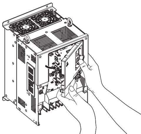
Рис. 3.16 Снимите переднюю крышку (2A0110...2A0415 и 4A0058...4A0675)
