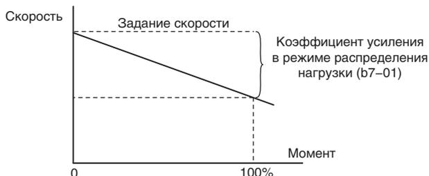
Рис. 5.28 Коэффициент ослабления в режиме распределения нагрузки
