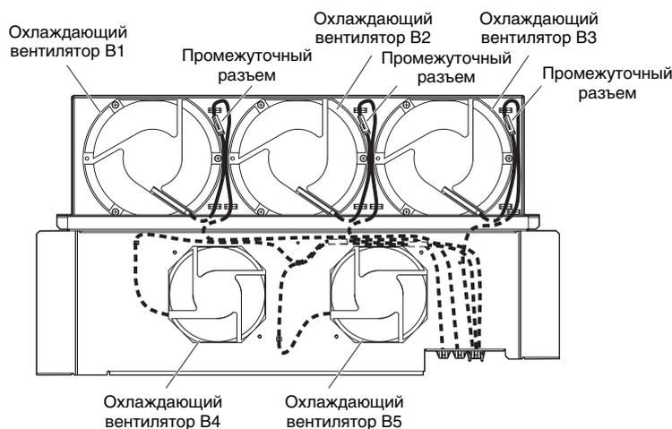
Рис. 7.37 Подключение цепей охлаждающего вентилятора: 4A0515 и 4A0675
