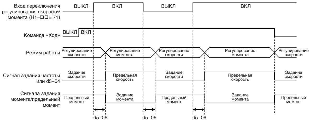
Рис. 5.51 Время переключения регулирования скорости/вращающего момента
