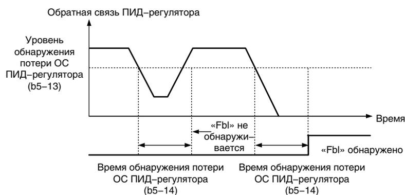
Рис. 5.24 Обнаружение потери сигнала обратной связи ПИД-регулятора
