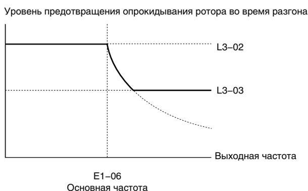
Рис 5.98 Уровень и предел предотвращения опрокидывания ротора во время разгона
