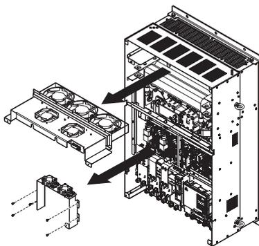
**Рис. 7.33 Демонтаж вентиляторных модулей: 4A0515 и 4A0675**
