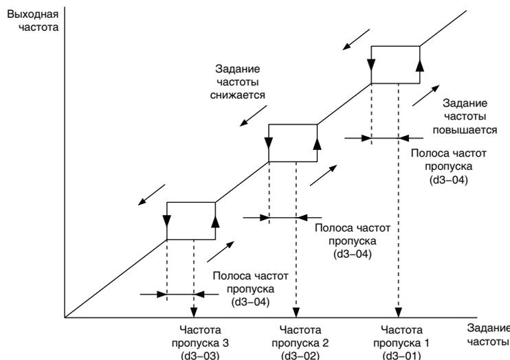
Рис. 5.44 Работа функции пропуска частоты
