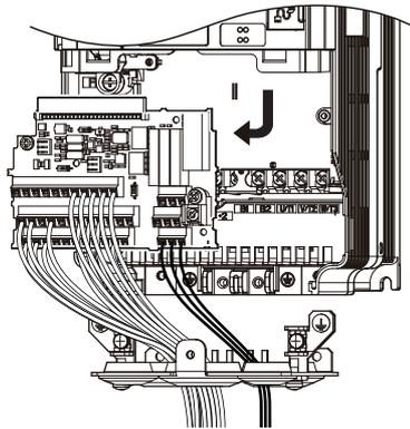
Рис. 7.44 Замена преобразователя частоты: удалите клеммную плату
