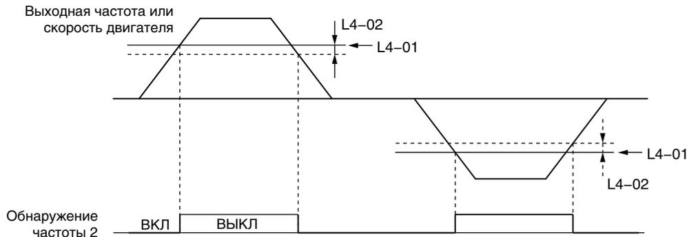
Рис. 5.70 Временная диаграмма обнаружения частоты 2
