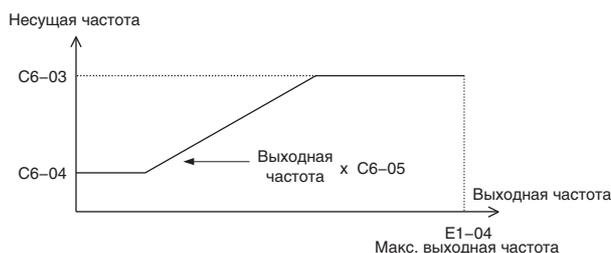
**Рис. 5.40** Несущая частота изменяется пропорционально выходной частоте
