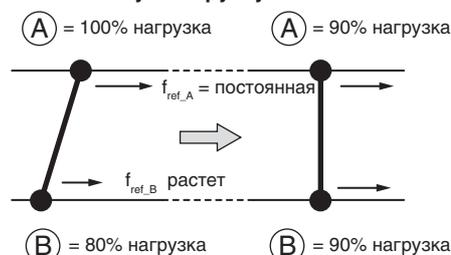
Функция распределения нагрузки повышает задание скорости привода В для балансировки нагрузки
