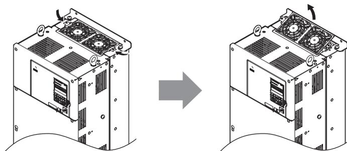
Рис. 7.7 Демонтаж крышки охлаждающего вентилятора: 2A0110 и 2A0138, 4A0058 и 4A0072
