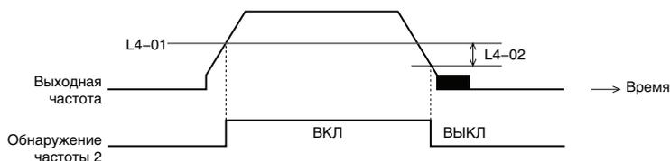
Рис. 4.12 Обнаружение частоты 2
