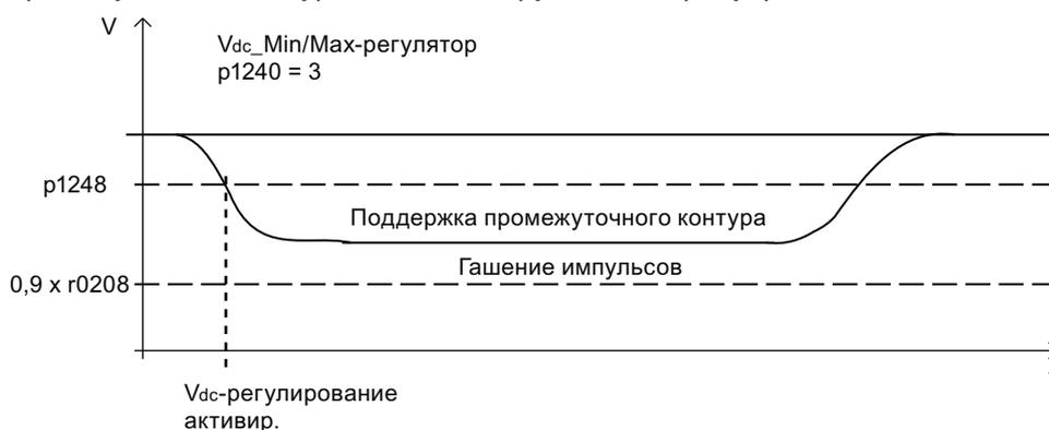
Рисунок 9-32 Уставка напряжения промежуточного контура
