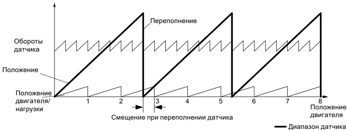
Рисунок 8-13 Привод с нечетным редуктором без отслеживания положения
