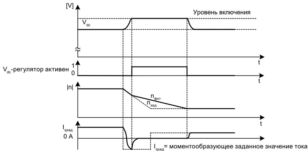
Рисунок 6-15 Включение/выключение V<sub>dc\_max</sub>-регулирования
