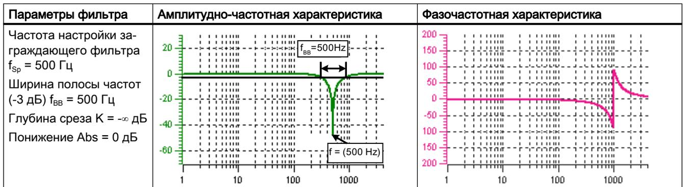
Упрощенный пересчет в параметры для фильтра общего порядка:
