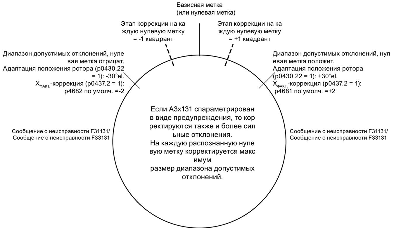
Рисунок 8-8 Обзор: Окно допуска и коррекция
