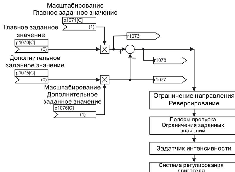
Рисунок 4-2 Суммирование уставок, масштабирование уставки
