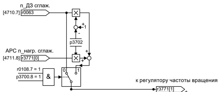
Рисунок 9-41 APC с функцией смешивания датчиков
