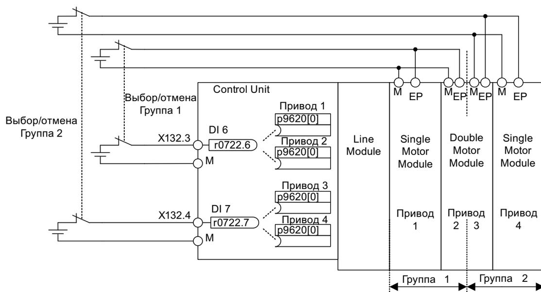
Рисунок 11-3 Пример: Группировка клемм с модулями двигателей книжного формата и CU320-2
