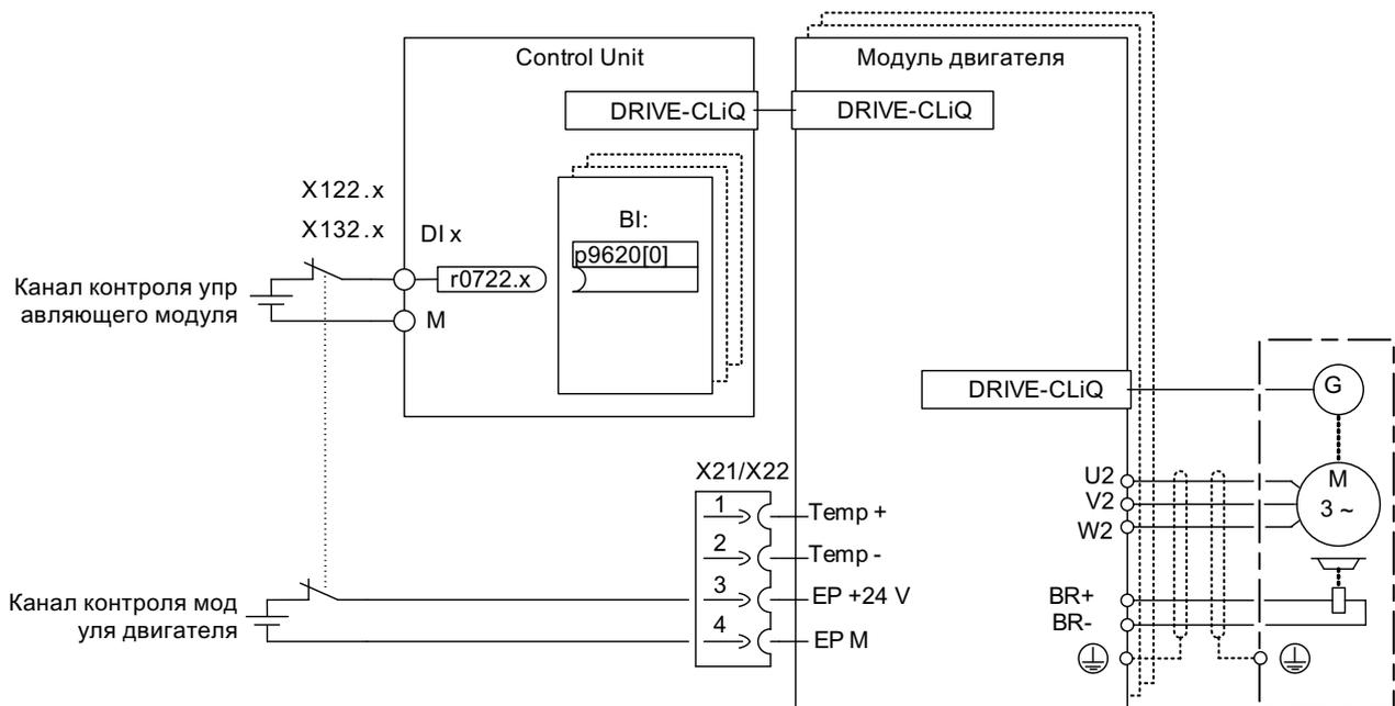
Рисунок 11-2 Пример: Клеммы для «Safe Torque Off», пример модулей двигателей книжного формата и CU320-2
