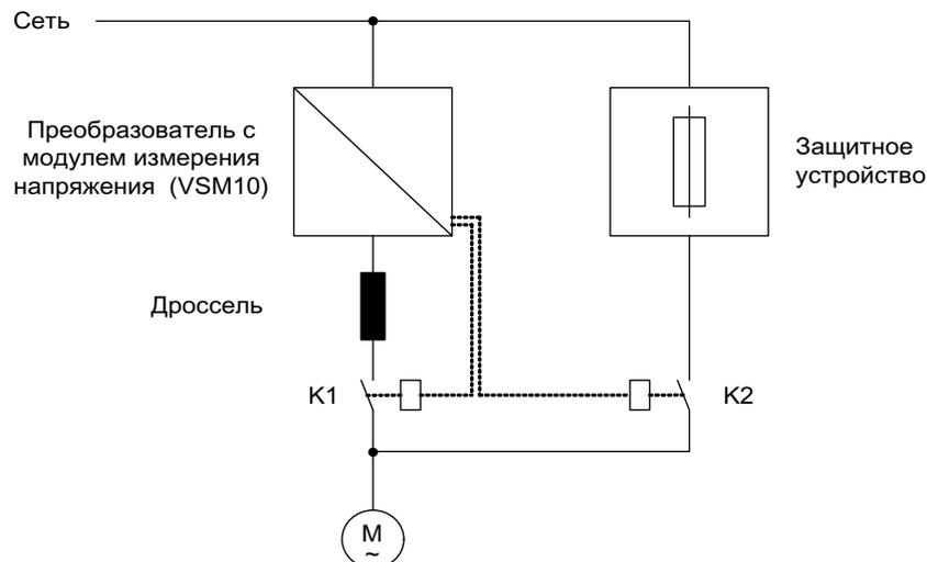
Рисунок 6-25 Пример включения: Байпас с синхронизацией с перекрытием
