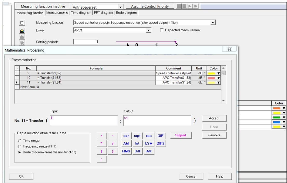
Рисунок 9-55 Пример: Передаточные функции
