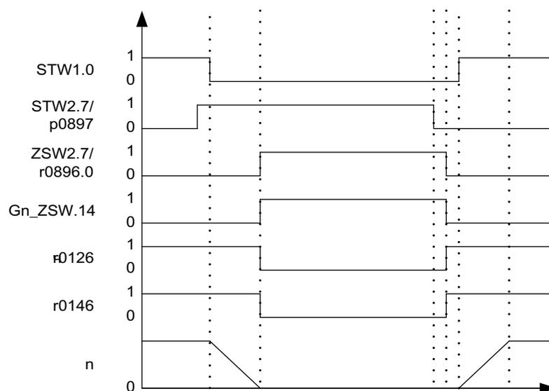
Рисунок 8-9 Блок-схема — ось в режиме ожидания
