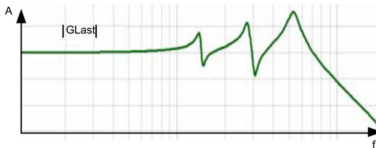
Рисунок 9-49    Частотная характеристика нагрузки без APC
