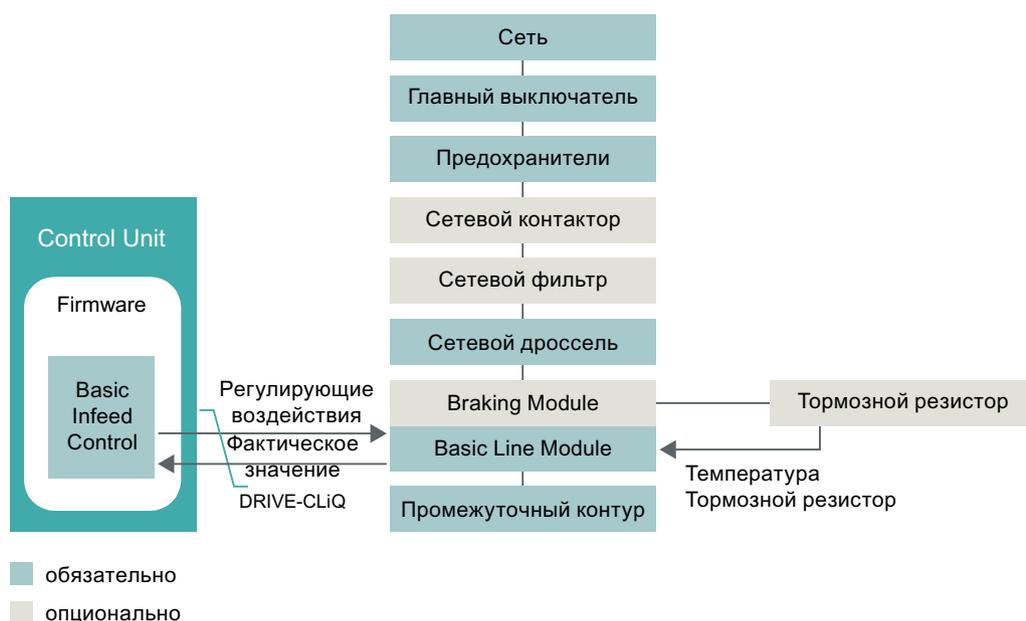
Рисунок 3-5 Схематическая структура системы Basic Infeed формата "шасси"
