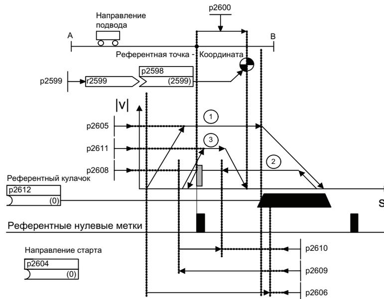
Рисунок 9-18 Пример реферирования с референтными кулачками
