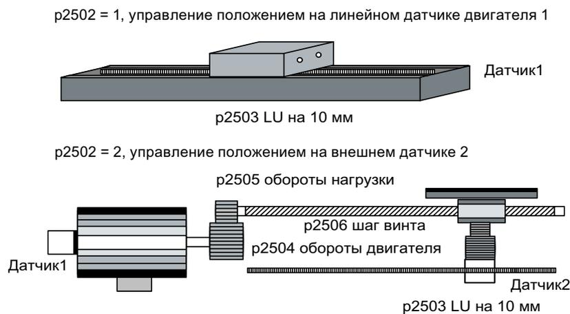
Рисунок 9-7 Регистрация фактического значения положения с помощью кругового датчика
