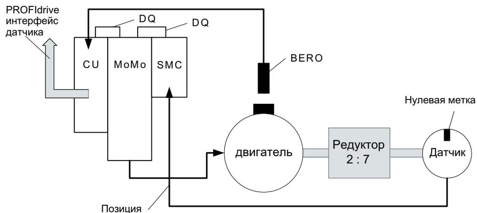
Рисунок 9-20 Измерительный редуктор между двигателем и датчиком
