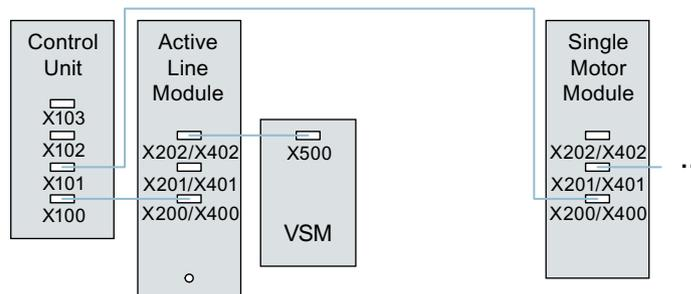
Рисунок 14-23 Пример топологии с VSM с компонентами книжного формата и формата «шасси»
