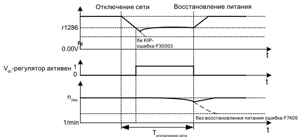
Рисунок 7-4 Включение/выключение  $V_{dc\_min}$ -регулирования (кинетическая буферизация)
