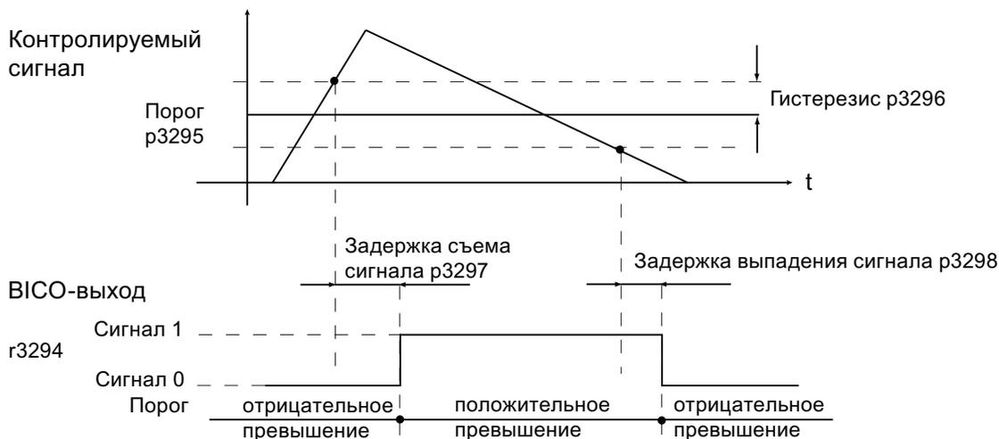
Рисунок 5-30 Диаграмма: Переменная сигнальная функция
