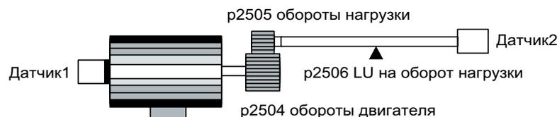
Рисунок 9-6 Регистрация фактического значения положения с круговыми датчиками
