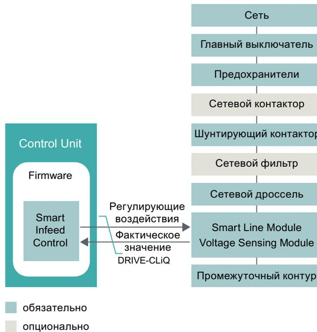
Рисунок 3-8 Схематическая структура системы Smart Infeed формата "шасси"
