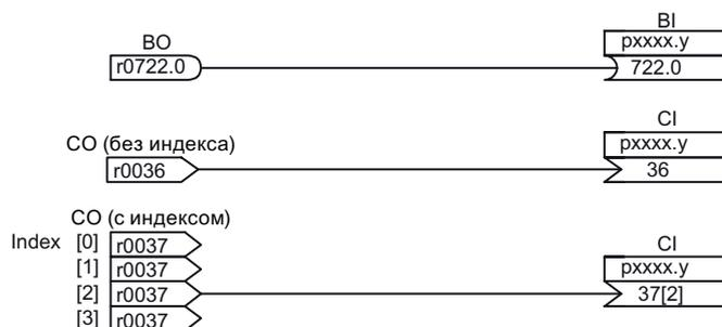
Рисунок 14-8 Соединение сигналов при помощи техники BICO
