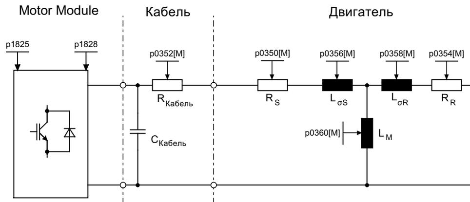
Рисунок 5-18 Эквивалентная схема - Асинхронный двигатель и кабель
