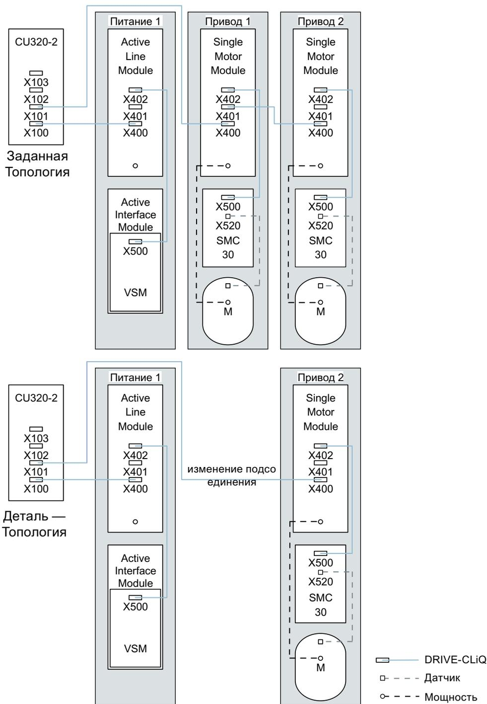
Рисунок 8-2 Пример частичной топологии
