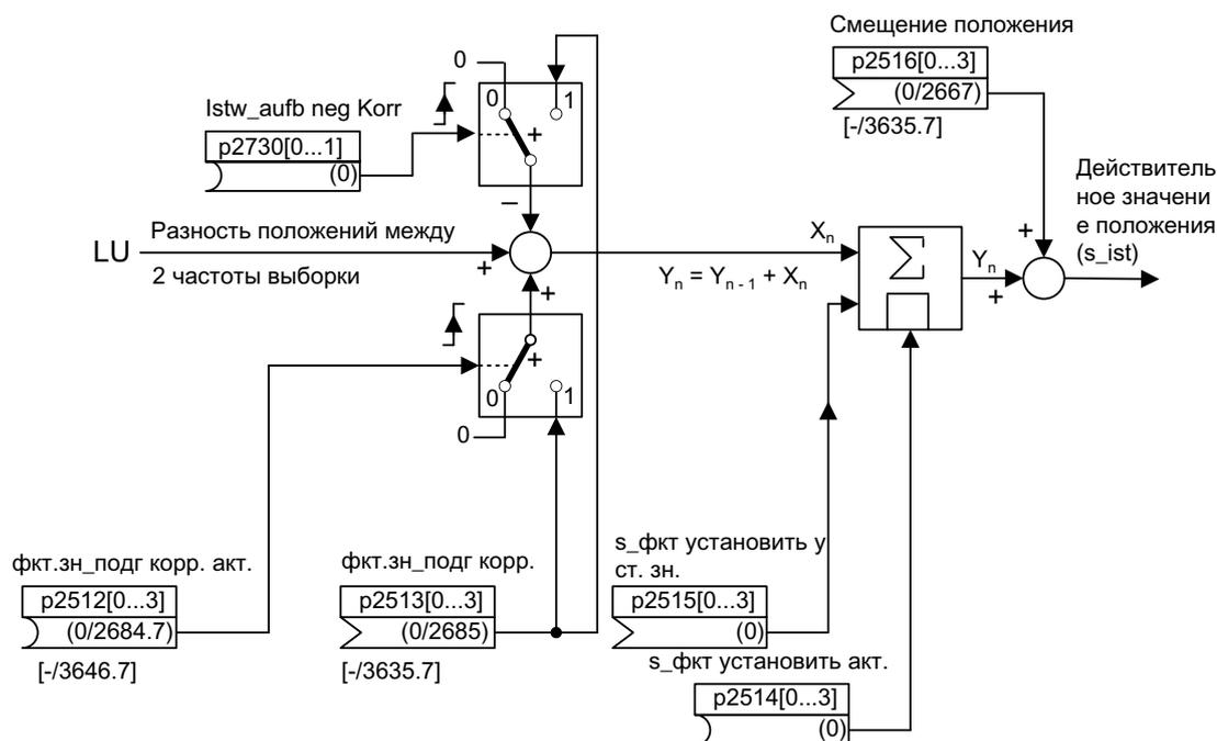
Рисунок 9-8 Характеристика сигнала: Подготовка фактического значения положения при линейном датчике
