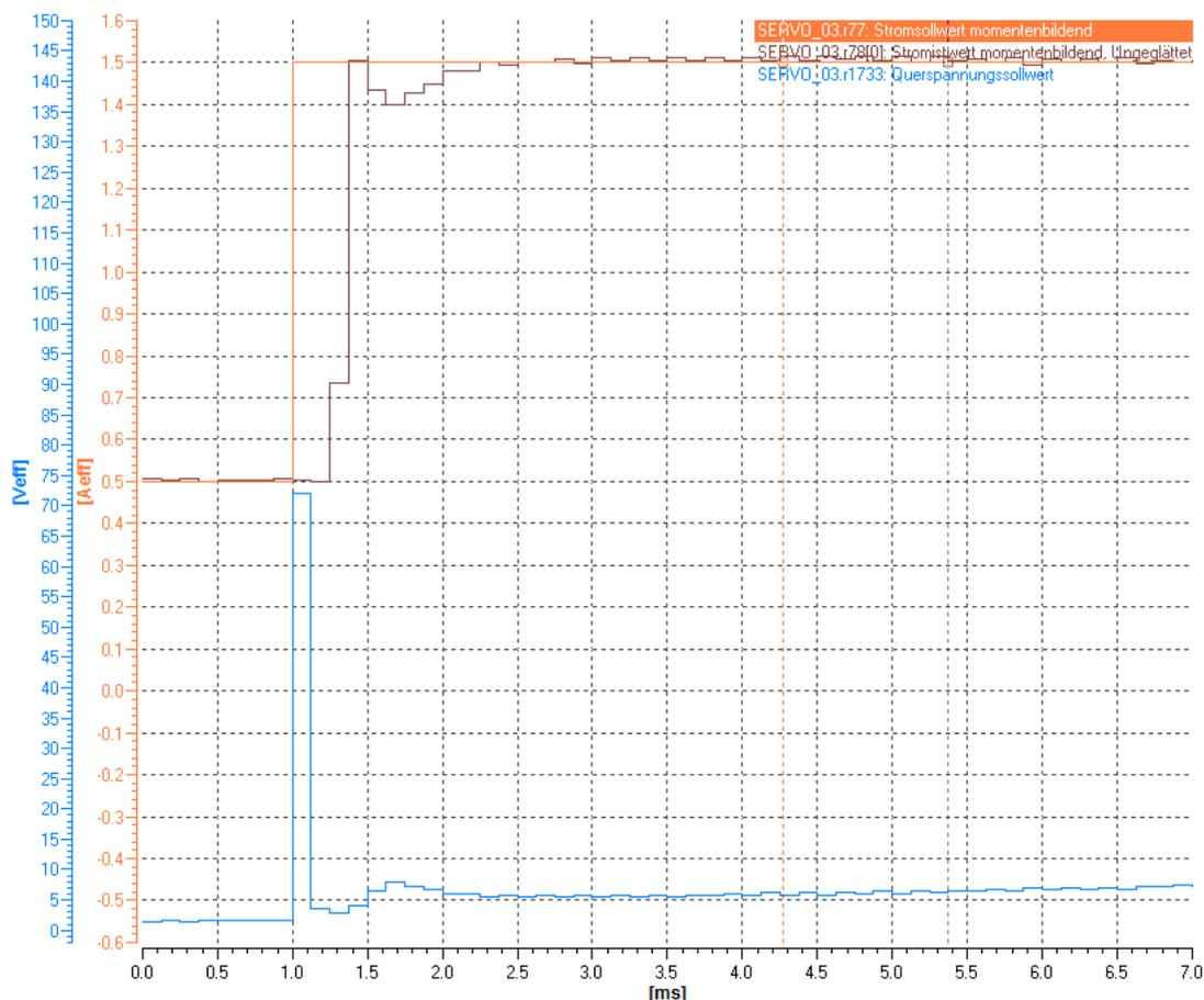
Рисунок 5-39 Пример: Предуправление по напряжению перед оптимизацией (с выходом за пределы)
