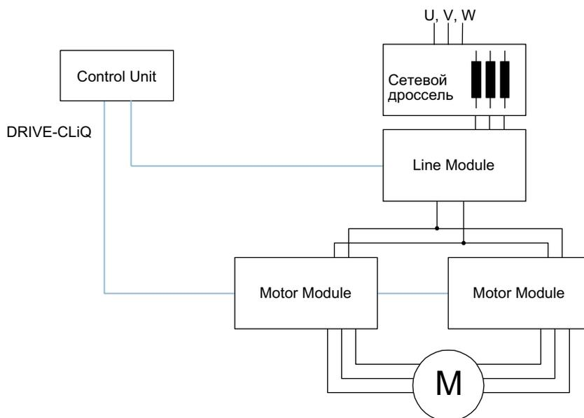
Рисунок 9-27 Параллельное включение двух модулей Motor Module на один двигатель с двухобмоточной системой
