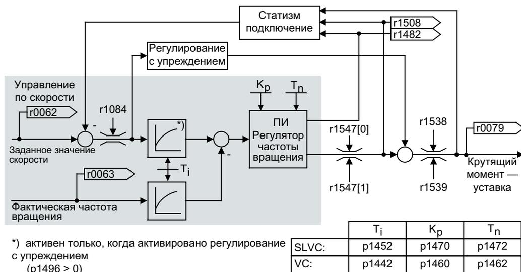
Рисунок 6-6 Обзор: Регулятор частоты вращения
