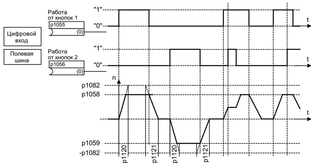
Рисунок 4-4 Технологическая схема процесса: Толчковый режим 1 и Толчковый режим 2
