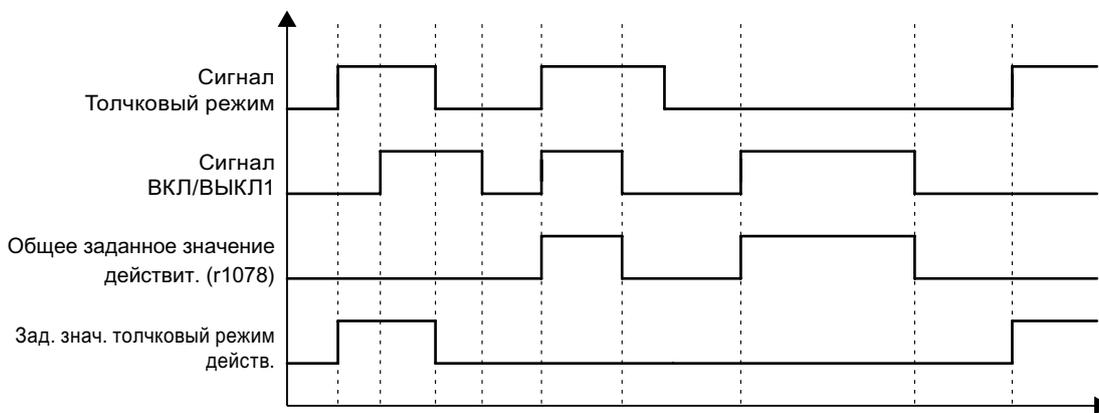
Рисунок 4-3 Технологическая схема процесса: Толчковый режим и ВЫКЛ1
