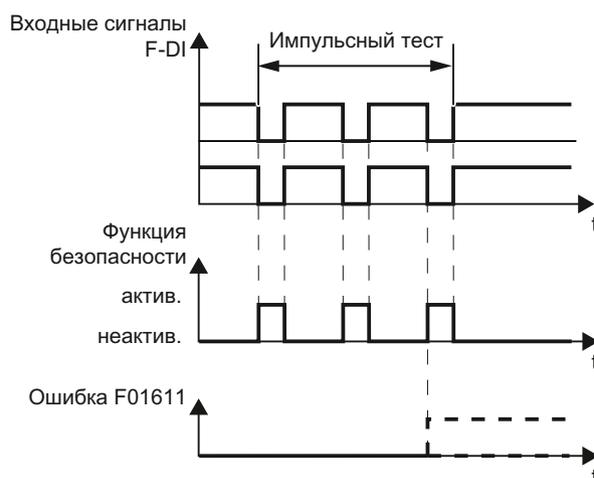
Рисунок 11-5 Реакция преобразователя на импульсный тест
