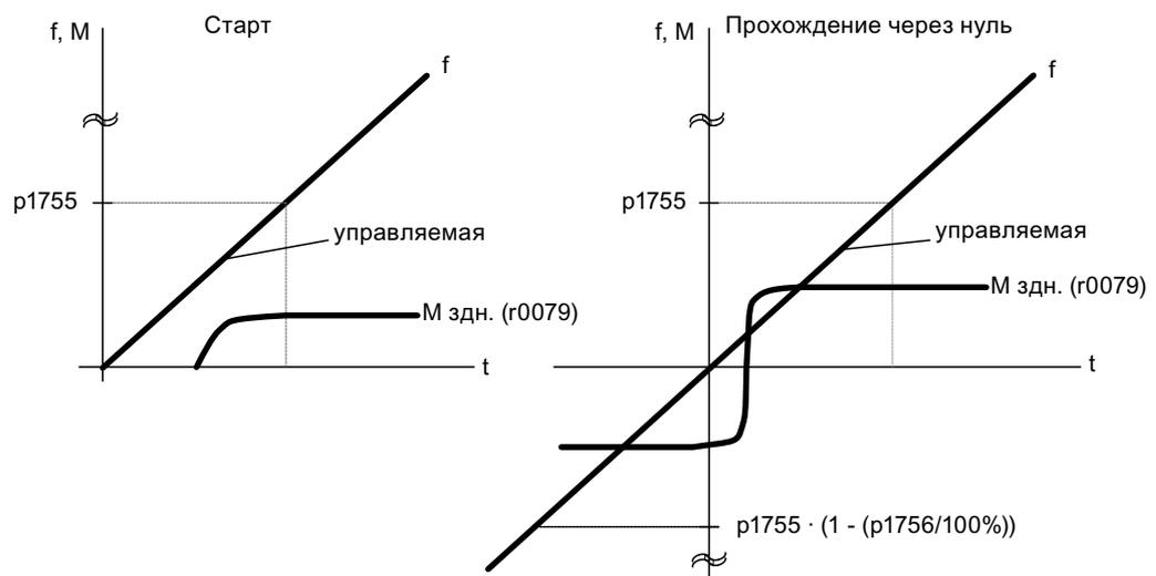
Рисунок 6-4 Переход через ноль и запуск в управляемом режиме на малой частоте вращения
