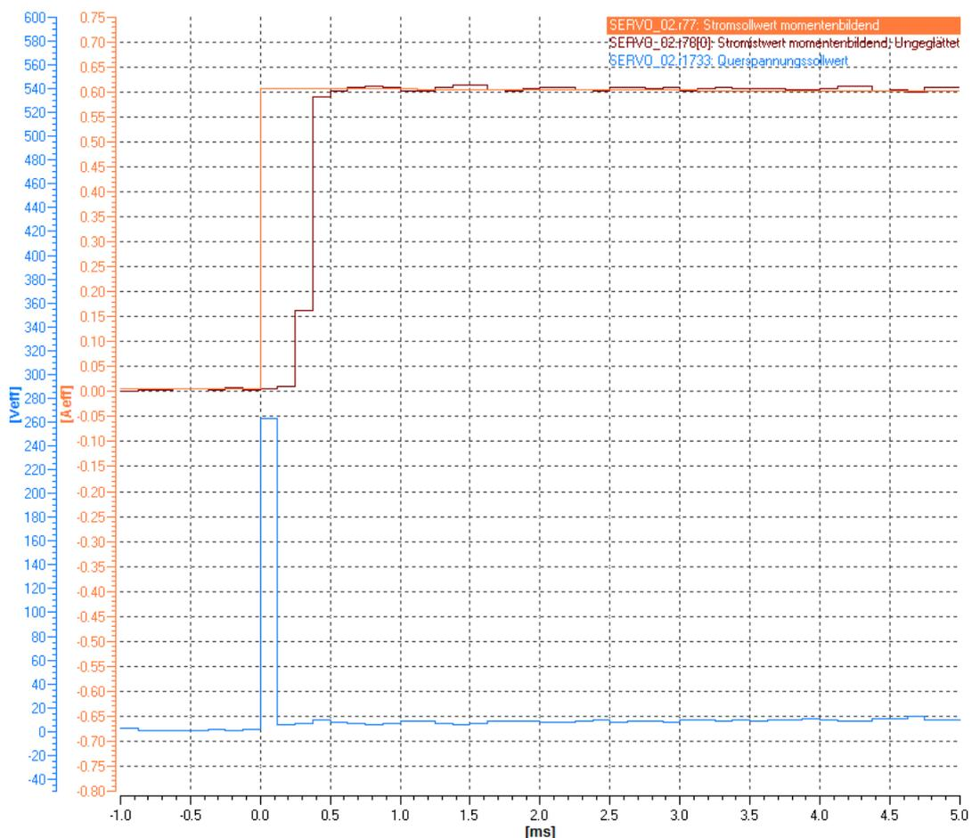
Рисунок 5-37 Пример: Предуправление по напряжению p1703 в норме
