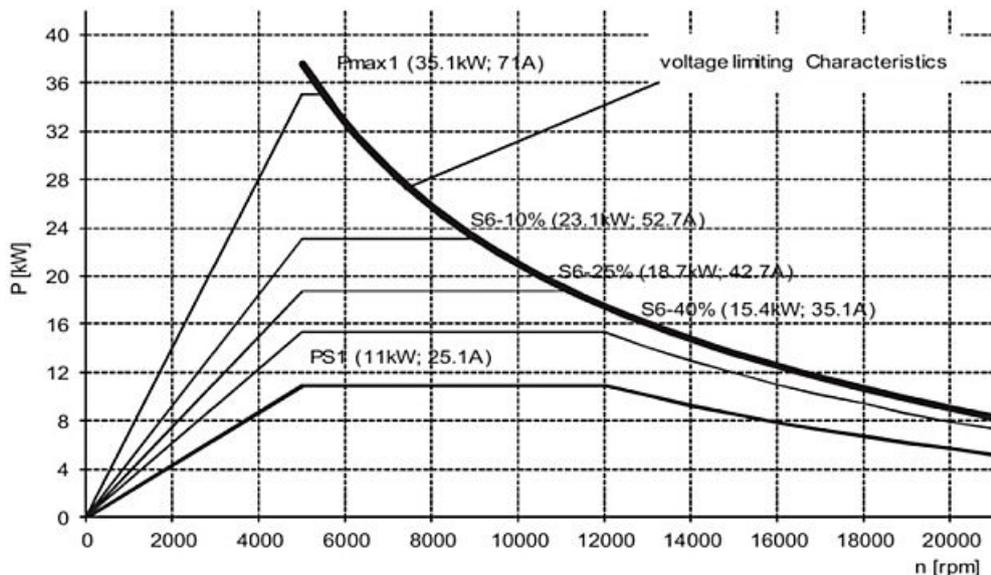
Рисунок 5-12 Асинхронный двигатель: Характеристика мощность-крутящий момент
