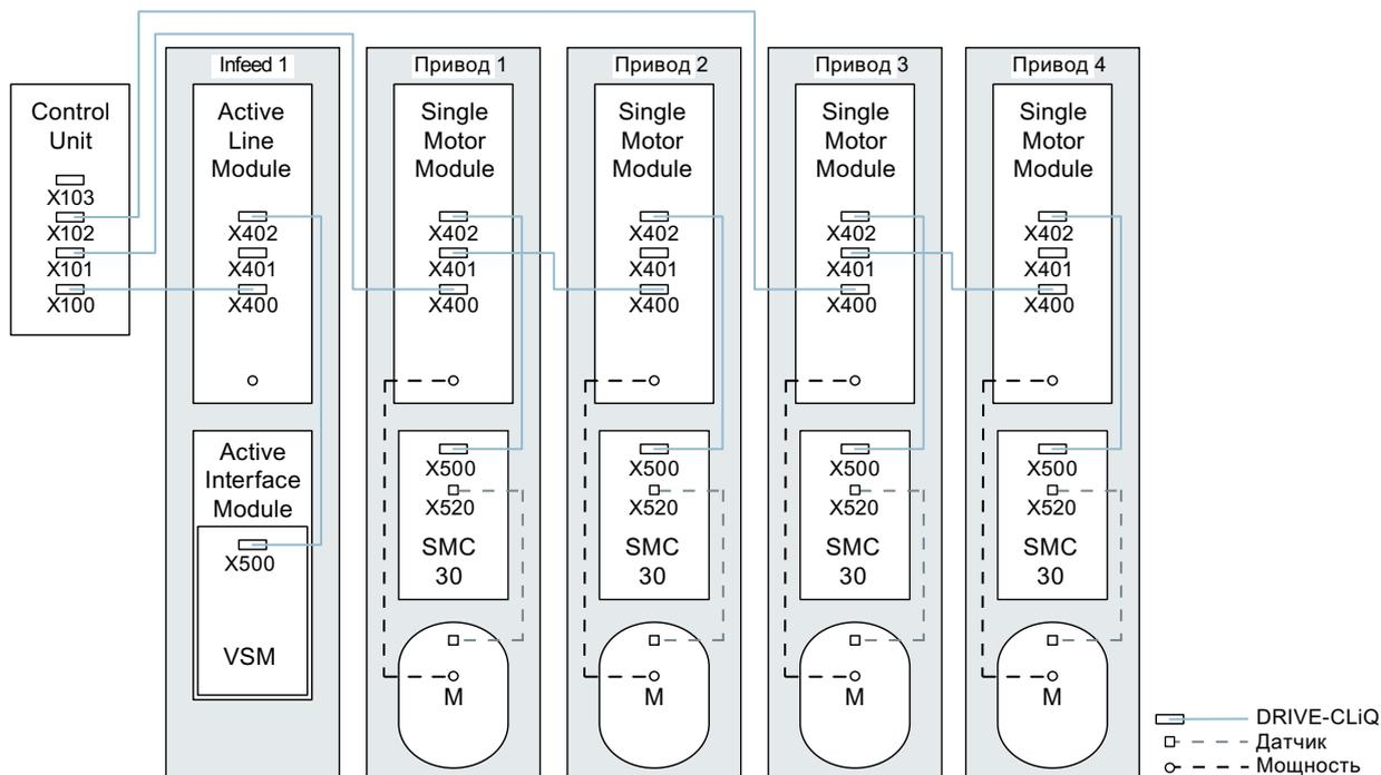
Рисунок А-2 Модули Motor Module формата "шасси" с различной частотой импульсов
