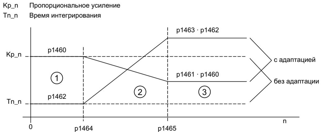
Рисунок 5-5 Пример: Адаптация в зависимости от частоты вращения
