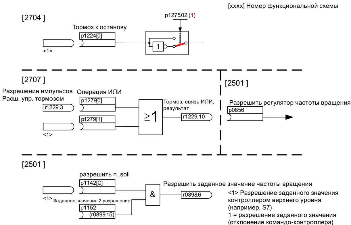
Рисунок 9-4 Пример рабочего тормоза привода крана
