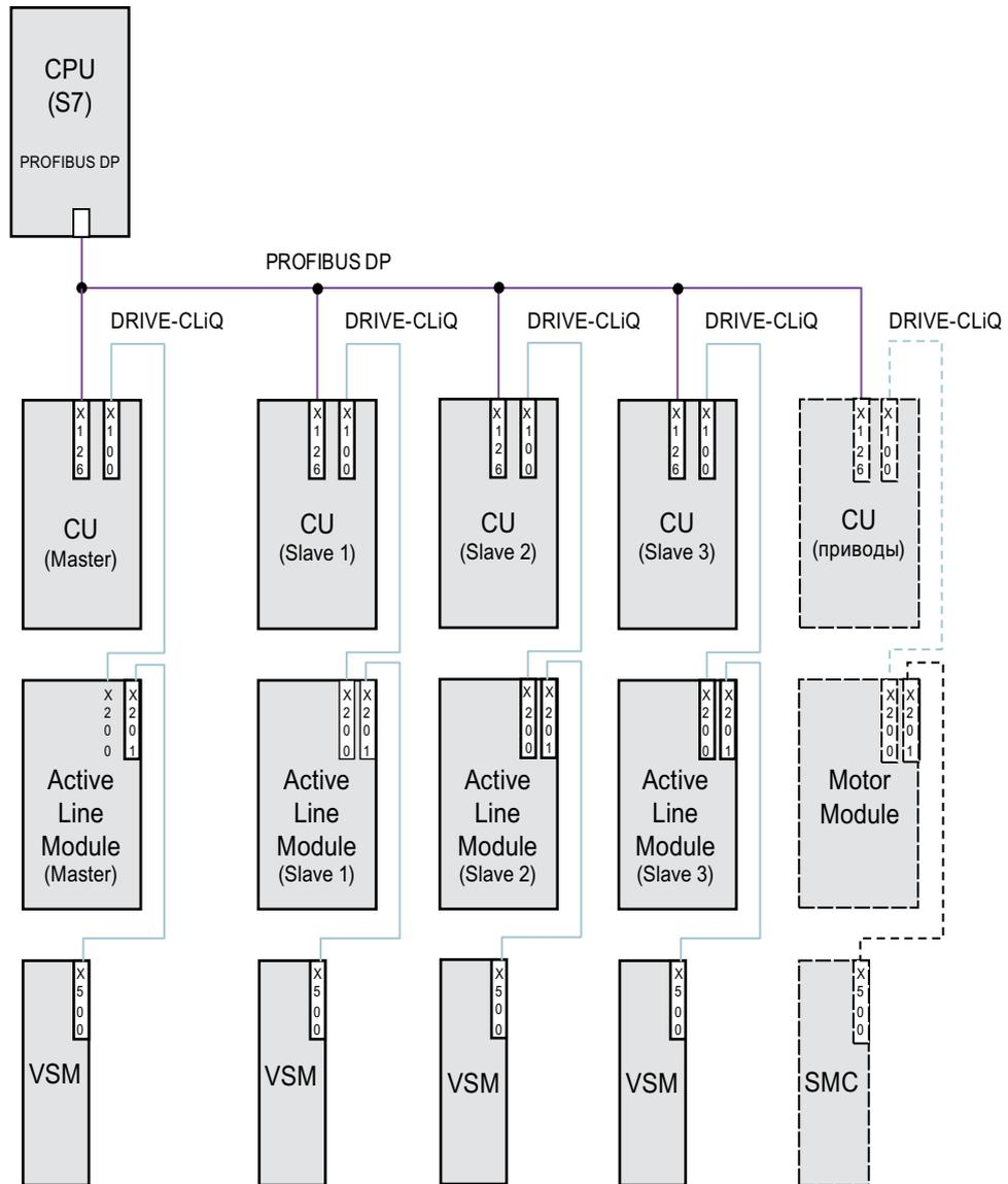
Рисунок 9-25 Топологическая структура: Режим Master/Slave с дублирующими модулями питания, вариант связи PROFIBUS
