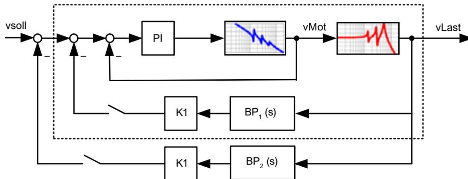
Рисунок 9-48    Контур регулирования с 2 обратными связями APC
