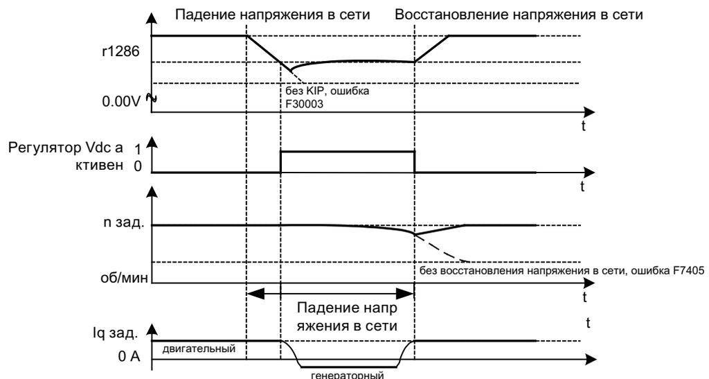
Рисунок 6-14 Включение/выключение  $V_{dc\_min}$ -регулирования (кинетическая буферизация)
