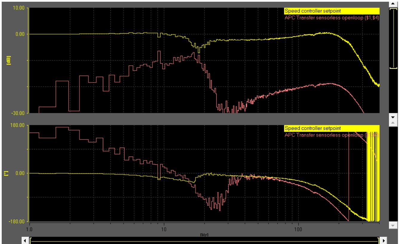
Рисунок 9-37 APC без датчика на стороне нагрузки (p3700 = 4) – разомкнутый контур
