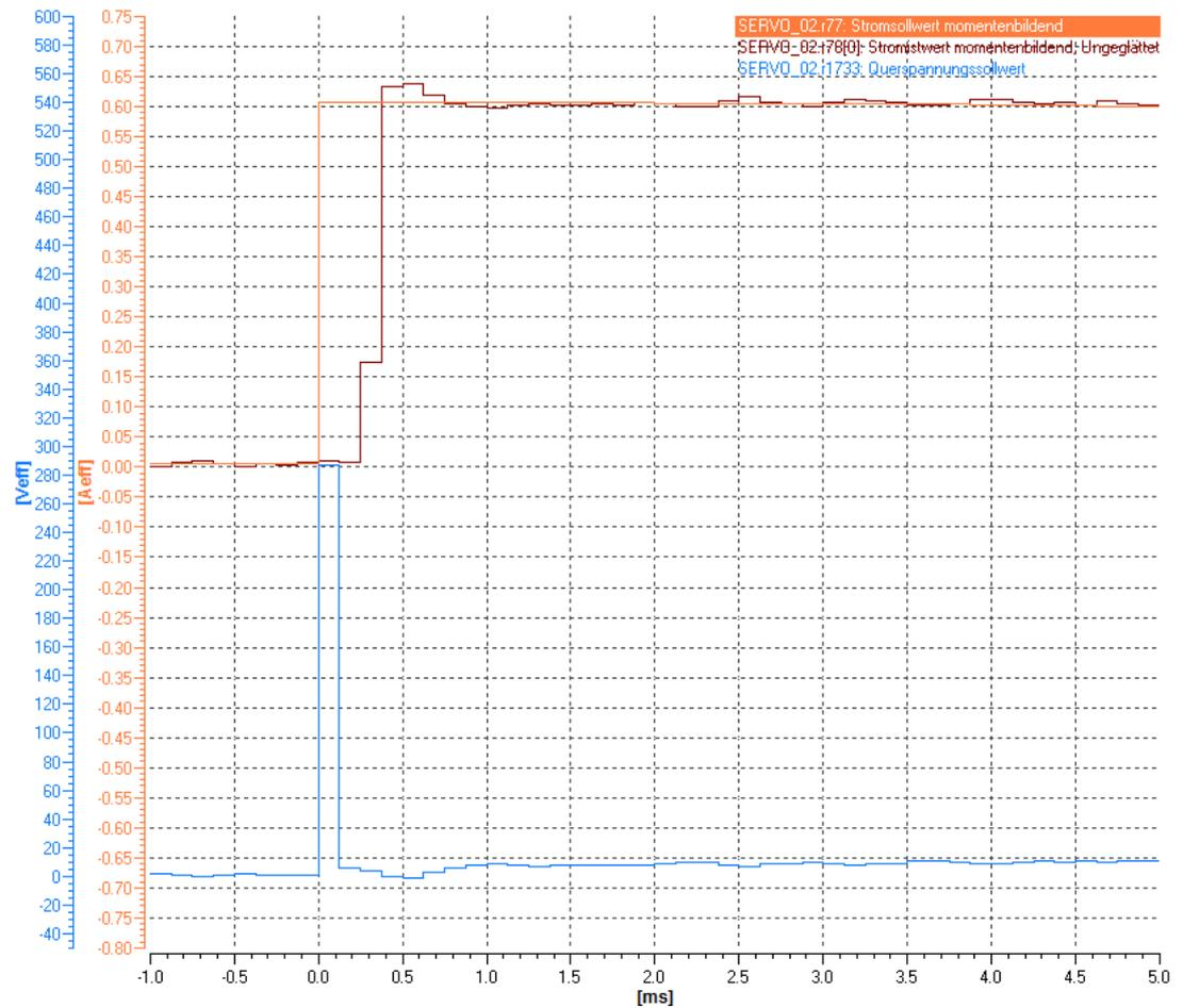
Рисунок 5-38 Пример: Предусиление регулирования напряжения p1703 слишком велико
