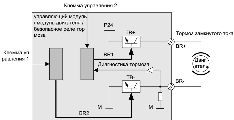
Рисунок 11-1 Двухканальное управление торможением блочного формата (пример)
