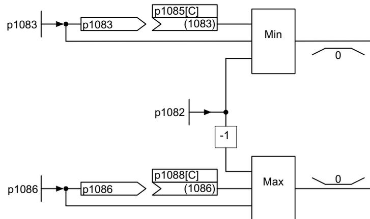
Рисунок 5-3 Ограничения регулятора частоты вращения
