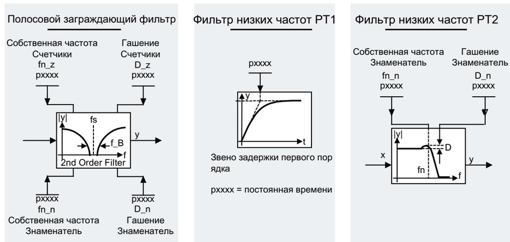
Рисунок 5-2 Обзор: Фильтр уставок частоты вращения
