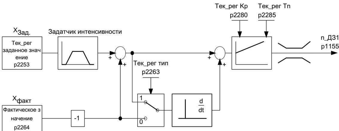
Рисунок 9-2 Регулирование уровня заполнения: Структура регулятора
