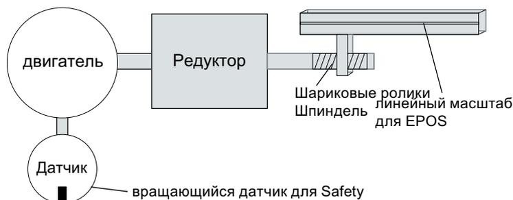
Рисунок 9-22 Пример 2: EPOS и безопасное реферирование (линейное)
