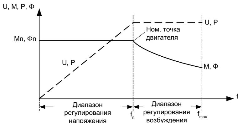
Рисунок 7-1 Рабочие диапазоны и кривые характеристик асинхронного двигателя при питании от преобразователя
