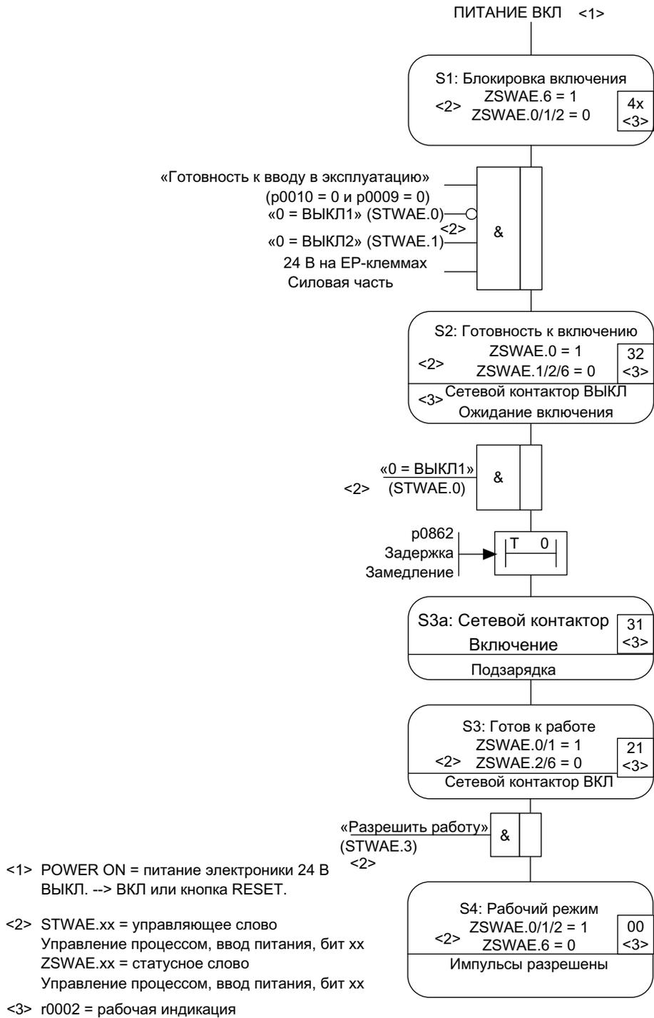
Рисунок 3-9 Процесс запуска системы Smart Infeed
