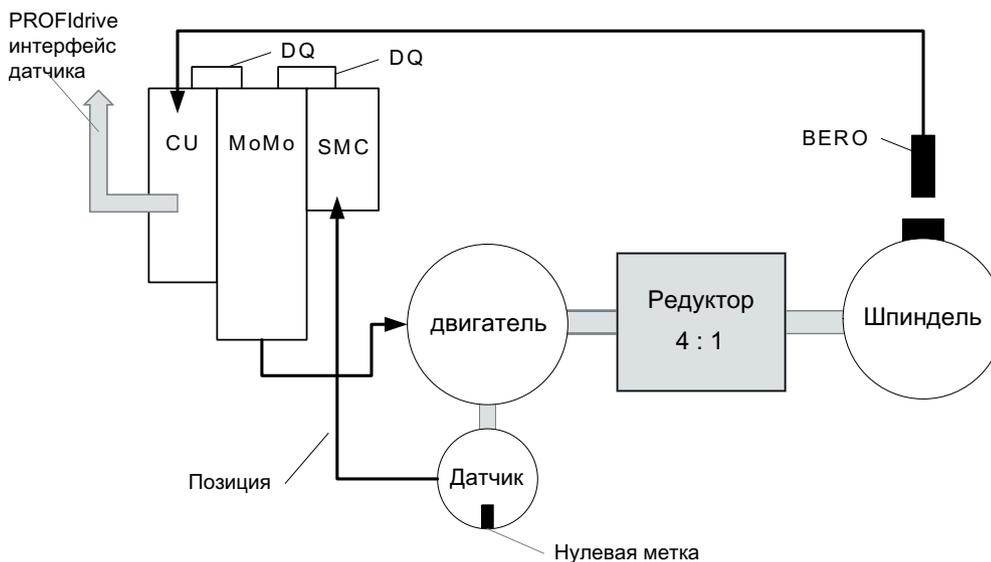
Рисунок 9-19 Редуктор между двигателем и шпинделем
