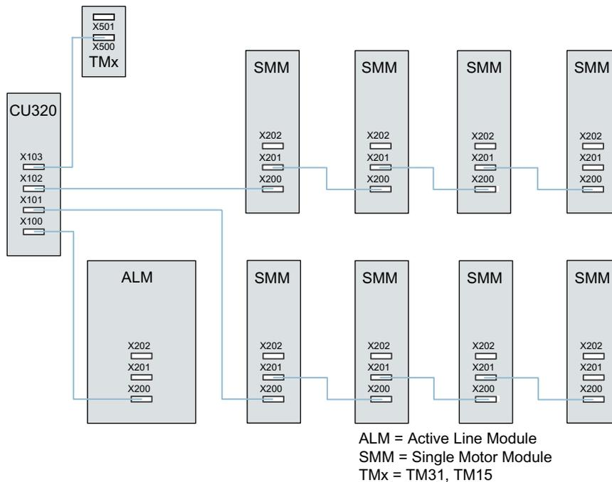
Рисунок А-7 Приводная группа в режиме управления U/f
