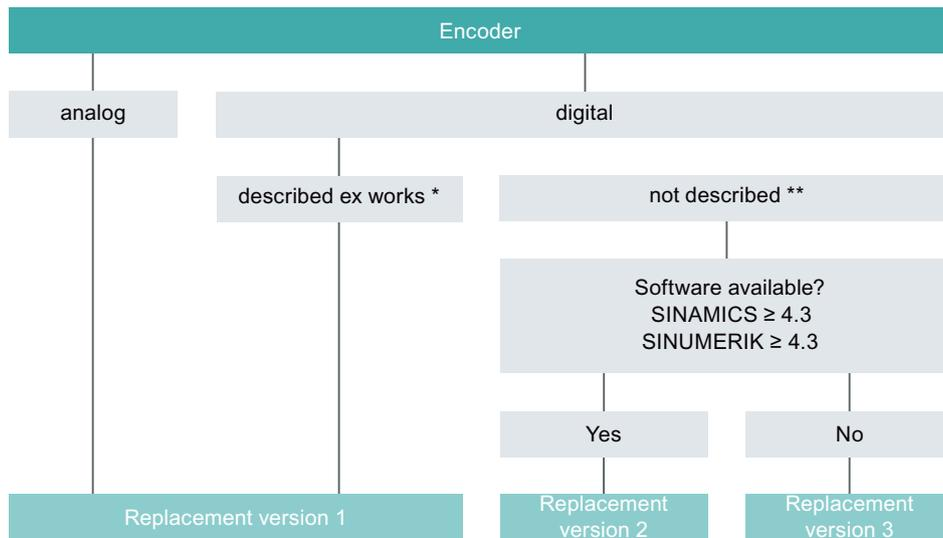
\* Датчик содержит параметры двигателя (электронная табличка).
