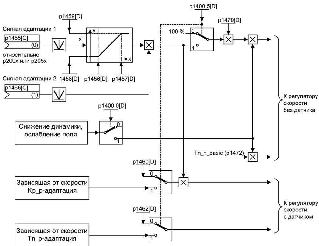
Рисунок 5-4 Обзор: Произвольная адаптация
