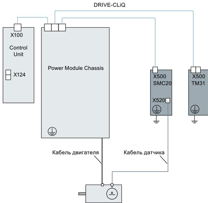
Рисунок А-5 Модули Power Module формата "шасси"
