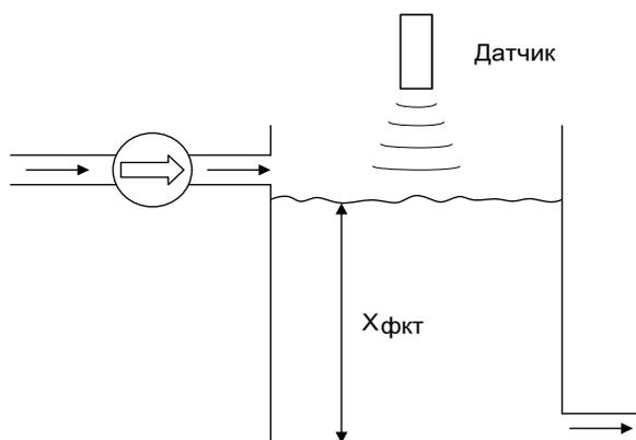
Рисунок 9-1 Регулирование уровня заполнения, приложение
