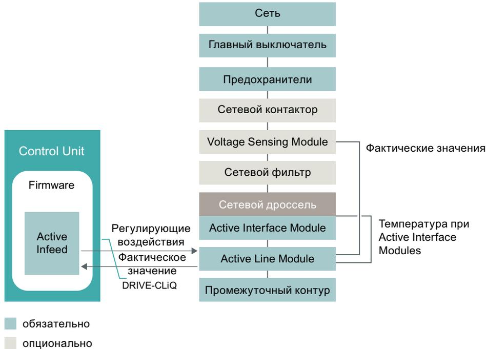
Рисунок 3-1 Схематическая структура системы Active Infeed книжного формата
