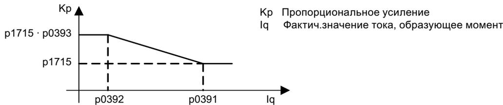
Рисунок 6-17 Адаптация регулятора тока с переставленными  $I_q$ -опорными точками, для  $p0393 > 1$ , при этом  $p0392 < p0391$
