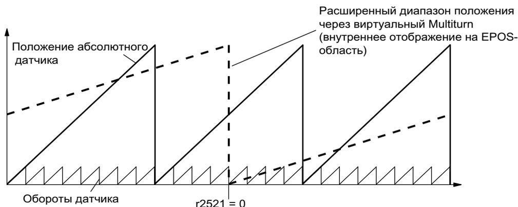
Рисунок 9-9 Отслеживание положения (p2721 = 24), установка p2504 = p2505 = 1 (передаточное число = 1)
