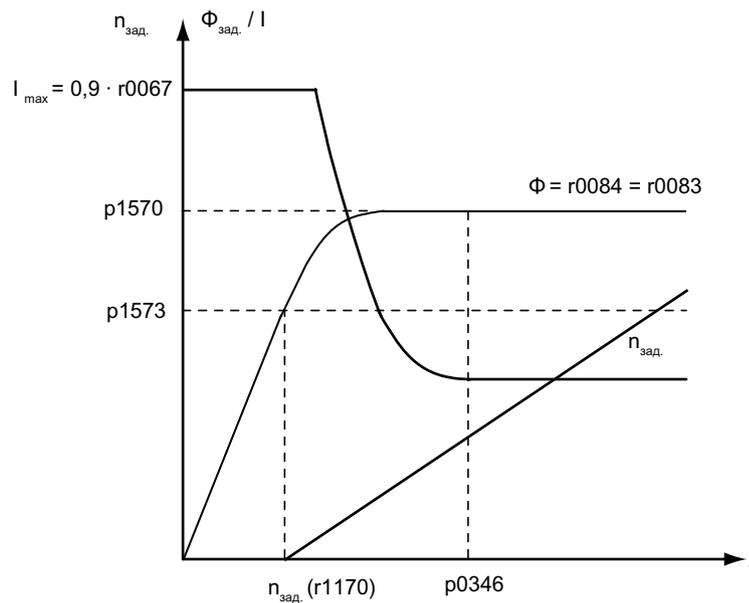
Рисунок 6-22 Характеристики для быстрого намагничивания
