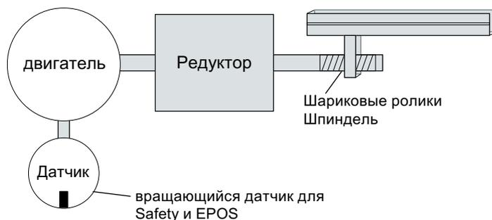
Рисунок 9-23 Пример 3: EPOS и безопасное реферирование (линейное)
