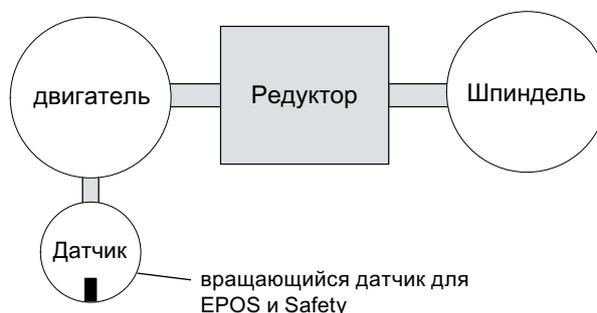
Рисунок 9-21 Пример 1: EPOS и безопасное реферирование (круговое)
