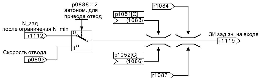
Рисунок 9-31 Интерфейс канала уставки на задатчике интенсивности
