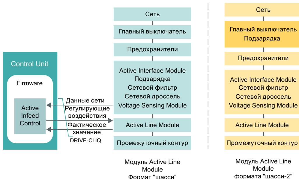
Рисунок 3-2 Схематическая структура управления Active Infeed Chassis и Chassis-2
