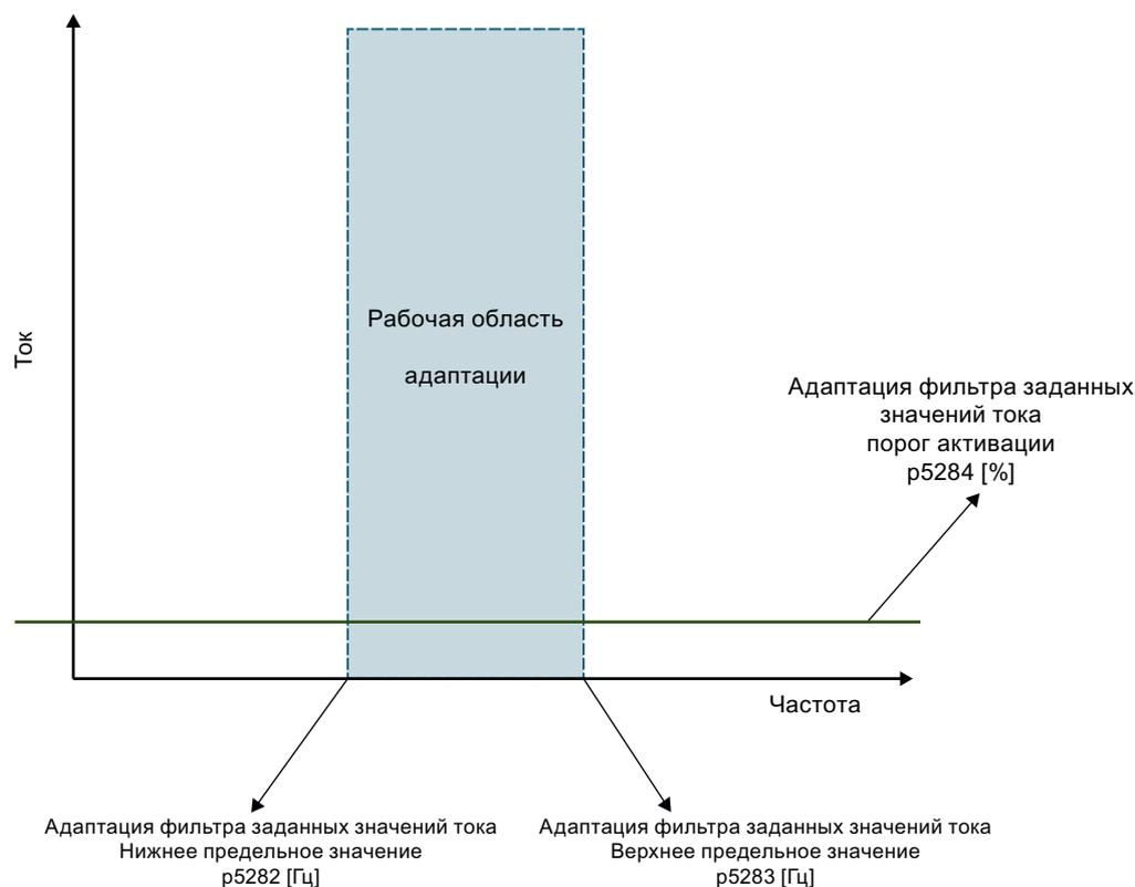
Рисунок 5-10 Принцип действия функции адаптации
