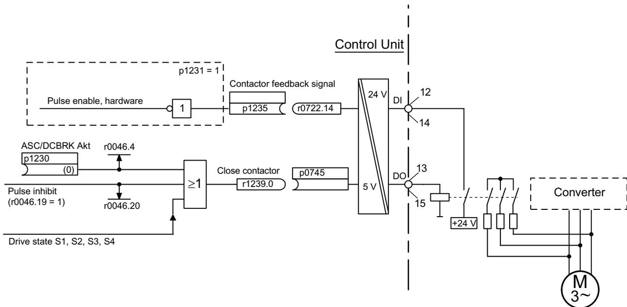
Рисунок 8-4 Пример: Внешнее торможение закорачиванием якоря
