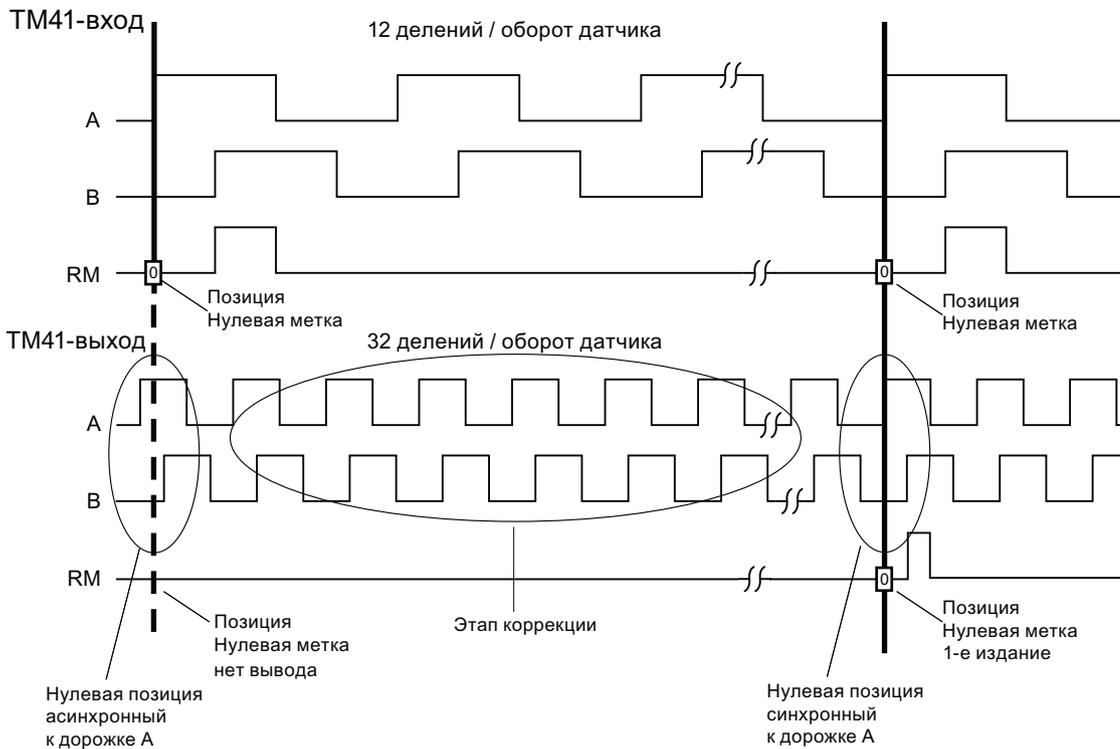
Рисунок 8-20 Пример: Синхронизация нулевых меток
