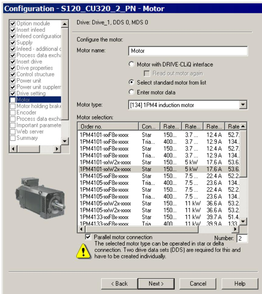
Рисунок 8-22 Выбор параллельного включения двигателей при векторном управлении
