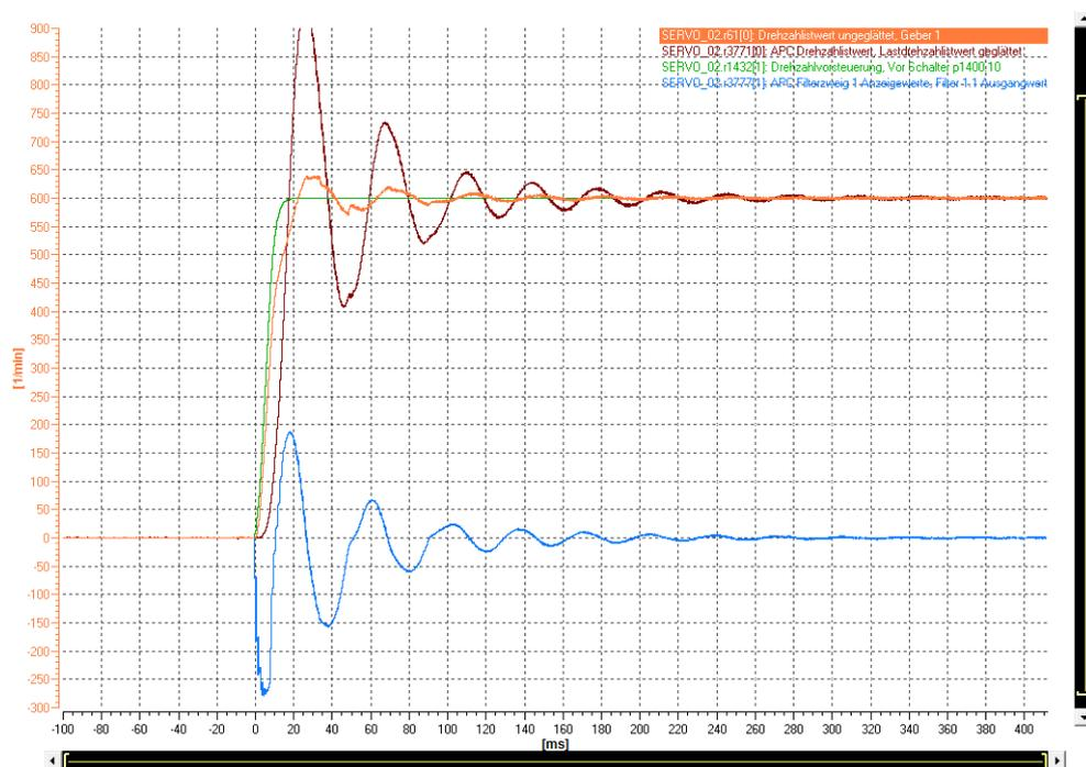
9.14 Расширенное управление положением Advanced Position Control (включая активное подавление вибрации Active Vibration Suppression)
