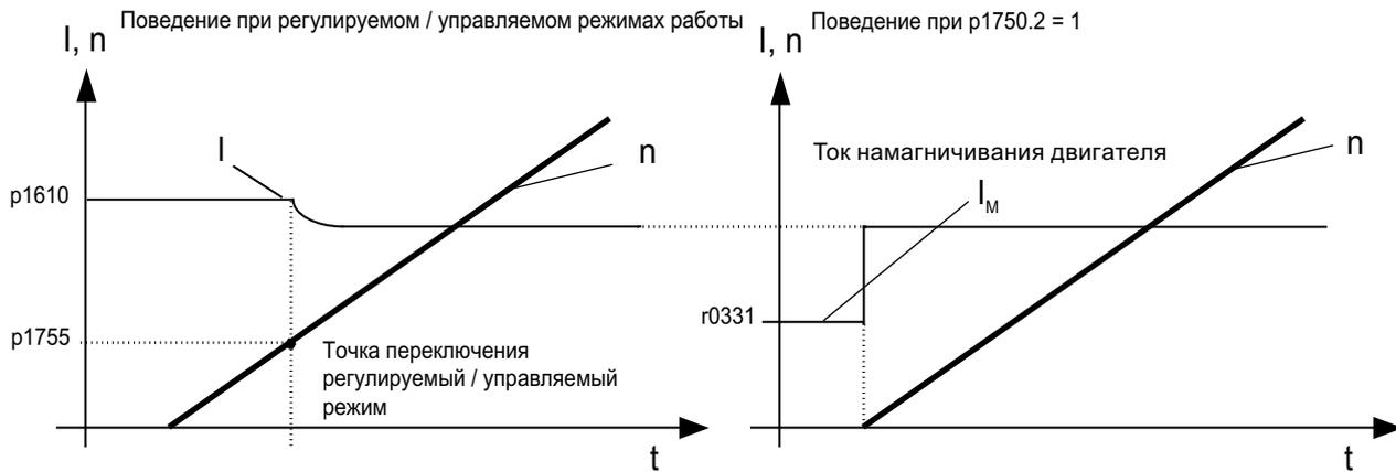
Рисунок 6-3 Векторное управление без датчика
