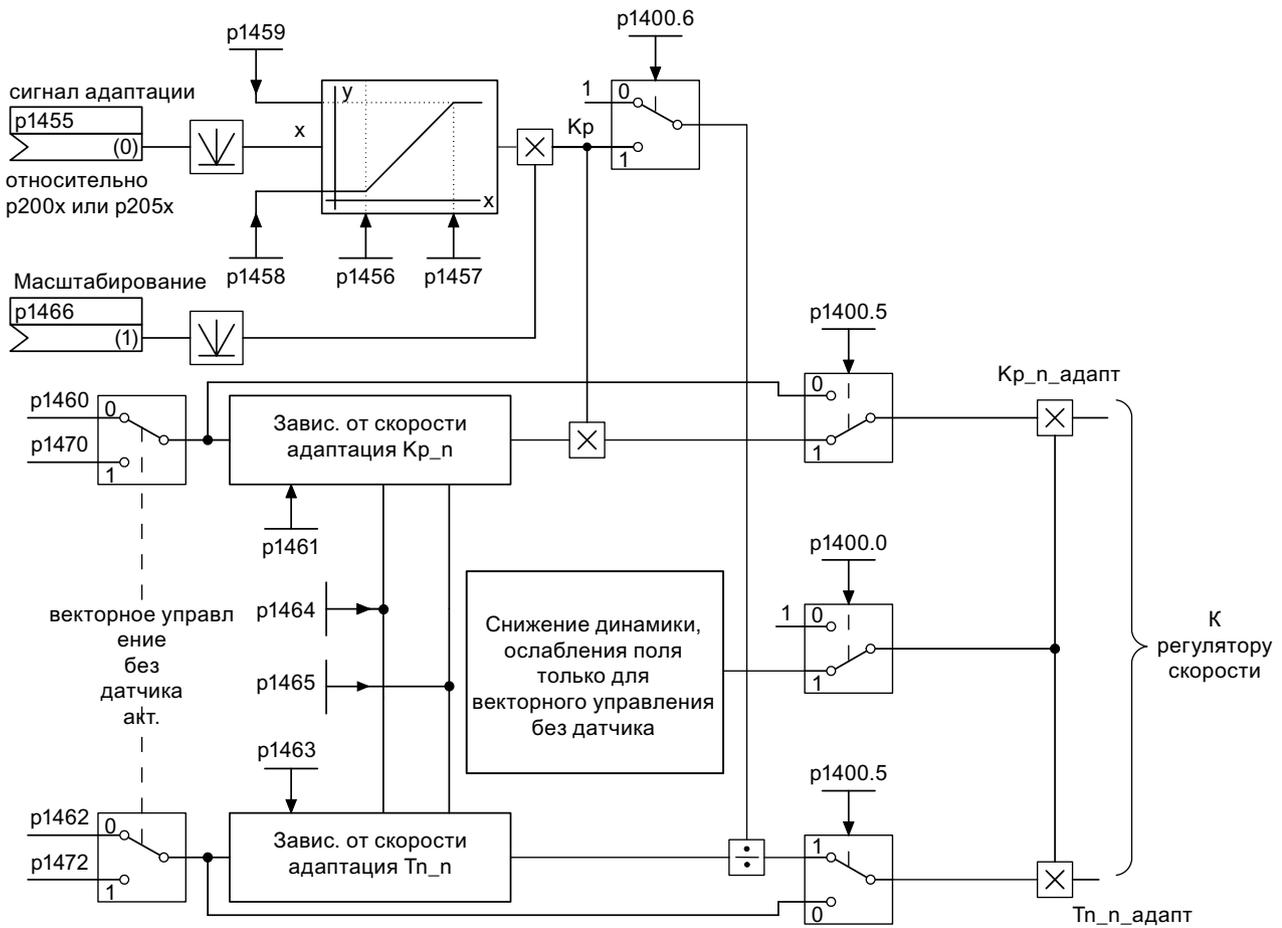
Рисунок 6-7 Характеристика сигнала: Согласование Kp\_n-/Tn\_n
