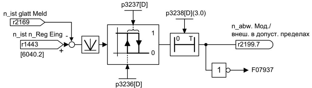
Рисунок 6-11 Контроль "Отклонение частоты вращения модель/внешнее устройство в допуске"
