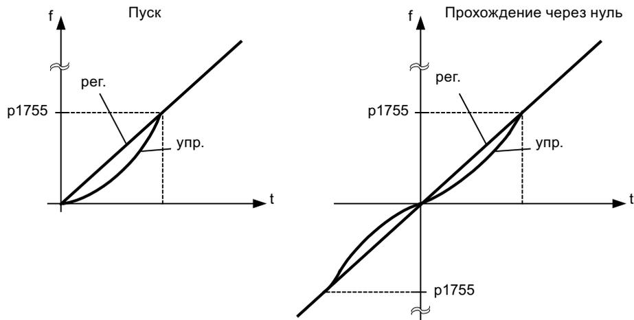
Рисунок 6-2 Переход через ноль и запуск в регулируемом или управляемом режиме
