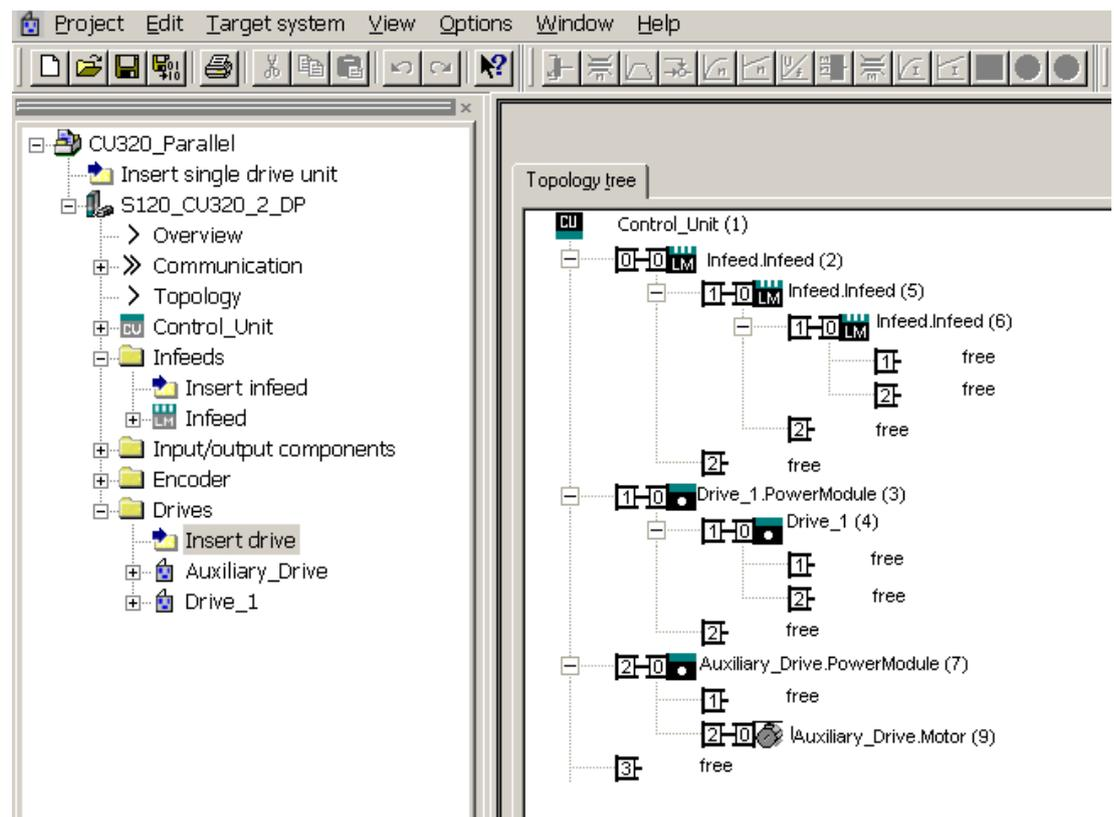
Рисунок 9-28 Топология с 3 модулями Basic Line Module, 2 модулями Motor Module и 1 вспомогательным приводом
