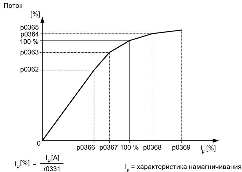
Рисунок 6-19 Характеристика намагничивания
