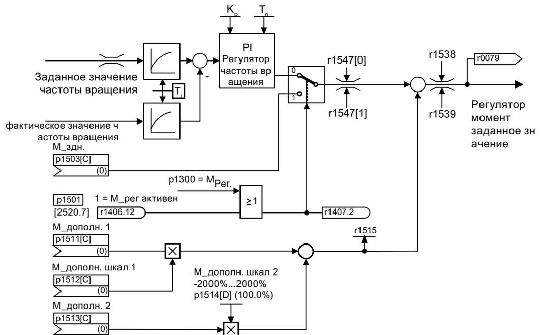
Рисунок 6-12 Характеристика сигнала: Управление по частоте вращения/моменту
