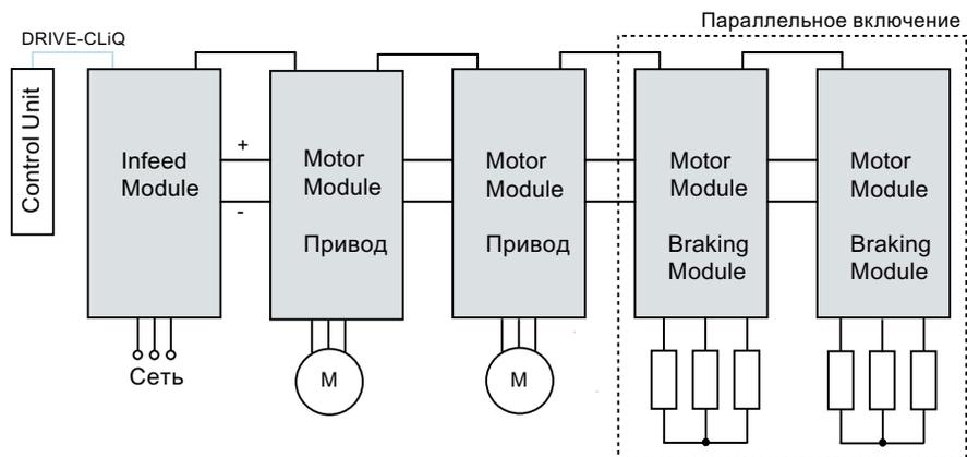
Рисунок 8-5 Параллельное включение модулей Motor Module в качестве модулей торможения
