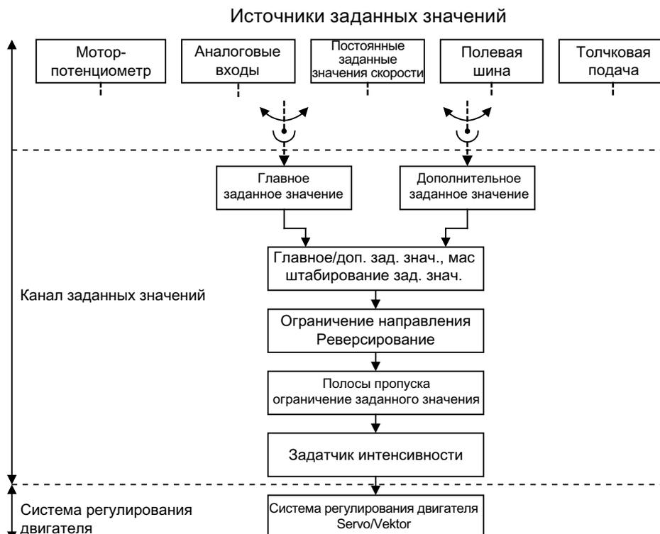
Рисунок 4-1 Расширенный канал уставок
