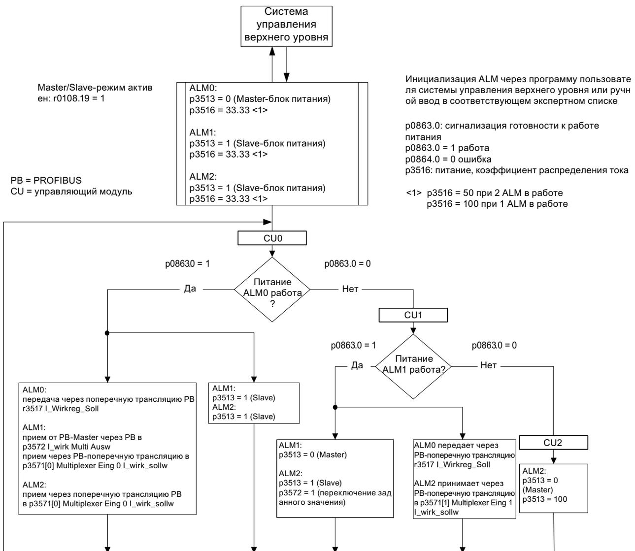
Рисунок 9-24 Структурная схема: 3 идентичных модуля Active Line Module одинаковой мощности, шина PROFIBUS в качестве варианта связи
