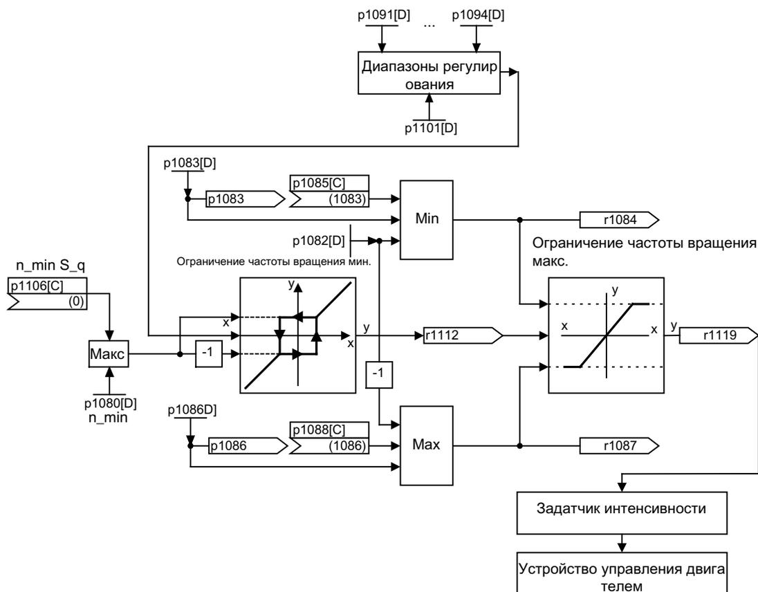
Рисунок 4-7 Полосы пропуски, ограничения уставок, мин. частота вращения
