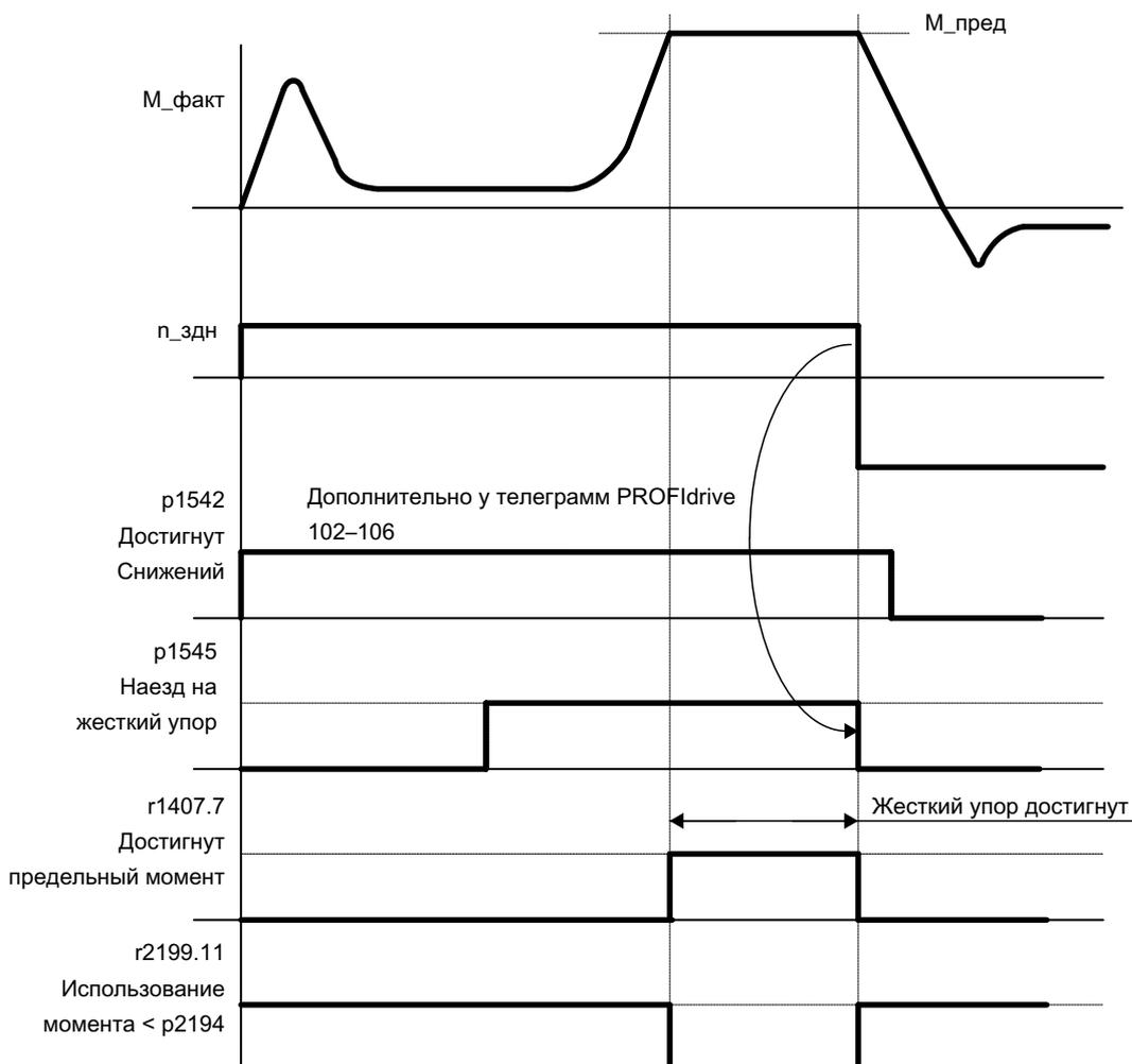
Рисунок 5-29 Характеристика сигнала при "Наезде на жесткий упор"
