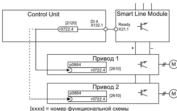
Рисунок 12-3 Иллюстративное соединение модуля питания Smart без DRIVE-CLiQ
