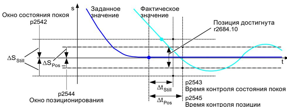
Рисунок 9-10 Контроль состояния покоя, окно позиционирования
