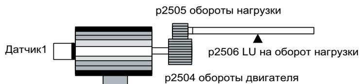
p2502 = 2, управление положением на внешнем датчике 2
