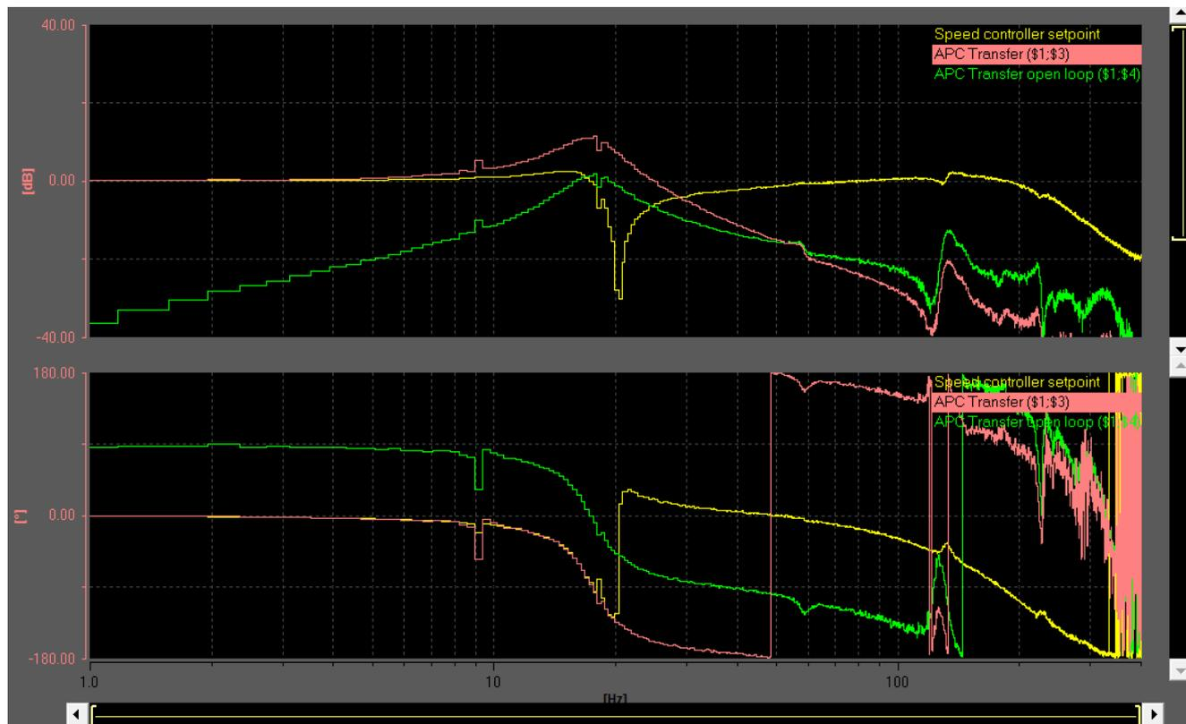
Желтый Регулятор частоты вращения, частотная характеристика относительно задающего воздействия
