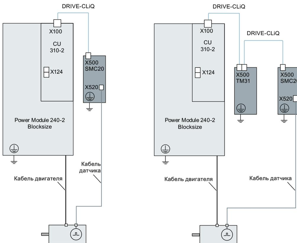
Рисунок А-4 Модули Power Module формата Blocksize
