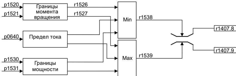
Рисунок 6-13 Характеристика сигнала: Ограничение крутящего момента
