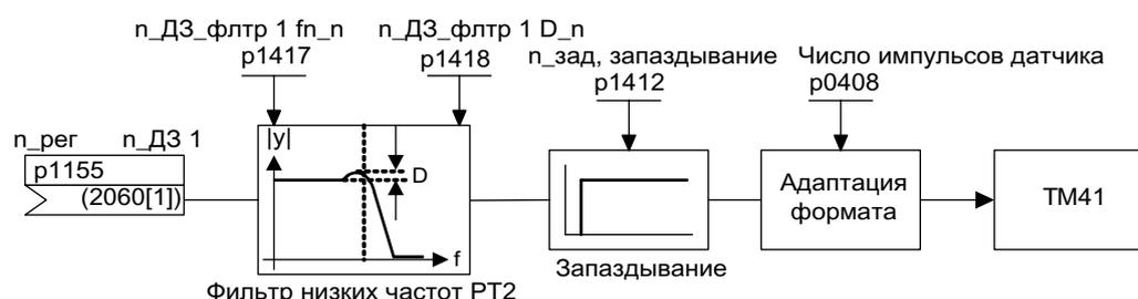
Рисунок 8-16 Функциональная схема эмуляции датчика
