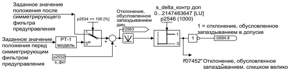
Рисунок 9-11 Контроль отклонения, обусловленного запаздыванием
