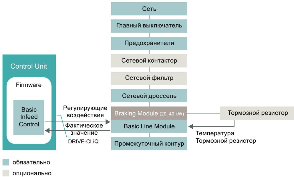
Рисунок 3-4 Схематическая структура системы Basic Infeed книжного формата
