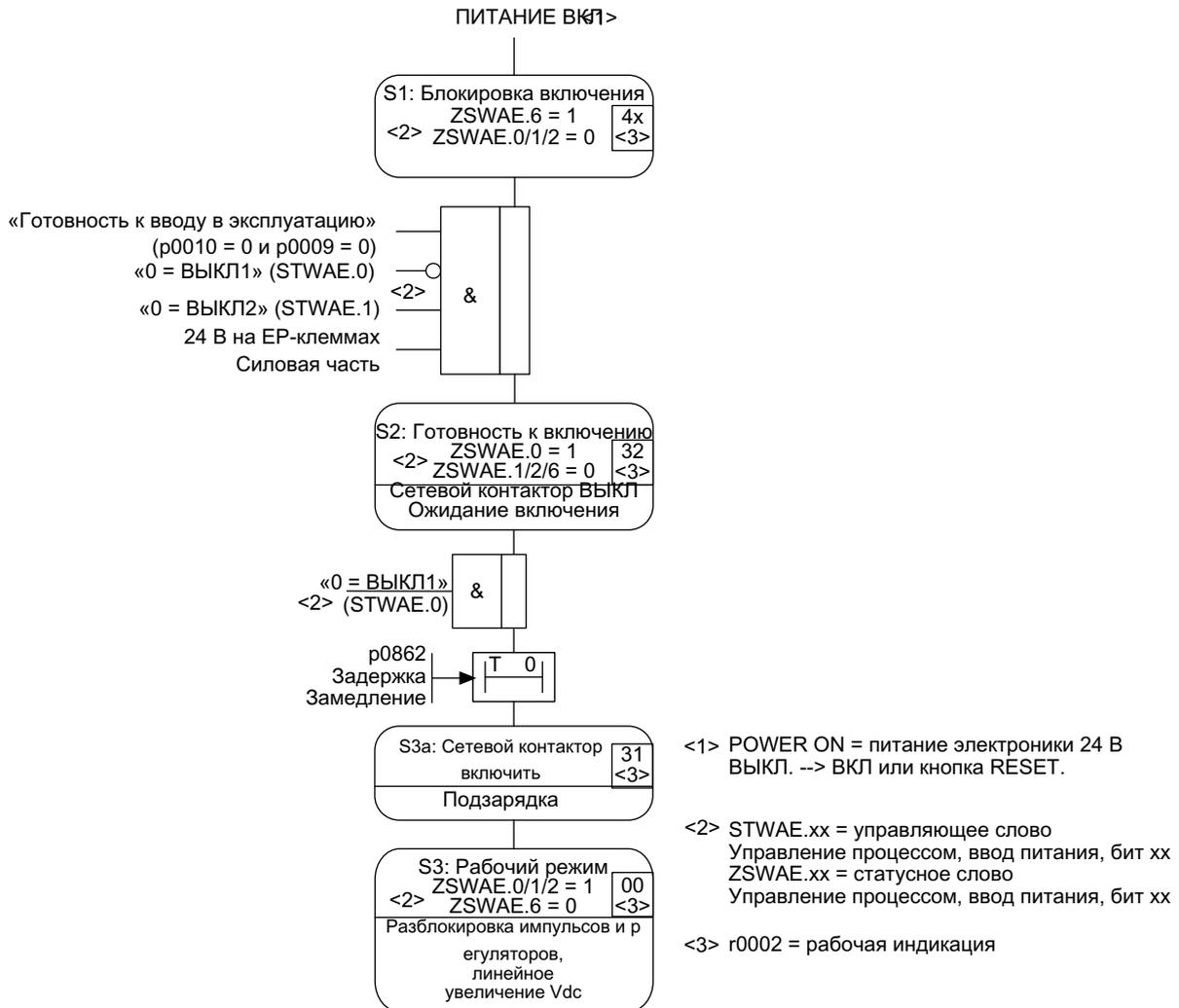
Рисунок 3-6 Процесс запуска системы Basic Infeed
