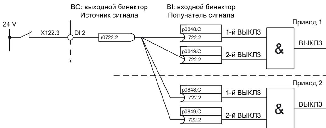
Рисунок 14-11 Соединить ВЫКЛЗ с несколькими приводами (пример)
