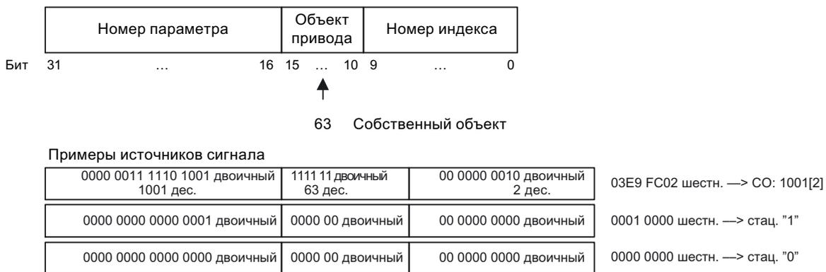
Рисунок 14-9 Внутренняя кодировка выходных параметров бинекторов/коннекторов
