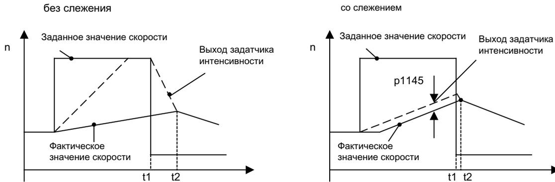
Рисунок 4-10 Слежение за задатчиком интенсивности
