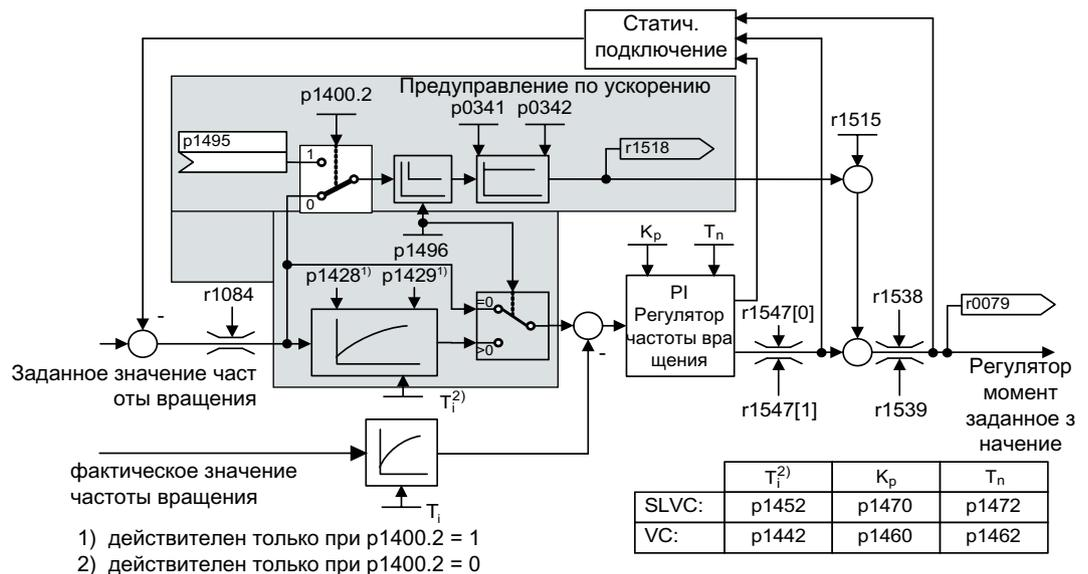
Рисунок 6-9 Регулятор частоты вращения с предупреждением
