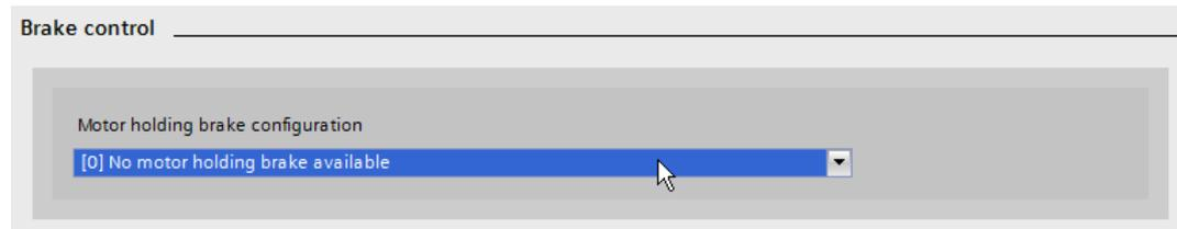
Рисунок 11-10 Пример: Управление торможением без стояночного тормоза двигателя
