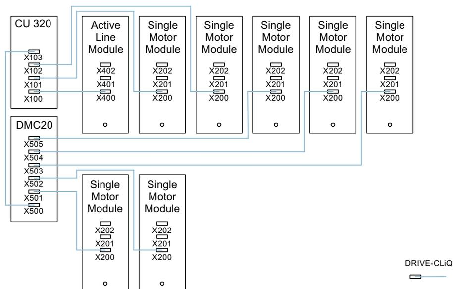
Рисунок 12-9 Иллюстративная топология Hot-Plugging для векторного управления U/f
