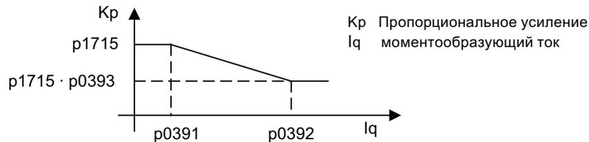
Рисунок 6-16 Адаптация регулятора тока для  $p0393 < 1$ , при этом  $p0391 < p0392$
