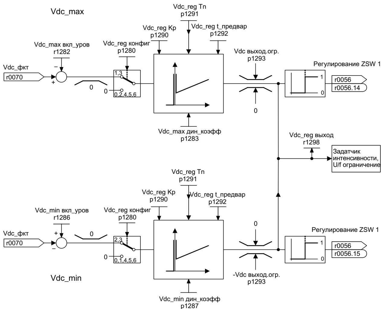
Рисунок 7-3 V<sub>dc</sub>-регулирование U/f
