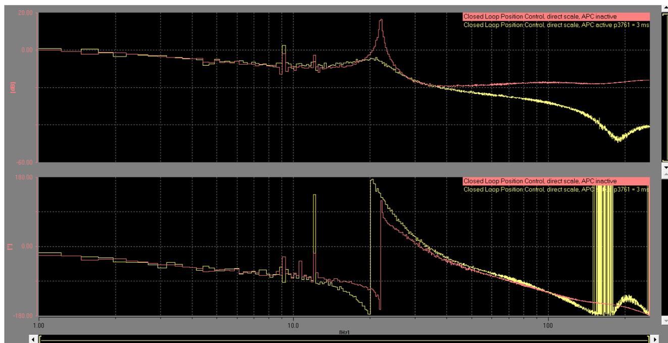
Красный: APC неактивный: Регулирование на пределе стабильности. Коэффициент усиления регулирования положения очень большой.
