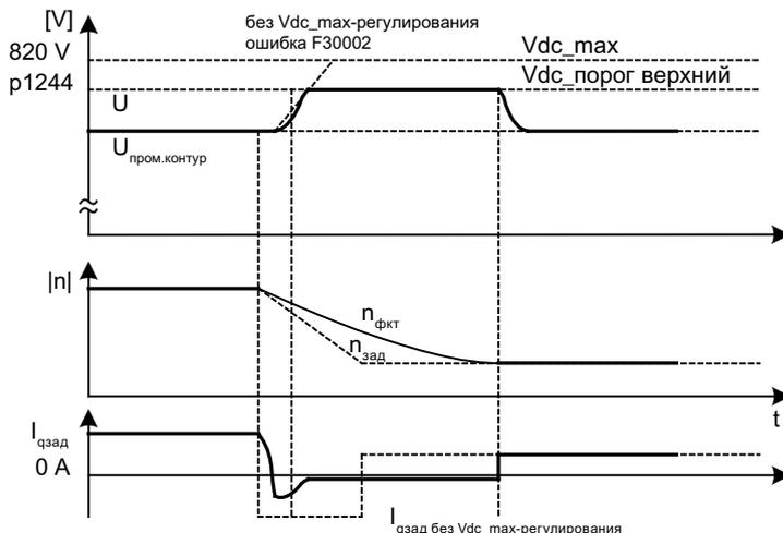
Рисунок 5-27 Включение/выключение  $V_{dc\_max}$ -регулирования
