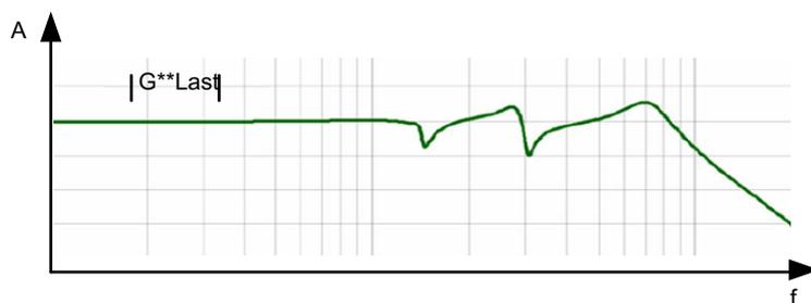
Рисунок 9-51 Частотная характеристика нагрузки с APC: 2 обратных связи, замкнутых
