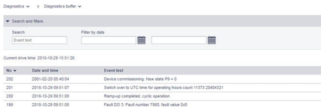
Рисунок 13-23 Пример: Фильтрация буфера диагностики
