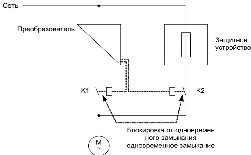
Рисунок 6-28 Пример включения байпаса без синхронизации
