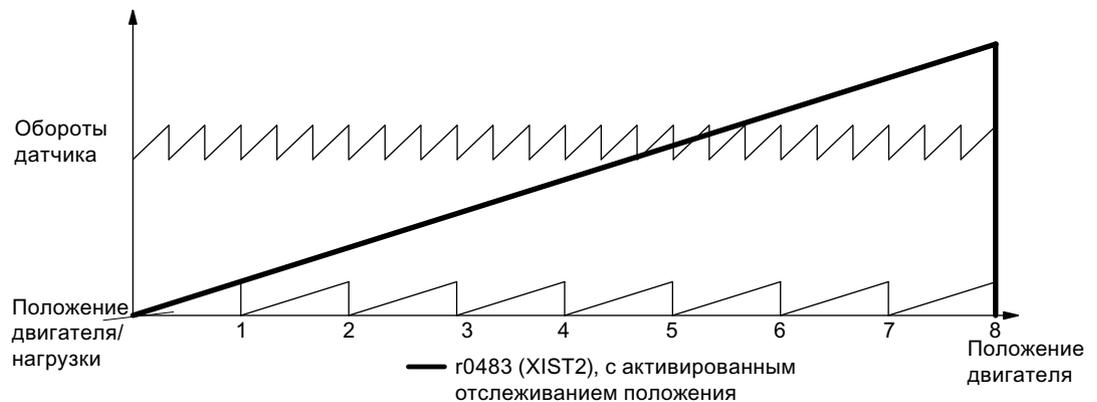
Рисунок 8-14 Нечетный редуктор с отслеживанием положения (r0412 = 8)
