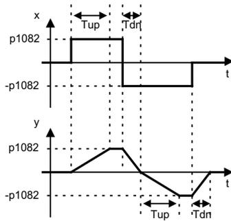
Рисунок 4-8 Разгон и торможение при простом задатчике интенсивности
