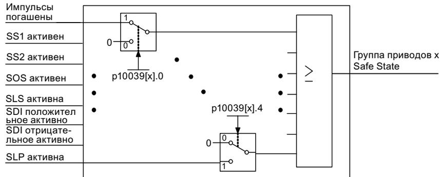
Рисунок 11-7 Выбор Safe State (пример Extended Functions)
