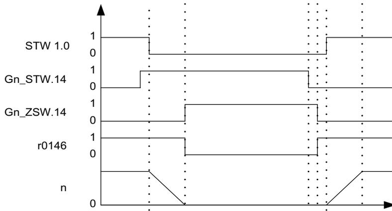
Рисунок 8-10 Диаграмма процесса перевода датчика в режим ожидания
