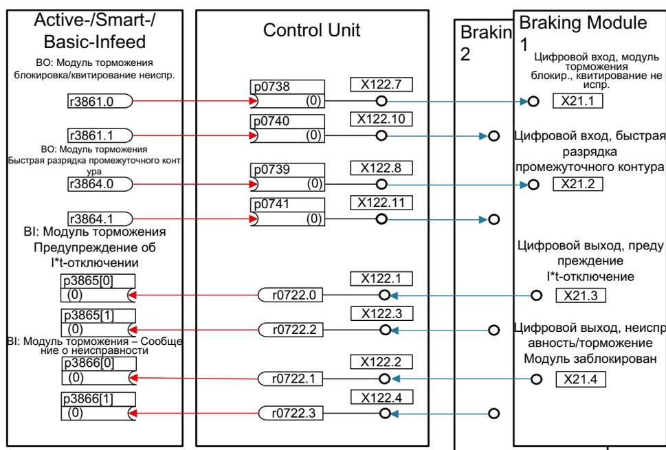
Рисунок 9-5 Пример управления двумя модулями торможения книжного формата
