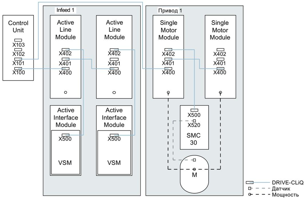
Рисунок А-3 Параллельно подключаемые силовые части формата "шасси"
