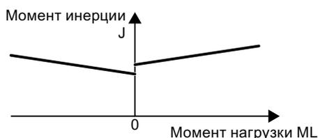
Рисунок 9-35 Связь между моментом нагрузки  $M_L$  и моментом вращения
