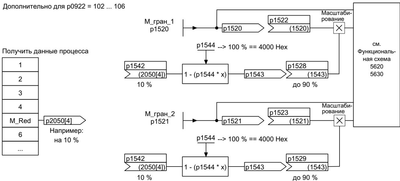
Рисунок 5-28 Сигналы при "Наезде на жесткий упор"
