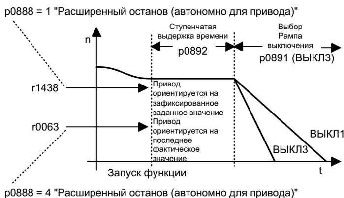
Рисунок 9-29 Рампа ВЫКЛ со ступенчатой выдержкой времени
