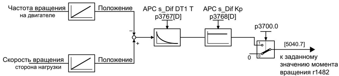
Рисунок 9-42 APC с обратной связью по разности положений
