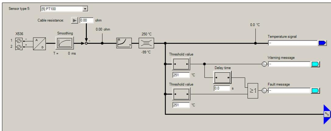
Рисунок 10-1 Время сглаживания датчика/канала температуры
