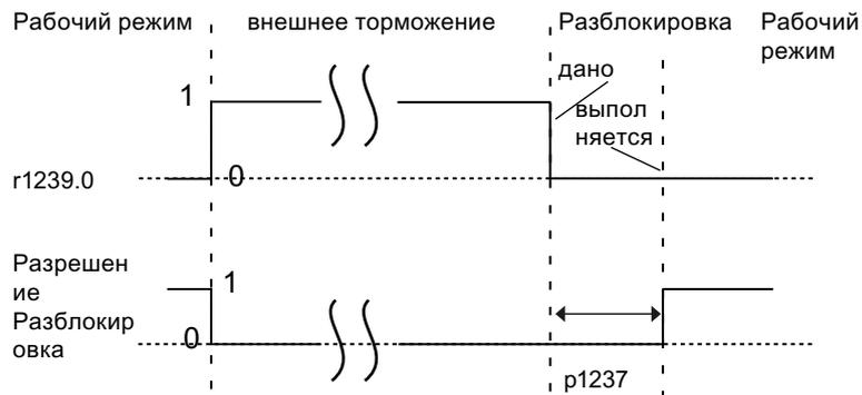
Рисунок 8-3 Характеристика сигнала без квити́рования контакторов при разрешении импульсов
