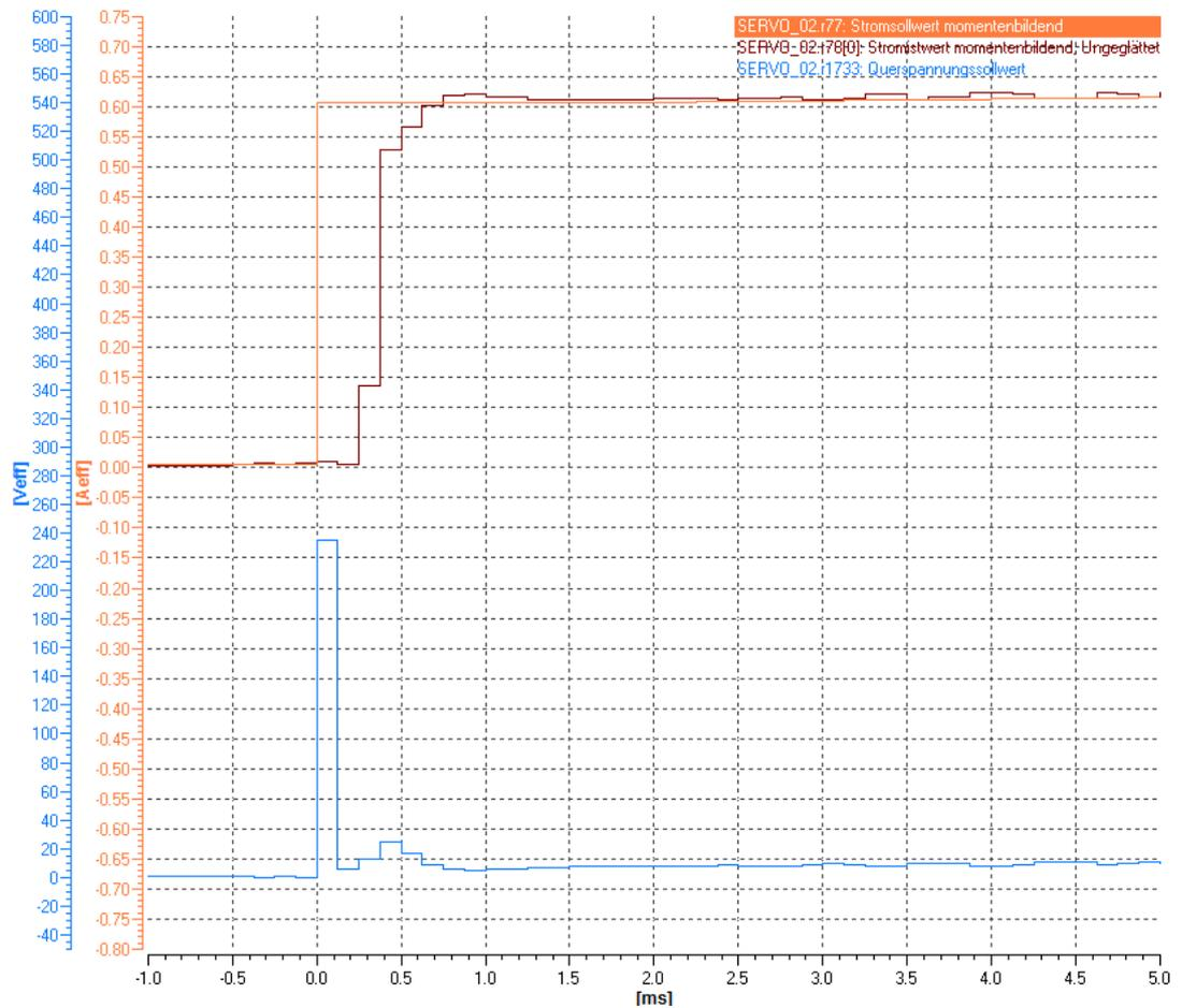
Рисунок 5-36 Пример: Предусиление регулирования напряжения p1703 слишком мало
