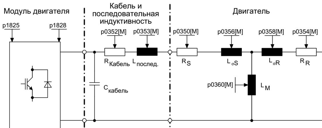
Рисунок 6-18 Эквивалентная схема – асинхронный двигатель и кабель
