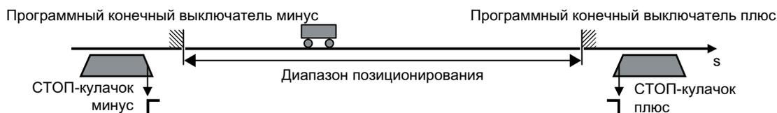
Рисунок 9-15 Программные и аппаратные конечные выключатели в качестве ограничений
