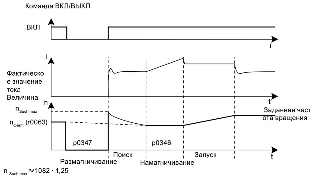
Рисунок 6-23 Прикладной пример: Асинхронный двигатель без датчика
