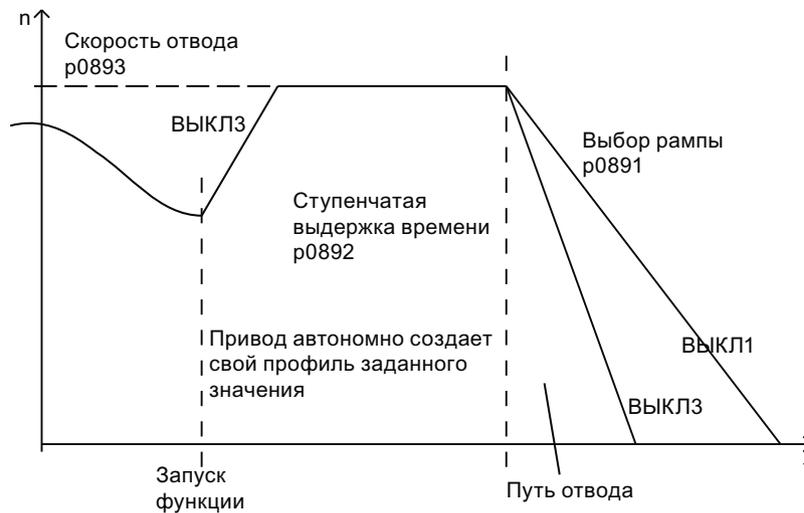
Рисунок 9-30 Рампа ВЫКЛ с "Расширенным отводом"
