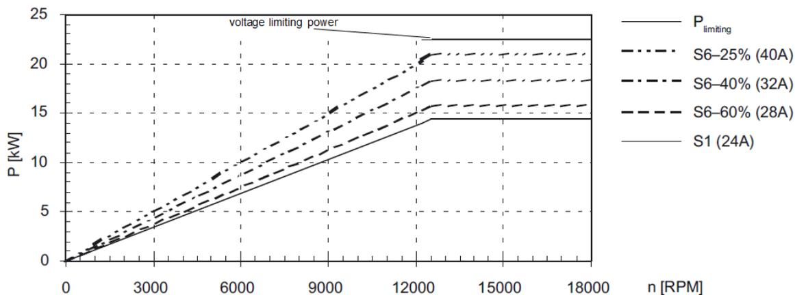
Рисунок 5-13 Синхронный двигатель: Характеристика мощность-крутящий момент
