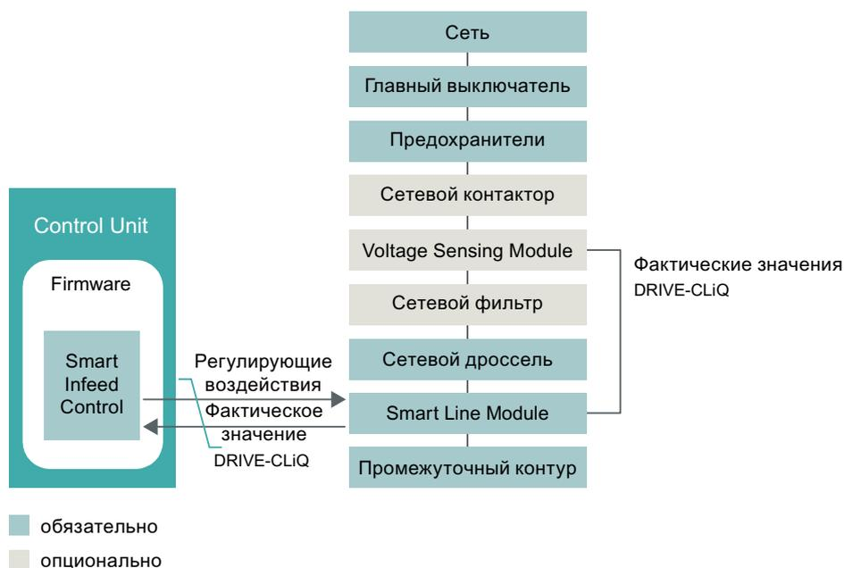
Рисунок 3-7 Схематическая структура системы Smart Infeed книжного формата
