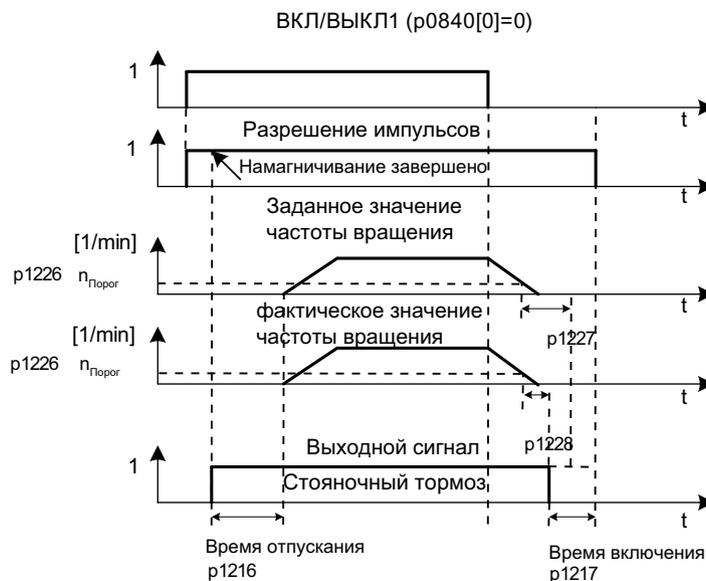
Рисунок 8-6 Технологическая схема процесса: Простое управление торможением
