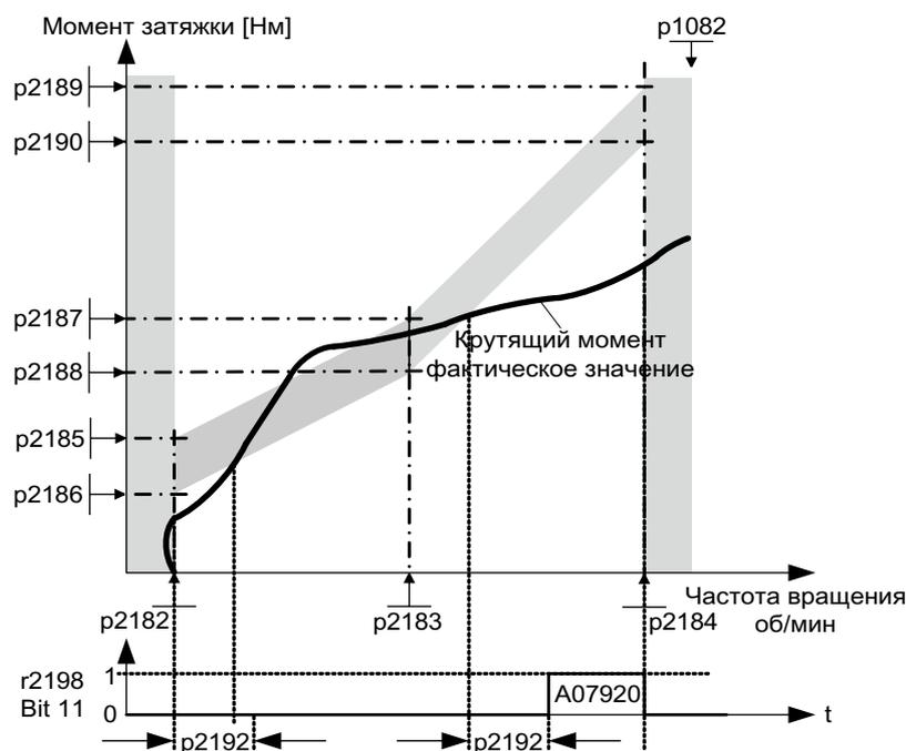
Рисунок 9-3 Контроль нагрузки
