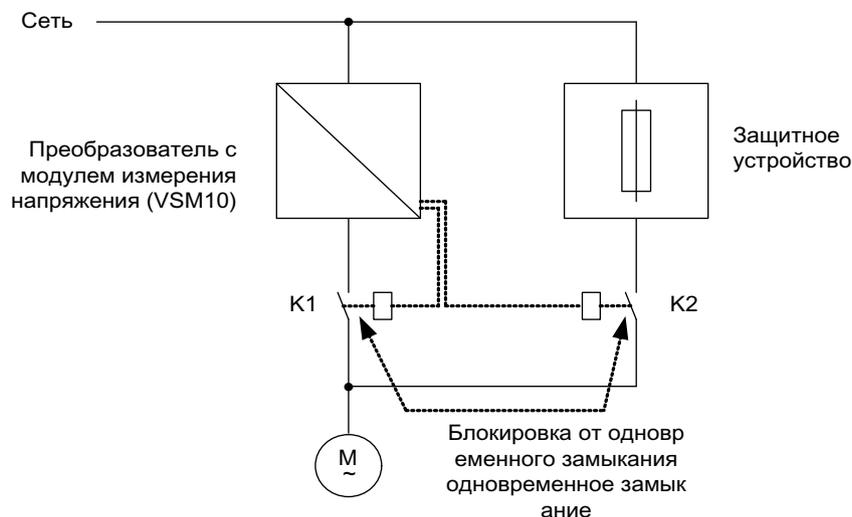
Рисунок 6-27 Пример схемы: Байпас с синхронизацией без перекрытия
