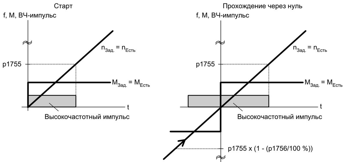
Рисунок 6-5 Прохождение через ноль в регулируемом режиме до нулевой частоты вращения
