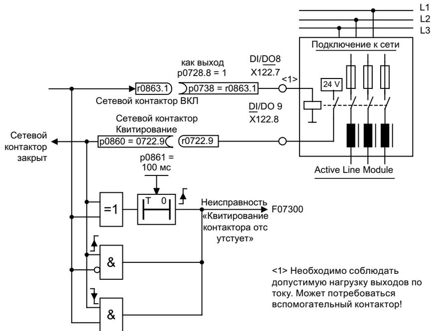
Рисунок 3-10 Управление сетевым контактором
