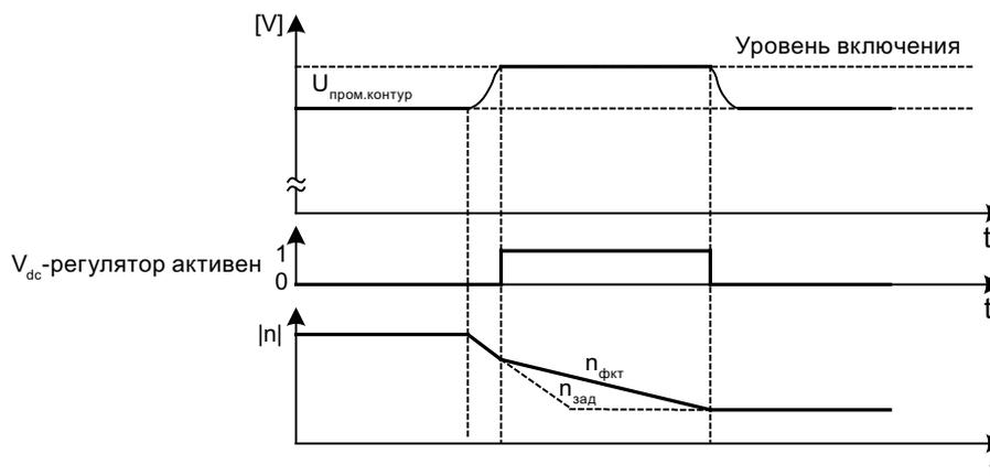
Рисунок 7-5 Включение/выключение V<sub>dc\_max</sub>-регулирования
