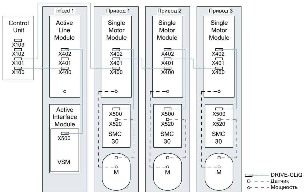
Рисунок А-1 Модули Motor Module формата "шасси" с одинаковой частотой импульсов
