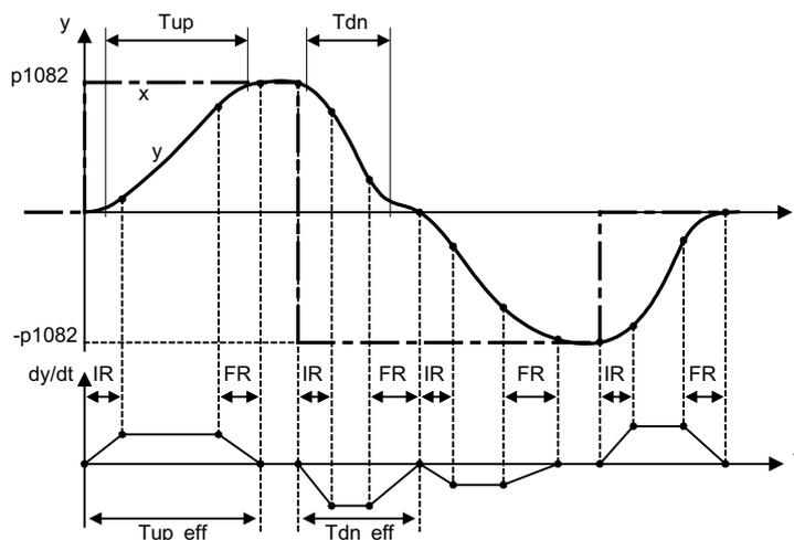
Рисунок 4-9 Расширенный задатчик интенсивности
