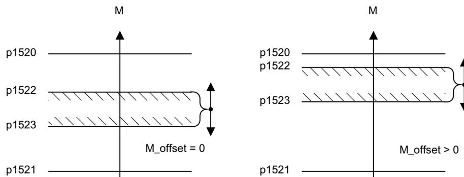
Рисунок 5-8 Пример: Пределы крутящего момента со смещением/без него
