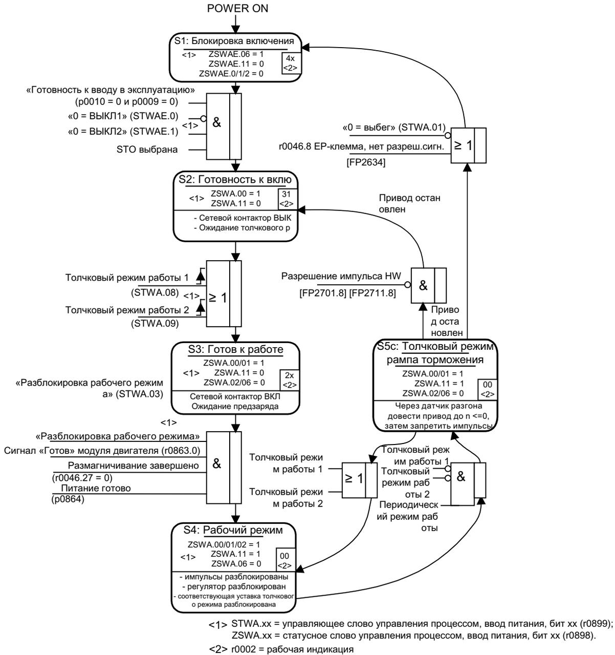
Рисунок 4-5 Процесс толковой подачи
