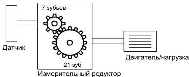
Рисунок 8-12 Измерительный редуктор
