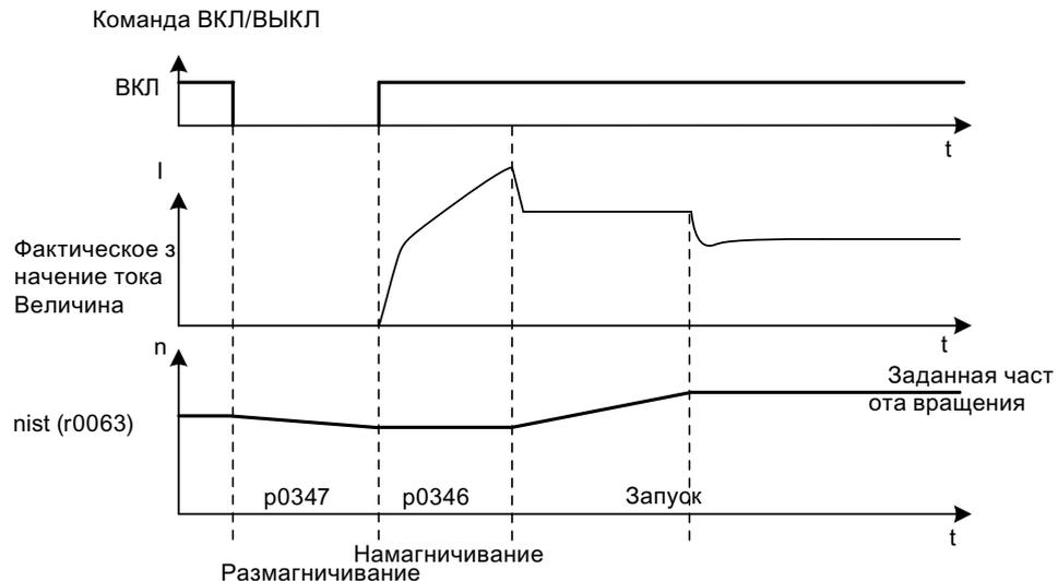
Рисунок 6-24 Прикладной пример: Асинхронный двигатель с датчиком
