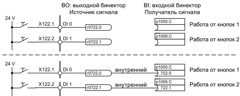
Рисунок 14-10 Соединение цифровых сигналов (пример)
