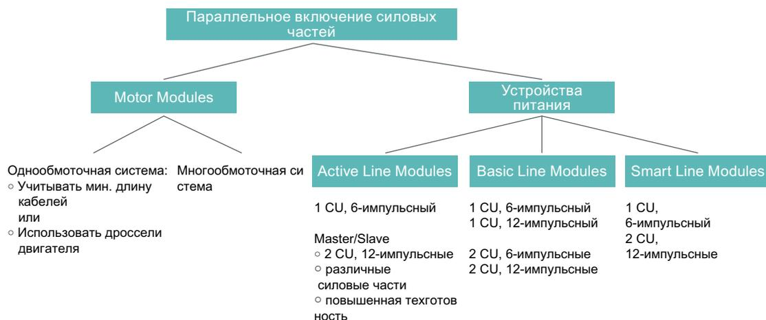
Рисунок 9-26 Обзор: Параллельное включение силовых частей
