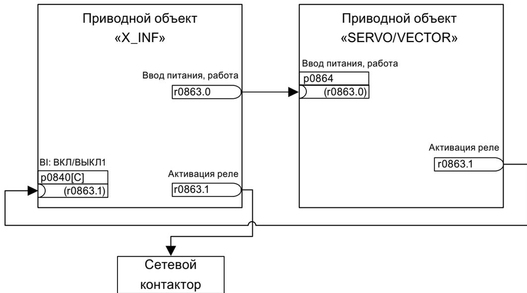
Рисунок 12-1 Схема BICO: Включение устройства питания через привод
