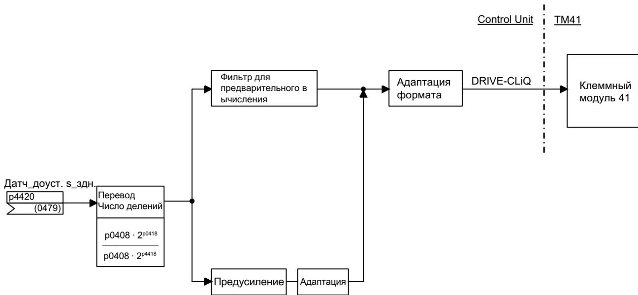
Рисунок 8-17 Эмуляция инкрементального датчика
