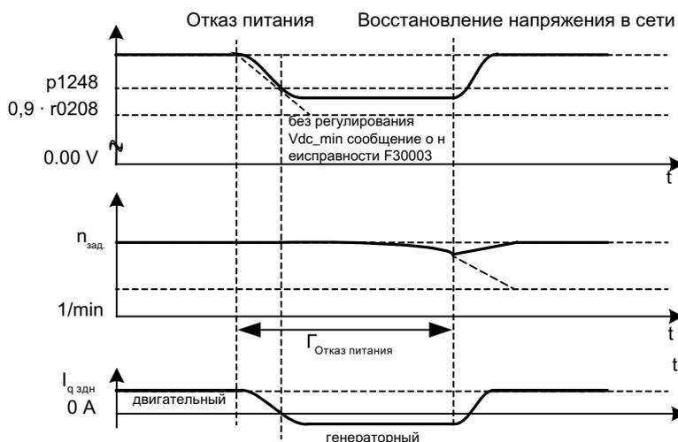
Рисунок 5-26 Включение/выключение V<sub>dc\_min</sub>-регулирования (кинетическая буферизация)
