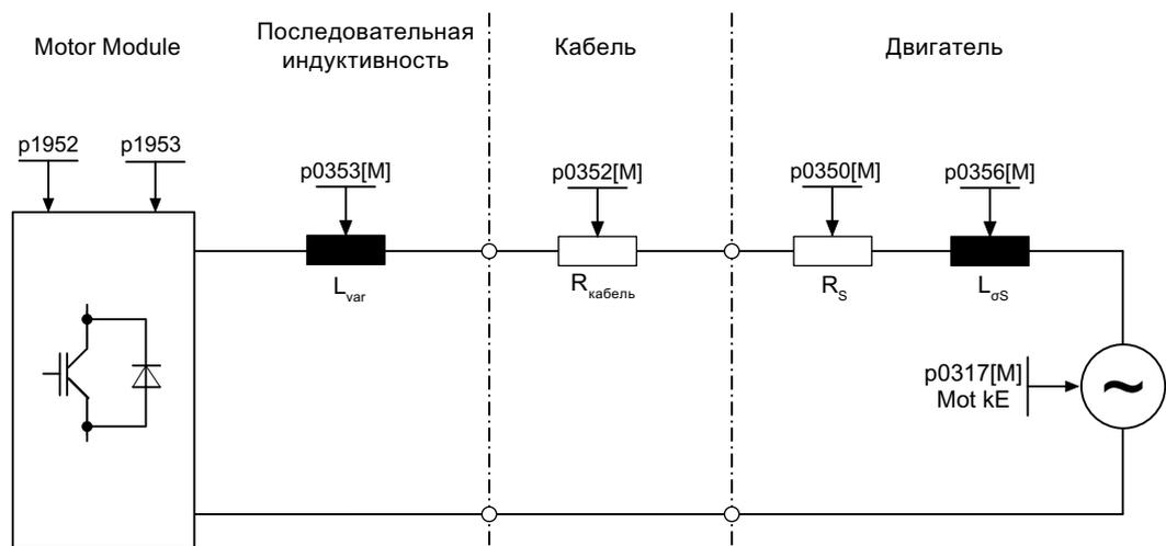
Рисунок 5-19 Эквивалентная схема - Синхронный двигатель и кабель
