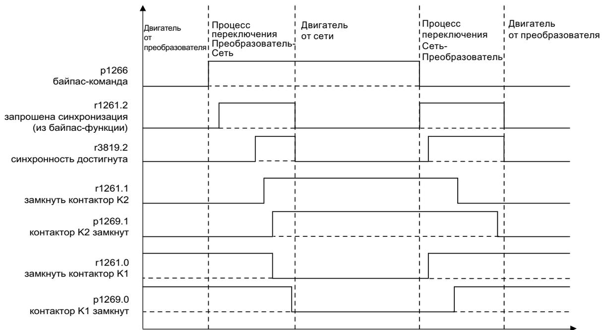
Рисунок 6-26 Характеристика сигнала: Байпас с синхронизацией с перекрытием
