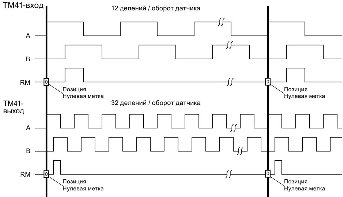
Рисунок 8-18 Пересчет числа делений датчика
