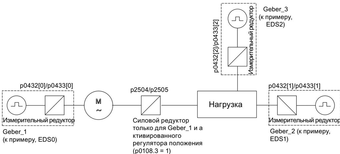
Рисунок 8-11 Обзор: Редукторы и датчики
