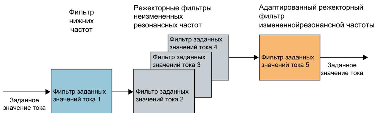
Рисунок 5-11 Пример: Фильтр уставок тока 5 – последний использованный фильтр в каскаде
